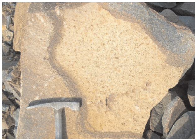
9. fénykép. Recsk, Csákánykő-bánya. Egy korábbi limonitosodott (okker, vörös szegéllyel) és egy friss (szürke, vörös szegéllyel) törési felület az andeziten
