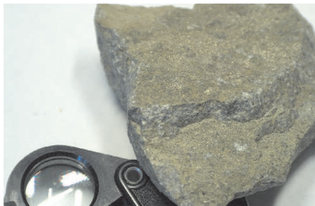
23. fénykép. Tállya, kopasz-hegyi bánya, alsó szint. Szürke andezit elválási lapja mentén markazit és pirit látható
