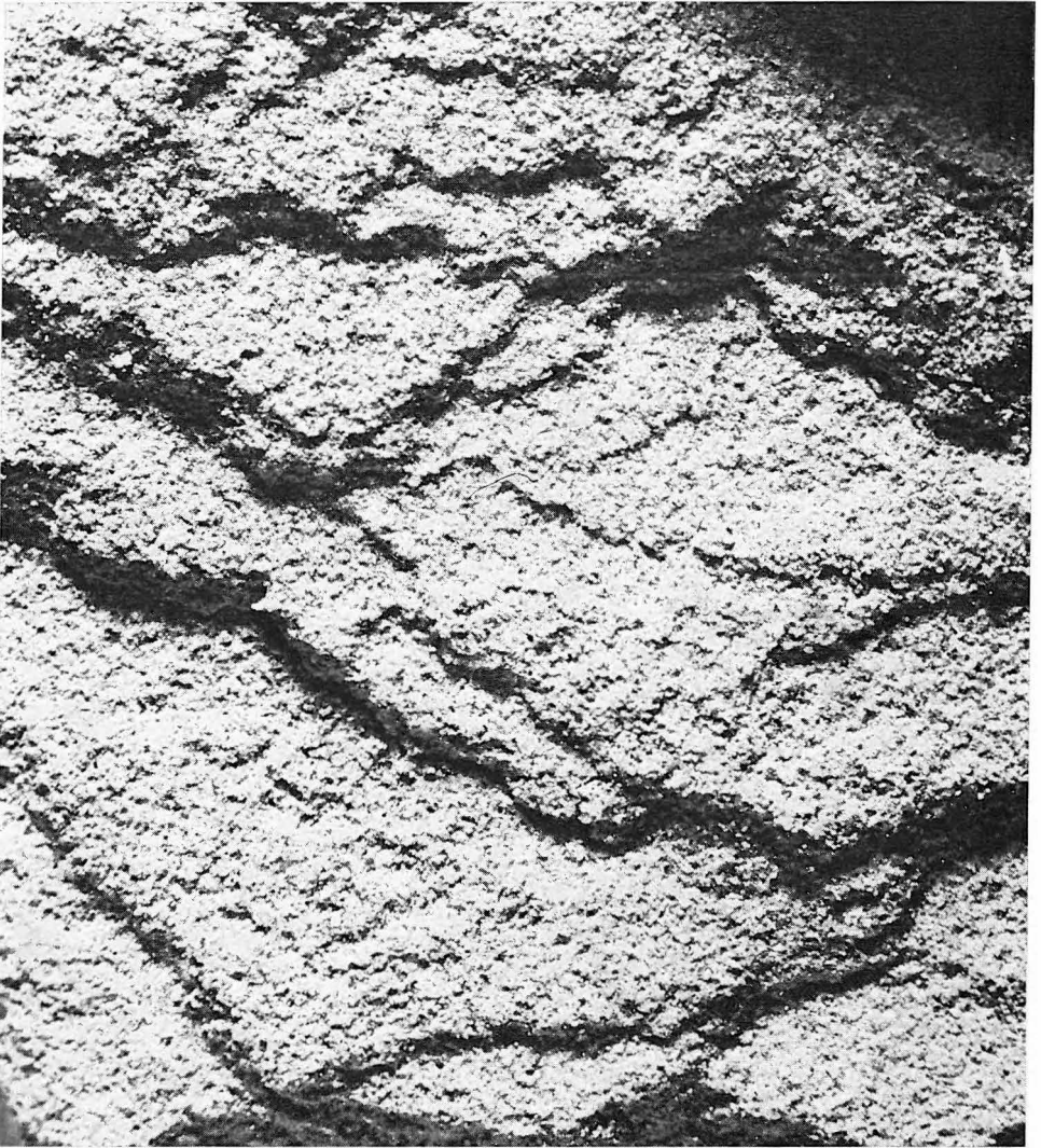
6. ábra. Rétegzett finomszemű kőzetlisztes homok (felsőpliocén, 417,30–418,35 m). 5× Fotó: KUCHEN Z.
