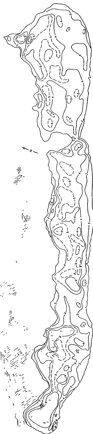
1 2 3 1. abra A Balaton kolloid-iszap vastagsági térkepe (szerkesztette CORRADA R. — RAMOS V. — OVIEDO A. 1988) 1 > 1,0 m, 2 0,5–1,5 m, 3 < 0,5 m Fig. 1 Colloid-mud thickness map of Lake Balaton (compiled by R. CORRADA—V. RAMOS—A. OVIEDO 1988) 1 > 1,0 m, 2 0,5–1,5 m, 3 < 0,5 m
