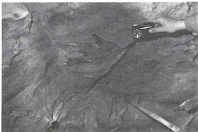
3. ábra. Vízszintes elmozdulást mutató vetővonal a budai márgában. Vérmező–Moszkva téri szakasz, II. keresztvágat, közelről (Foto: PELLÉRDYNÉ)
