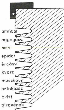
4. ábra. Ásványok nyilván tartására szolgáló lyukkártyarendszer visszakereső sablonja
