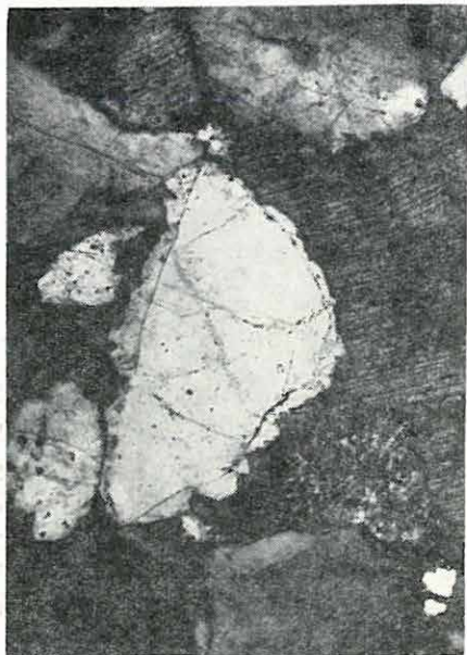
1. ábra. Kvarc továbbnövekedése. — András-akna VII. szint, 1. É-i fekéskeresztvágat. +Nic; 47× Foto: (NOSKENÉ)
