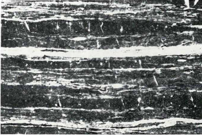
10. ábra. Kéregeredetű periblinit. A vitritlencsékben zsugorodási repedések. — Csolnok VII. akna, 6. minta. (47 ×)
