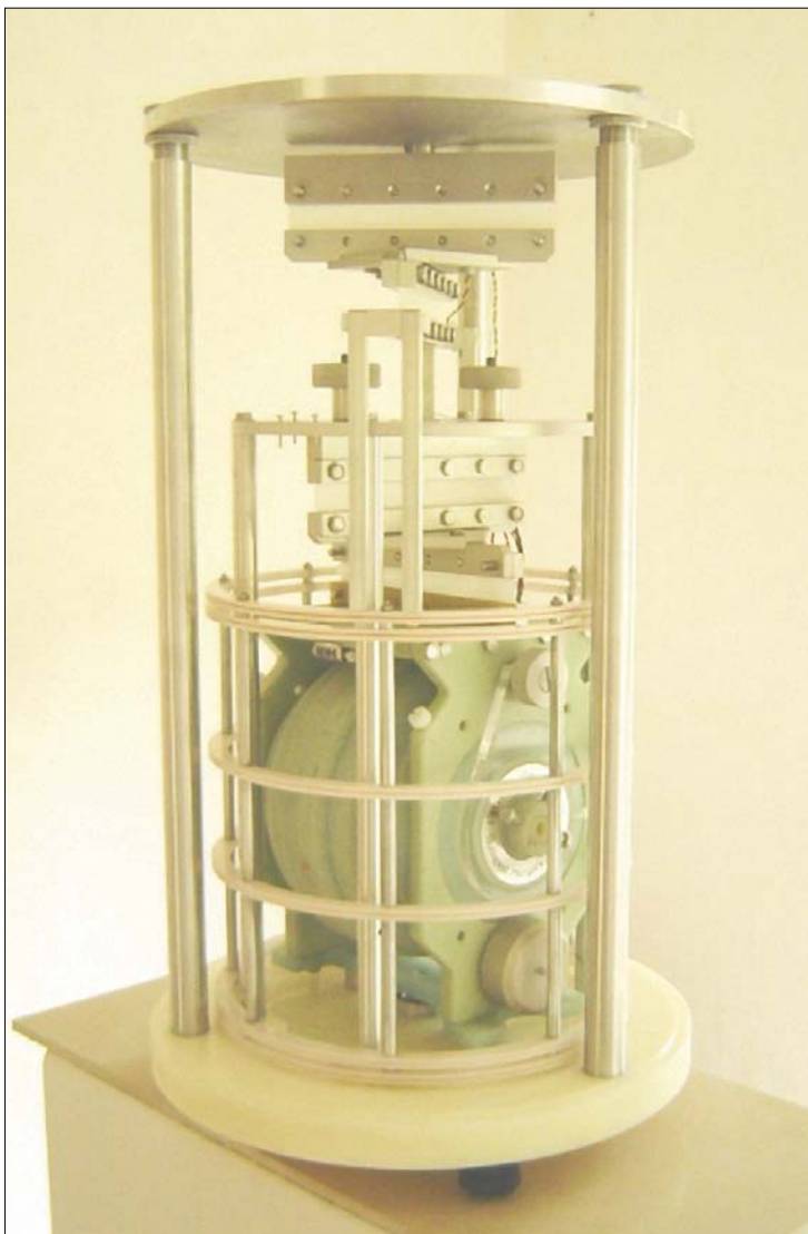
3. ábra A forgatható, vertikális tengelyű tekercessel kiegészített dIdD magnetométer Figure 3 dIdD magnetometer equipped by the third turnable coil. The magnetic axes of the third coil is vertical
