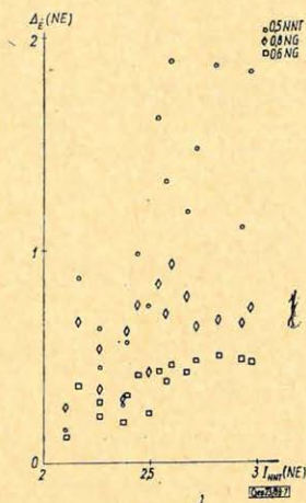
7. ábra. Algyői kutakban használt szondák gázérzékenységeinek vizsgálata tiszta és szennyezett homokkőtárolókban
