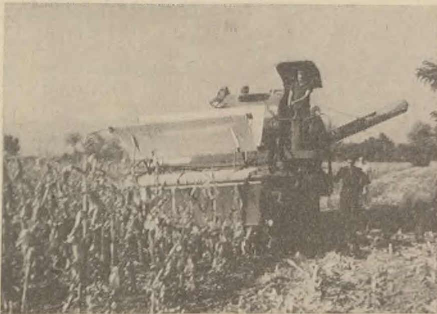
1. ábra A ZsKN—2,6 jelű adapterrel felszerelt SzK—3-as gabona kombájn munkában
