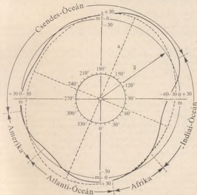
29. ábra. Az SE I geoid egyenlítői metszete, ahol a = 6378173,6 m a metszethez legjobban simuló ellipszis félnagyengelye, és \bar{a} = 6378137,8 m)
