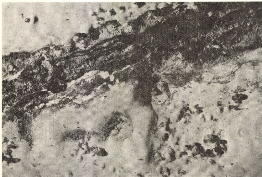
1. ábra. Védőlakkfestés minőségi próbája. A fémlapot bekarcolva tíz percre sós vízbe helyezték, majd a levegő hatásának tették ki.
