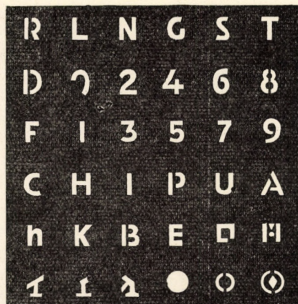
2. ábra. Charactron-cső maszkja
