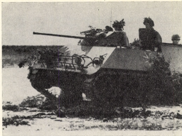
2. kép: A Bundeswehrben a 20 mm-es lövegtoronnyal felszerelt HS 30 lövészpáncélost rendszeresítették.
