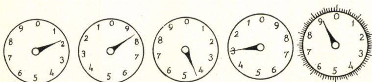
3. ábra: Áramsámláló számlapja analóg és digitális kijelzéssel
