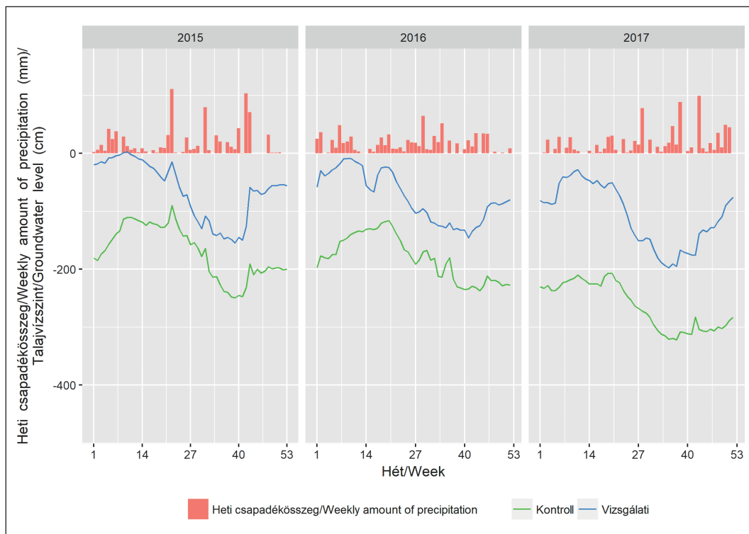
4. ábra: Heti csapadékmennyiségek és átlagos talajvízszintek a kontroll- és a vizsgálati területeken Figure 4: Precipitation and mean groundwater levels by week at the control- and sample sites
