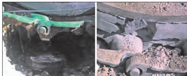
72. ábra. GYATA-64-es elhelyezése a futógörgő alá, és a robbanás hatása
