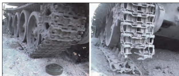
78. ábra UKA-63-as akna elhelyezése a harckocsi bal oldali láncmeghajtó kereke alá, és annak robbanást követő sérülései
