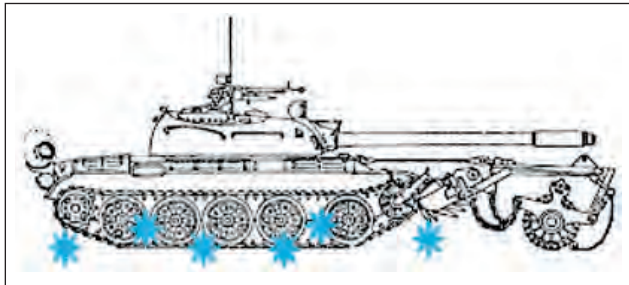
80. ábra. A célharckocsin a TM-62P3 típusú kumulatív harckocsi elleni akna alkalmazásakor okozott sérülések
