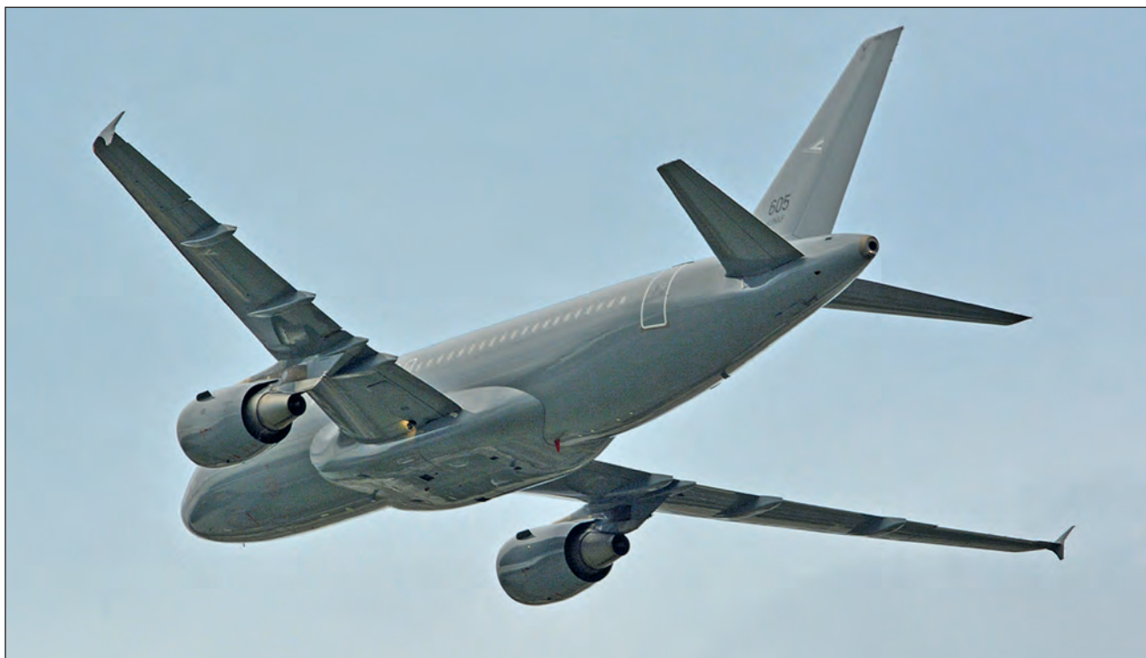
5. ábra. A 605-ös lajstromszámú Airbus A319-es csapatszallító repülőgép a levegőben, hátulnézetben. A szárnyak végein jól láthatók az áramlásjavító szárnyvégi zárólapok, amelyek üzemanyagfogyasztás-csökkenést eredményeznek
