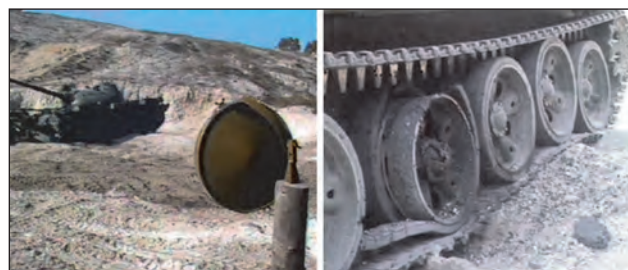
86. ábra. A MON-200-as oldal elleni akna elhelyezése, valamint hatása a harckocsi futóművére
