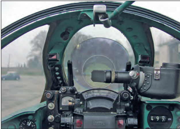
5. ábra. Célzóberendezés a páncélüveg mögött
