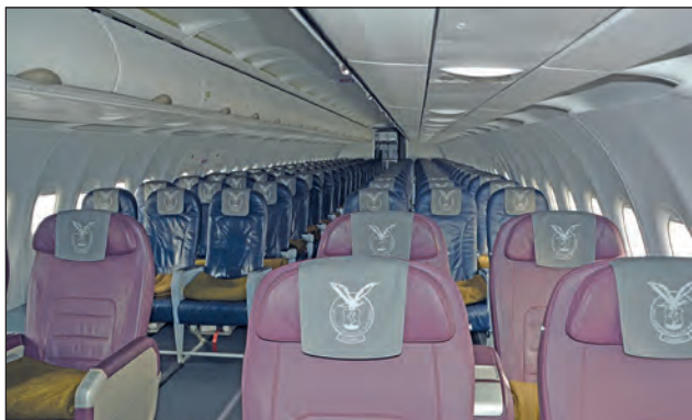
4. ábra. Az új Airbus repülőgépek utasszállító (csapatszallító) konfigurációban álltak hadrendbe, az utastér első három sorában bőrülésekkel (3x2), mögöttük sima bőr/szövetborítású ülésekkel (3x3)
