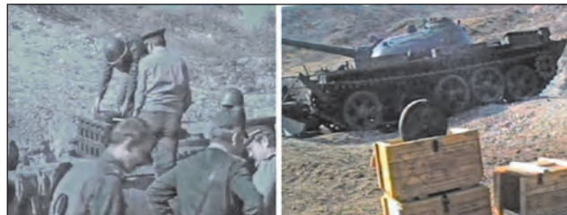
73. ábra. UKA-63-as akna elhelyezése a torony tetőpáncélján, illetve beállítása oldal elleni aknaként
