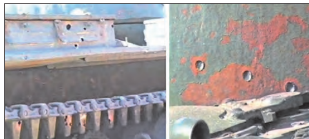
87. ábra. A MON-200-as oldal elleni akna hatása a harckocsi oldalára
