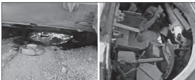
85. ábra. TM-62P3-as aknák elhelyezése a haspáncél alá, és azok robbanásainak hatása a küzdőterében elhelyezett felszerelésekre
