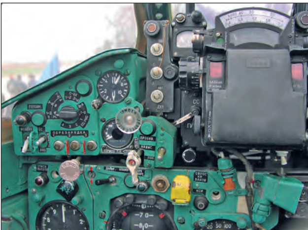
4a. ábra. MiG-21-es pilótakabin műszerfal (bal oldal)
