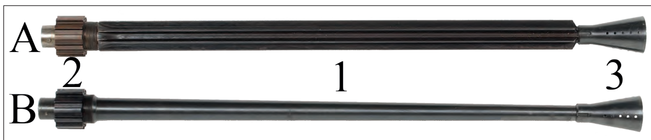
19. ábra. „A” bordázott, „B” sima falú, 1. cső, 2. csőanya, 3. lángrejtő. A cső biztosítja a lövedék forgó mozgását, kezdősebességét és induló irányát.
