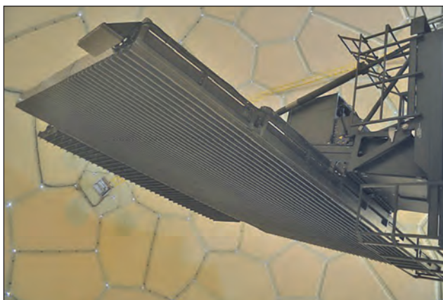
5. ábra. A beépített RAT-31DL radar a radomban 1.
