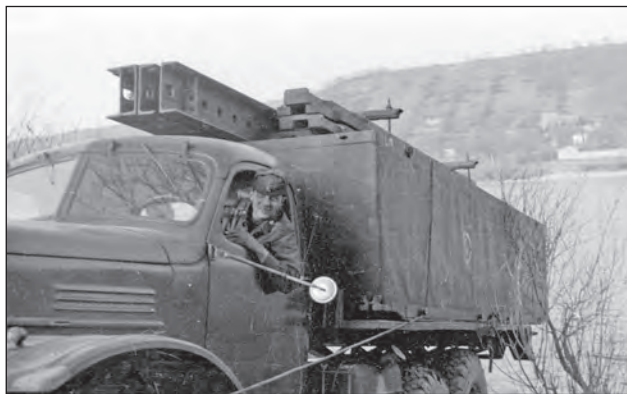
3. ábra. Pontonnal málházott ZIL-157-es. Jól látszik a felhúzást végző, pontont rögzítő drótkötél
