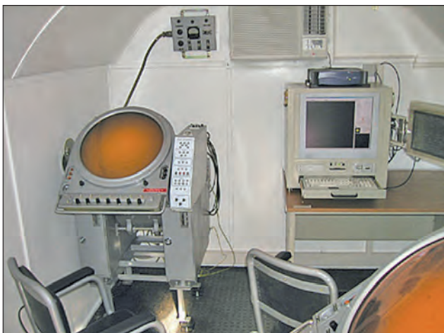
12. ábra. A HM Arzenál által modernizált P-37-es vezérlő- és megjelenítő egysége
