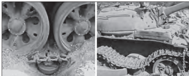
83. ábra. TM-62P3-as akna elhelyezése a harckocsi két futógörgője között, és annak hatása
