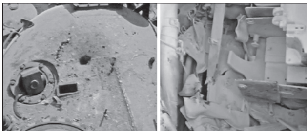
79. ábra. UKA-63-as akna robbanásának hatása a harckocsitornyon, és annak hatása a küzdőtérre
