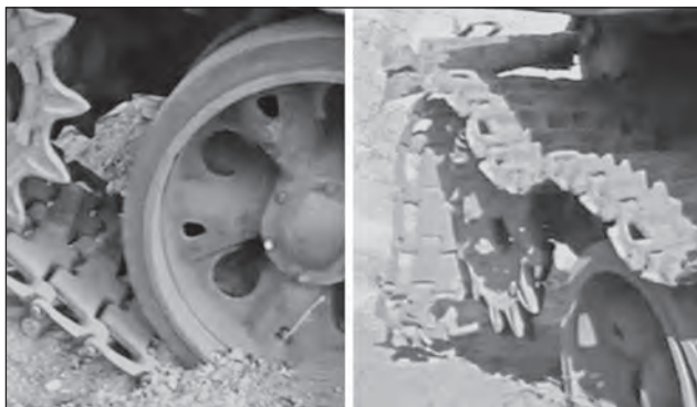
84. ábra. TM-62P3-as akna elhelyezése a harckocsi bal oldali láncmeghajtó kerekére, és annak hatása
