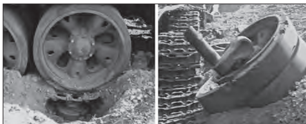
82. ábra. TM-62P3-as akna elhelyezése a harckocsi futógörgője alá, és annak robbanást követő hatása a görgőre
