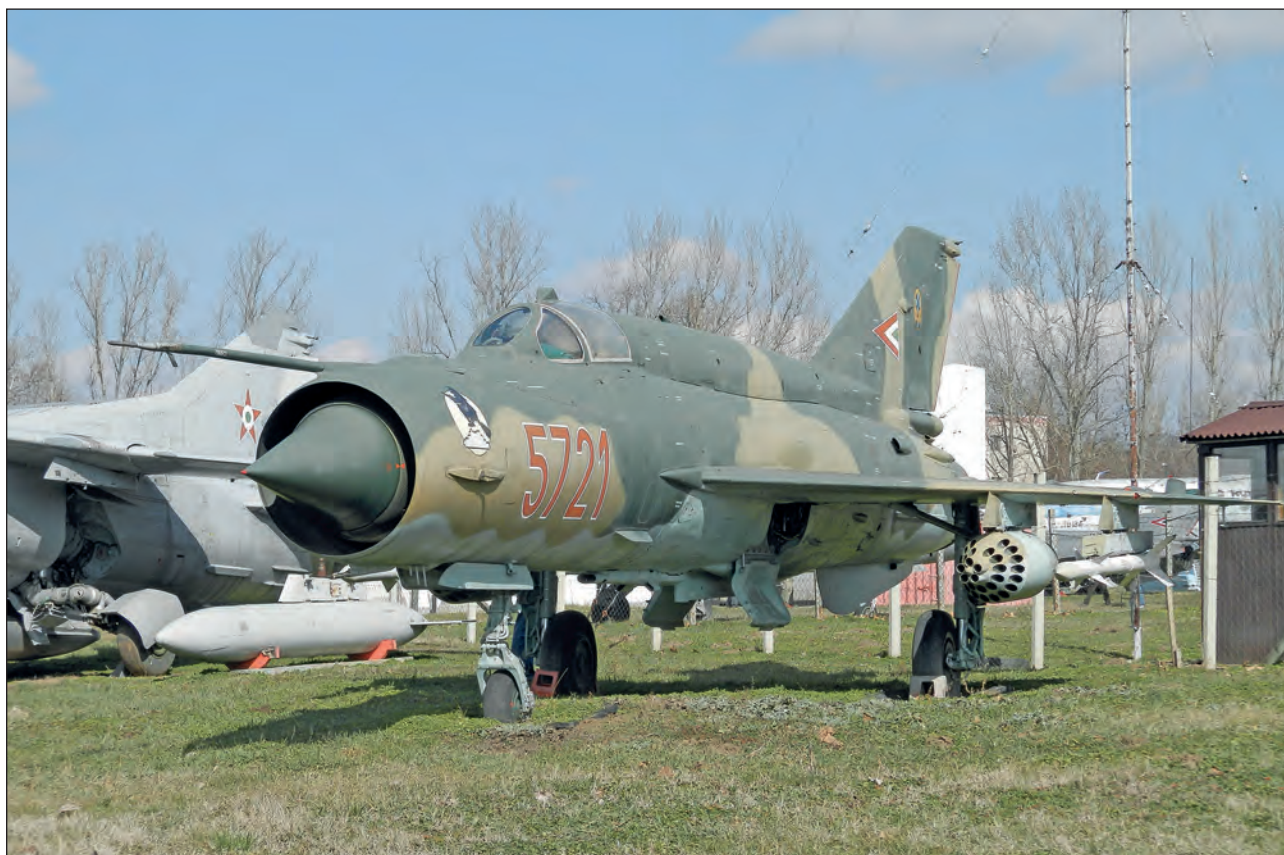
9. ábra. MiG-21 BiSz vadászpilóta, a legnagyobb hajtómű-teljesítményű típusváltozat. A szárny alatt a nem irányított rakéták kilövésére alkalmas UB blokk (Fotó: Baranyai László)
