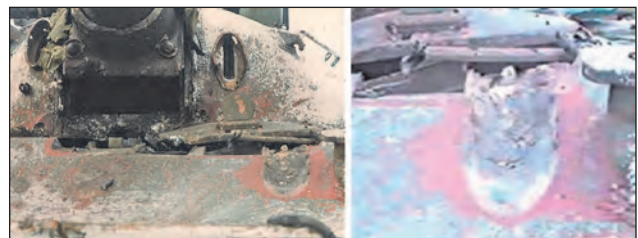
56. ábra. A T-55AM harckocsi gránátjának találat a harckocsi-vezető búvónyílásánál
