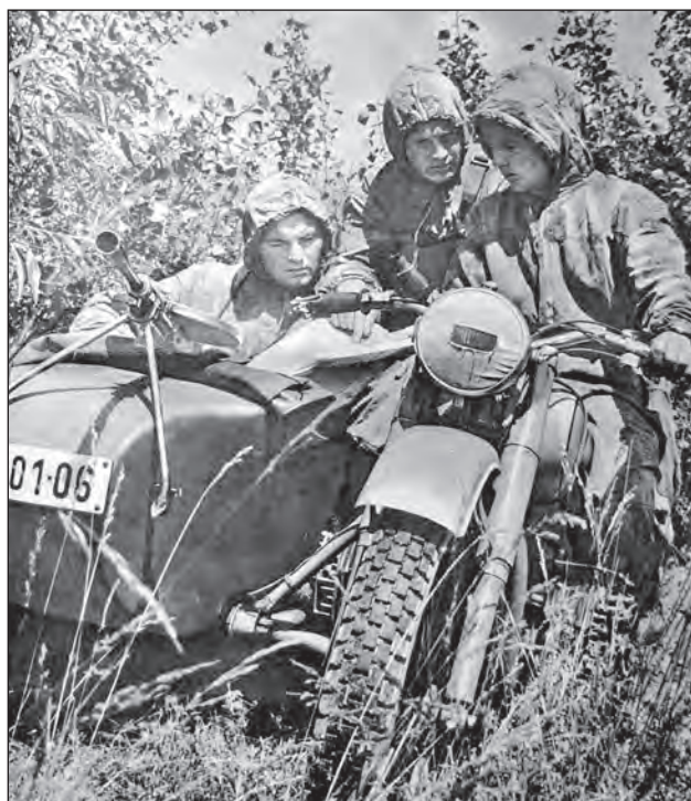
48. ábra. Felderítők M 72 M típusal. A golyószóróállvány az oldalkocsi felszerelése volt, itt hiányzik, tehát a kép kedvéért tették fel (Fotó: Néphadsereg, Bleich Rudolf)
