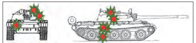
61. ábra. Találatok a célharckocsin T-55AM harckocsi BR-412M páncéltörő gránáttal (Lőtávolság: 1600 méter)
