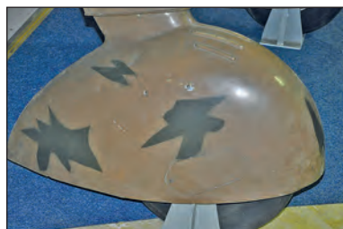
9. ábra. Áramvonalazott burkolatok a farok- és a főfutókon
