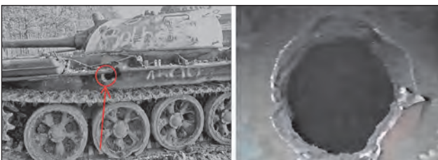
65. ábra. A T-55AM harckocsi gránátjainak találat a páncéltest jobb oldalán, és annak behatolási helye
