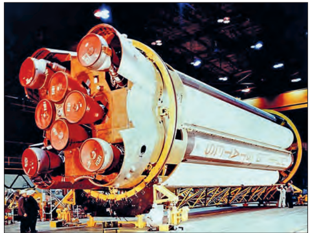
2. ábra. A nyolc darab H-1-es hajtómű elhelyezkedése a Saturn-I első fokozatán (NASA)
