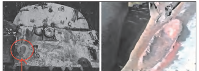
62. ábra. A T-55AM harckocsi gránátjainak találata a homlokpáncél szélén, és annak kagylós bemaródása a homlokpáncél anyagába
