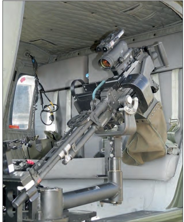
4. ábra. Helikopter oldalajtó-géppuska optikai célzórendszerrel
