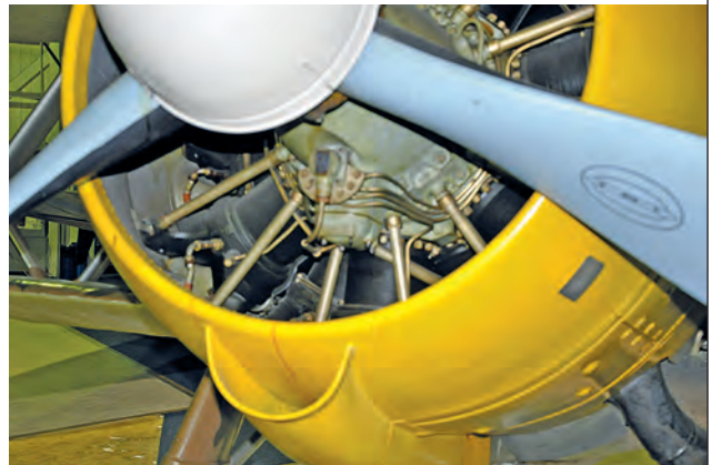
14. ábra. 14 hengeres, kétsoros FIAT A.74 RIC38 csillagmotor, NACA áramlássegítő gyűrűvel
