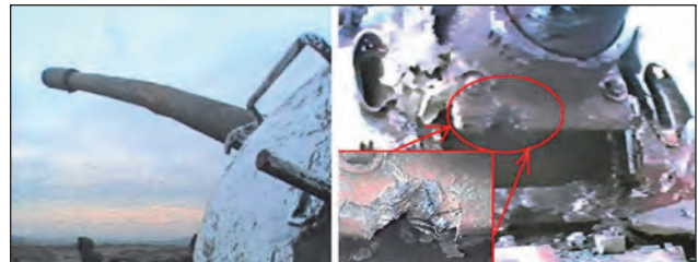
55. ábra. A T-55AM harckocsi gránátjának találat a következőkben meggörbült lövegcső, és a lövegpajzs sérülései
