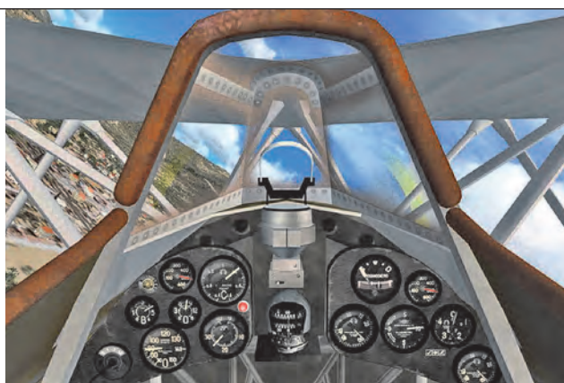
12. ábra. Osztott műszerfal, a bal oldalon a motorellenőrző, a jobb oldalon a repüléshez köthető műszerekkel
