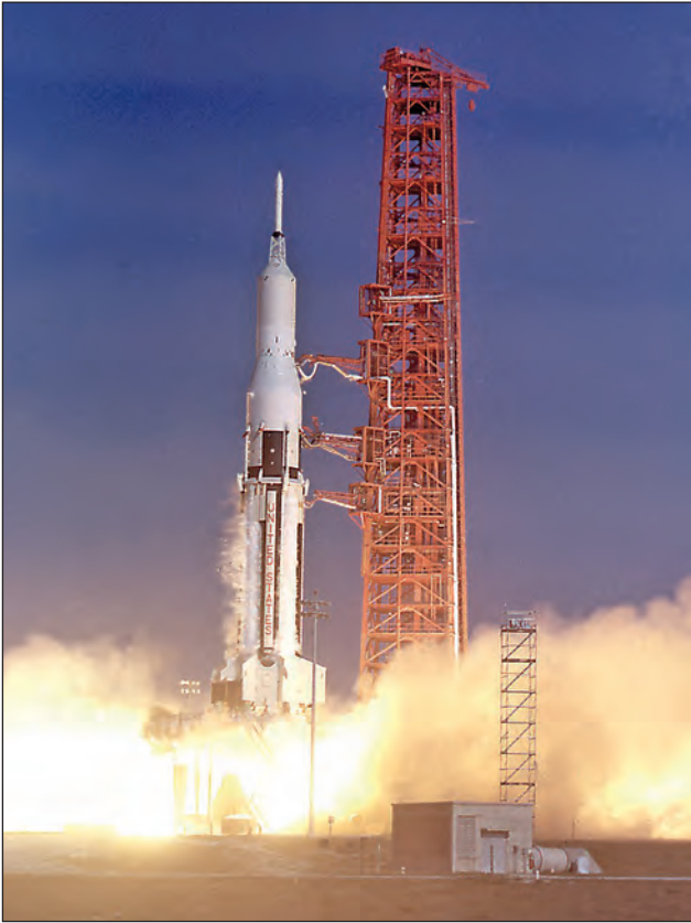
7. ábra. Az 1960-as évek derekán már Föld körüli pályára vitték az Apollo BP űrkabinokat, hogy tényleges repülési körülmények között tesztelhesék a visszatérési és leszállási folyamatot. Az utolsó három repülésen az Apollo BP mellett, a mikrometeoritok észlelésére alkalmassá alakították át a Saturn-IV fokozatot (NASA)
