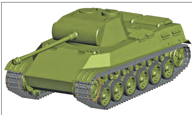
6. ábra. A magyar Tas nehézharckocsi grafikus ábrázolása. A harckocsi nem készült el, a prototípus bombázás áldozata lett
