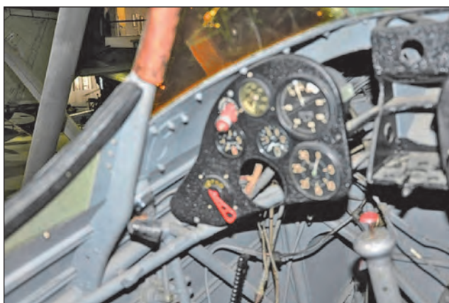
12. ábra. Osztott műszerfal, a bal oldalon a motorellenőrző, a jobb oldalon a repüléshez köthető műszerekkel
