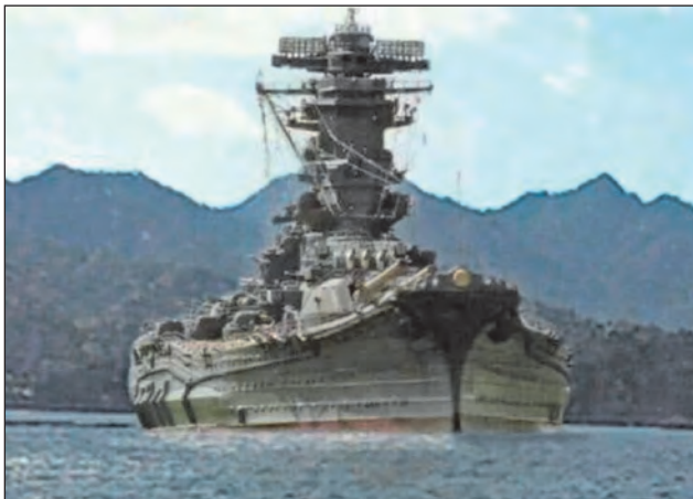
10. ábra. Fent a tornyon a légtérelenőrző lokátor látható, míg a torony középrészén a hajótűzéség tűzvezető lokátora
