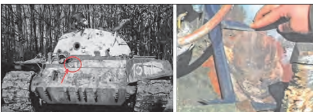
54. ábra A T-55AM harckocsi gránátjának lecsúszó találat a homlokpáncél jobb oldalán, és annak mérete
