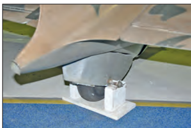
9. ábra. Áramvonalazott burkolatok a farok- és a főfutókon
