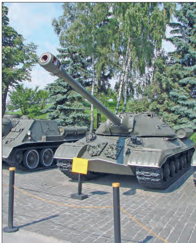
8. ábra. Szovjet ISz-3-as nehéz harckocsi a kijevei múzeumban. A típust hegesztett páncéltest, kedvező kialakítású öntvénytorony, illetve dízelmotoros meghajtás jellemezte
