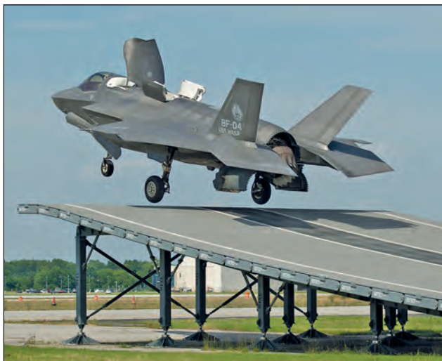
46. ábra. Az F-35B tengerészgyalogsági változat BF-04-es tesztrepülőgépével gyakorolták a „sisáncról” startolást. A brit QUEEN ELIZABETH II. és PRINCE OF WALES repülőgép-hordozók fedélzetéről ezzel a módszerrel lehet üzemeltetni a Villámokat
