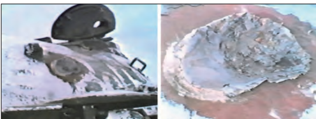
64. ábra. A T-55AM harckocsi gránátjainak találat a torony bal oldalán, és az általa hagyott bemenés
