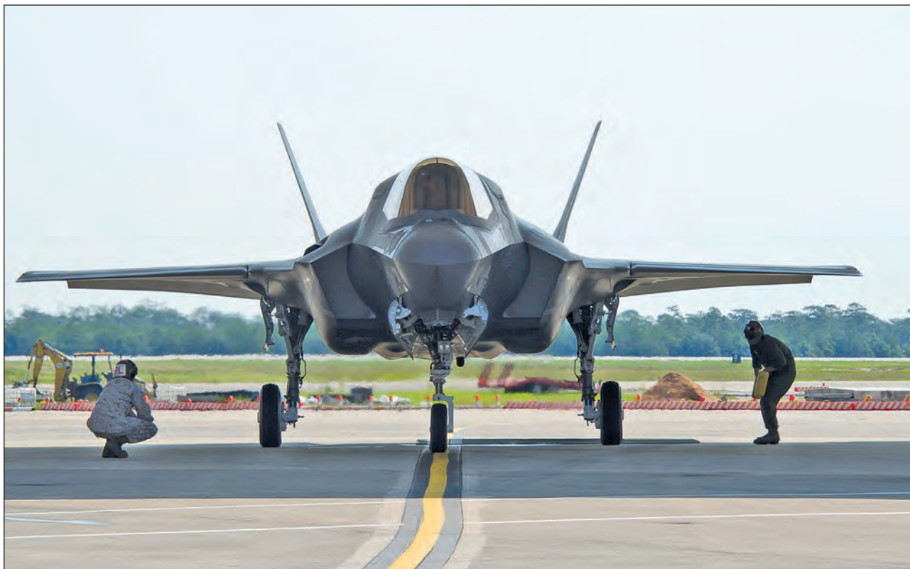
43. ábra. Szemből látszik a legjobban a sárkányszerkezet alakján az F-117A és az F-22-es tervei felhasználásával végzett konstruktóri munka. Az F-35-ös alacsony észlelhetősége ebből a szögől a legkedvezőbb
