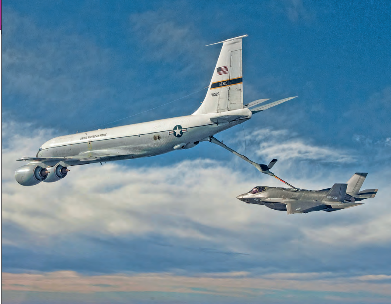
38. ábra. Az F-35A légiérős típusváltozat csak merev tankolócsöves eljárással utántölthető
