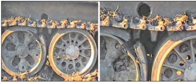
57. ábra. A T-55AM harckocsi gránátjainak találata a páncéltest jobb oldalán, a harmadik és negyedik futógörgő előtt, illetve a negyedik futógörgő peremén
