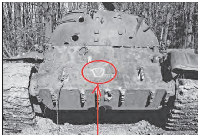
48. ábra. A T-55AM harckocsi gránátjának találata a homlokpáncél közepén
