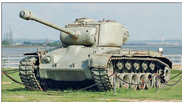
11. ábra. Amerikai M-26-os nehéz harckocsi. Öntvény páncélzat és V-8-as benzinmotor jellemezte a típust
