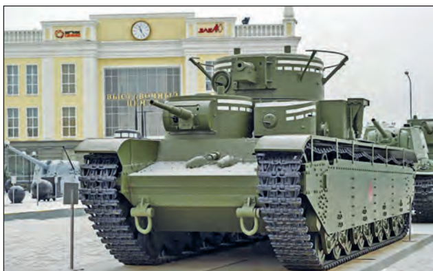
13. ábra. Szovjet T-35-ös nehéz harckocsi, szegecselt páncélzattal, több toronnyal és benzinmotorral. Már a harmincas évek végén is elavultnak számított
