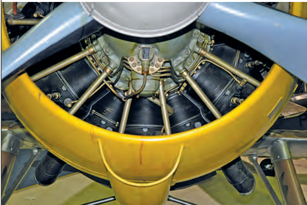
14. ábra. 14 hengeres, kétsoros FIAT A.74 RIC38 csillagmotor, NACA áramlássegítő gyűrűvel
