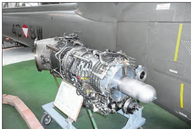
3. ábra. Az UH-1-es helikopter licence alapján épített Agusta-Bell AB-204-es helikopter Bristol-Siddley H 1200-as gázturbinás hajtóműve
