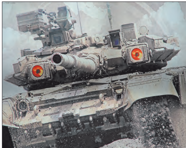
10. ábra. T-90A harckocsi a Shtora aktív védelmi rendszerrel. Ez volt az egyik első kép, amely a rendszerről megjelent a nyugati sajtóban
