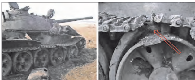
33. ábra. A 2Sz-1-es gránát találat a páncéltest jobb oldalán, és a futóművet ért rongálódások
