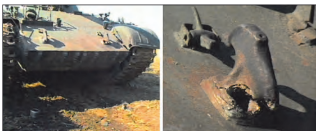
24. ábra. A Maljutka rakétatalálata a bal oldali vonóhorgon
