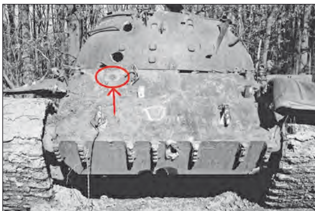
44. ábra. A homlokpáncélt ért találat T-72-es harckocsi gránátjától
