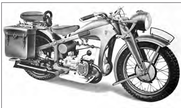
36. ábra. Zündapp K 500-as motorkerékpár, a Wehrmacht számára szállított kivitelben (Fotó: Zündapp)
