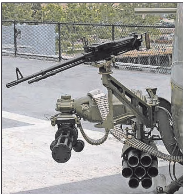
10. ábra. Az UH-1 Gunship (felfegyverzett támogató helikopter) fegyverzete
