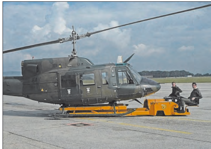
9. ábra. Az UH-1N olasz változata, az AB-212-es. A merevfutós helikopter földi mozgatása speciális eszközt (pl. elektromos szállítókoszt, vagy kerekes vendégfutót) igényel
