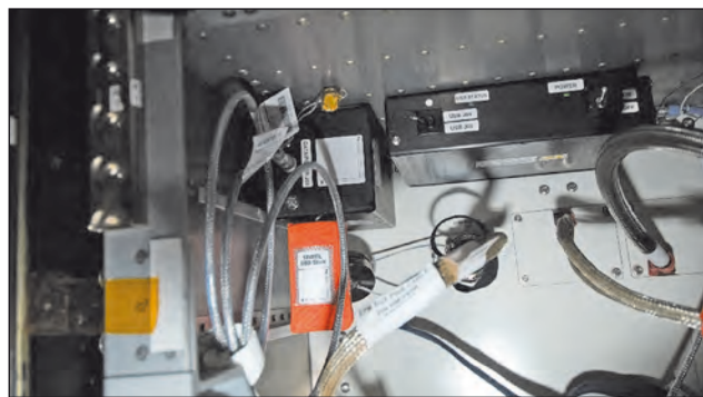
5. ábra. A TRITEL-SURE dózismérő rendszer passzív detektoros egysége (narancssárga színű egység), közvetlenül alatta detektor egysége és központi egysége a Zvezda modulban, 2012. december 22-én (NASA/ESA)
