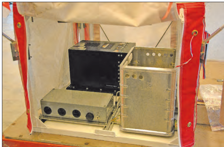
3. ábra. A CoCoRAD kísérleti összeállítás (fekete doboz) a BEXUS-12-es ballon gondolájába szerelve (MTA EK)
