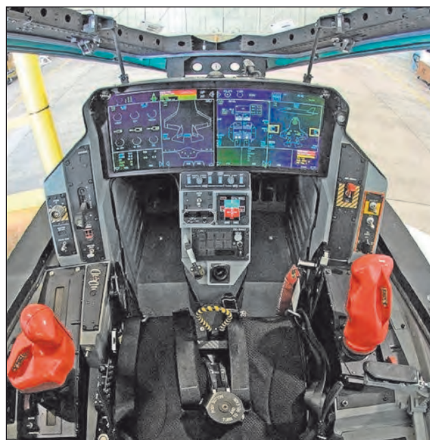
35. ábra. Az F-35 pilótafülkéje. A több képernyős műszerfal és a fejmagasságú kijelző a „HUD” már a múlté. A pilóta vagy a sisakjába vetített, vagy a nagy méretű digitális kijelzőn megjelenített adatokra támaszkodik
