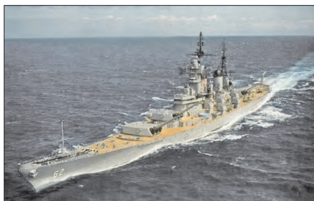
24. ábra. A NEW JERSEY csatahajó oldalsortűz leadására alkalmas helyzetbe forgatott lövegtornyokkal
