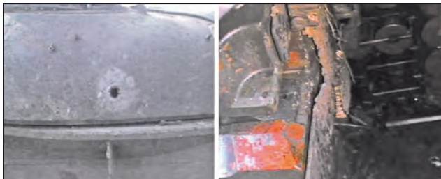
39. ábra. A 2SZ-3-as gránát találata a torony jobb oldalán, és annak hatása a lövegfarra
