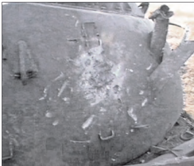
42. ábra. A 2SZ-3-as gránát találatának nyomai a torony jobb hátsó részén
