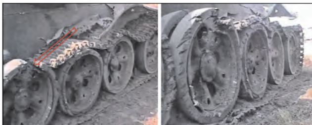
40. ábra. A 2SZ-3-as gránát találata a jobb oldali 4. futógörgőben, és annak hatása a futóműre
