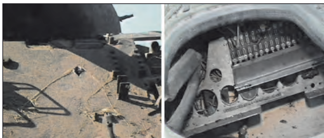
27. ábra. A Konkursz rakéta találata, és a harcjárművezető búvónyílása
