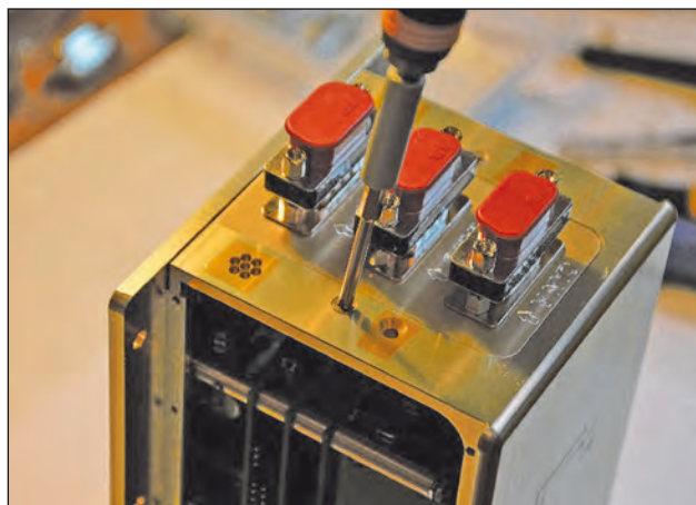
7. ábra. Az ESEO-TRITEL repülő példánya összeszerelés közben
