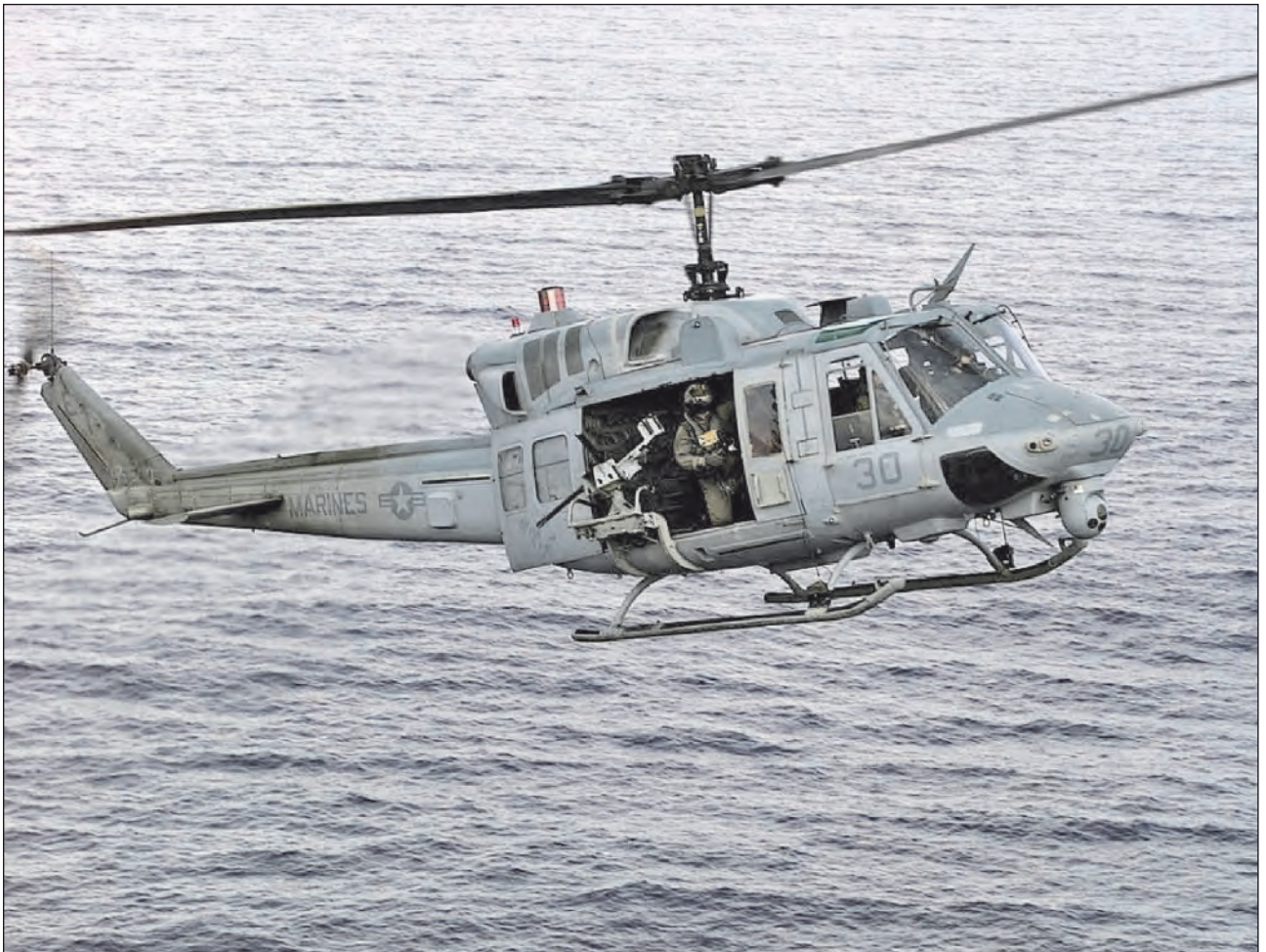
8. ábra. Két hajtóműves UH-1N a tenger felett. A két hajtómű nyújtotta többletrepülési biztonság tenger és település feletti repülésnél különösen fontos
