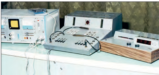
14. ábra. Balról egy korabeli pulzusszámláló, a KGM-ISZSZI percepciómőre és egy GBR mérő. A kis méretű Balaton készülék képes volt a három nagy méretű orvosi műszer hardver-elemeinek kiváltására
