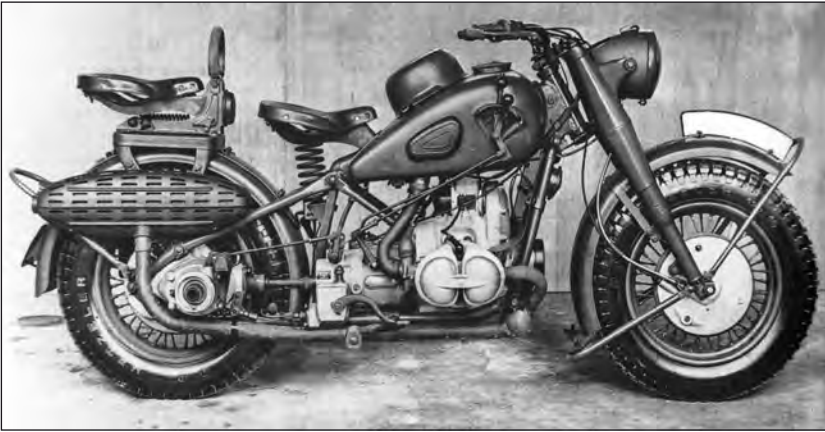
32. ábra. Korai változatú BMW R 75-ös leszerelt oldalkocsival, ahogyan elvéve használták. Jól látszik az oldalkocsihajtás rudazatos kapcsolórendszere, továbbá a tank jobb oldalán a „normál” váltókar és az osztómű (kisebb, külső) kapcsolókarja (Fotó: BMW)
