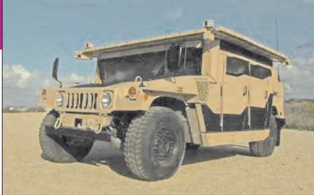
12. ábra. Trophy LV aktív védelmi rendszer egy Humvee katonai terepjáróján. A négy sarokban jól láthatók az érzékelők
