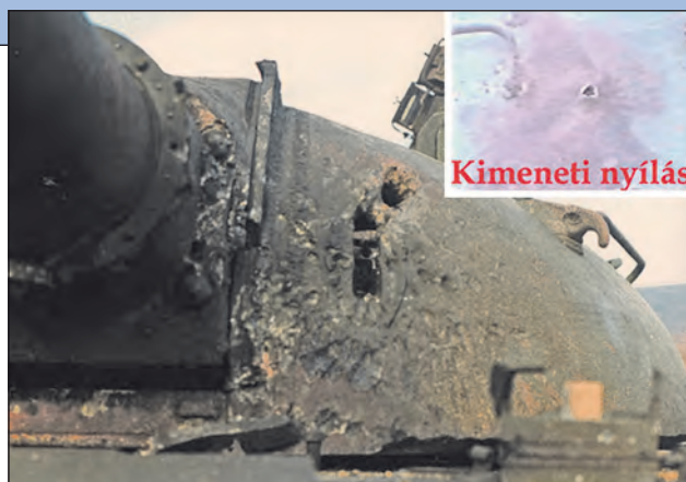
45. ábra. A toronyt ért találat és a kumulatív sugár kimeneti nyílása a torony hátulján
