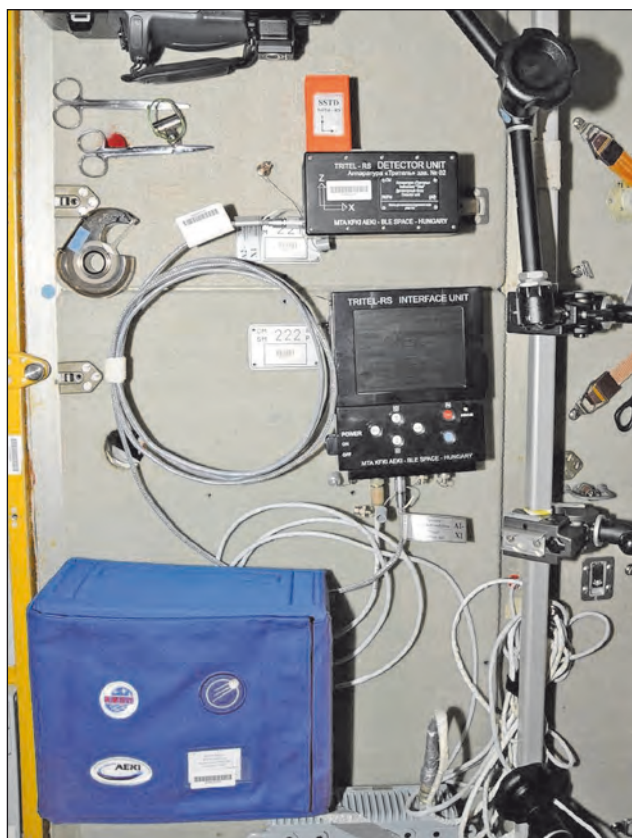
6. ábra. A TRITEL-RS dózismérő rendszer detektoregysége (balra fent), központi egysége (jobbra fent), valamint passzív detektoros egysége (lent) a Columbus Európai Fiziológiai Moduljának (EPM) kiszolgáló részében, 2013. április 4-én (NASA/ESA)
