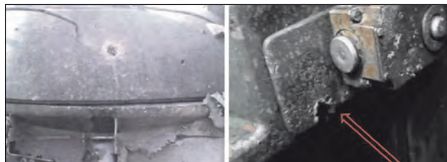
32. ábra. A 2SZ-1-es gránát találata a torony jobb oldalán, és rongálása az ékzár felső pályájában
