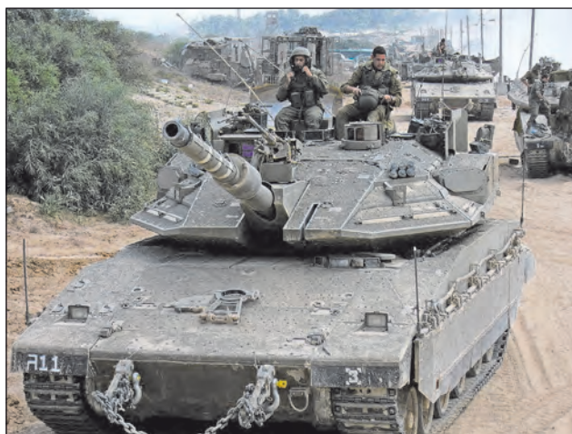
11. ábra. A Merkava Mk4-esen az APS már nem utólag felszerelt eszköz, hanem a gyártás kezdetétől a konstrukció szerves része
