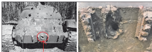
46. ábra. T-72-es harckocsi gránátjának találata a homlokpáncél középső traktusában
