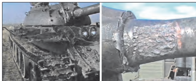
37. ábra. A 2SZ-3-as gránáttalálat a torony jobb oldalán, és annak hatása a lövegcső külső felületére
