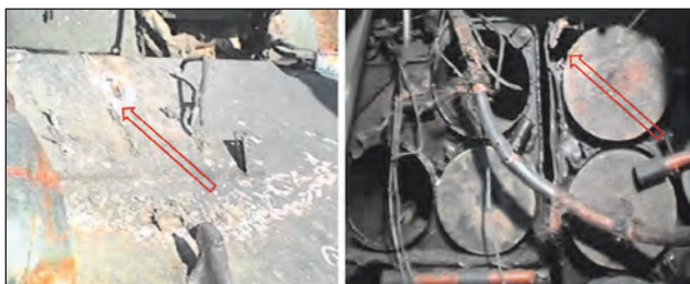
28. ábra. A Konkursz rakéta becsapódási helye a homlokpáncélon, és annak kimeneti nyílása a lőszertartóvá átalakított orrtartályon
