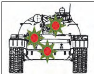
43. ábra. Találatok a célharckocsin T-72-es harckocsi 3BK-14M-es kumulatív gránáttal (Lőtávolság: 800 méter)
