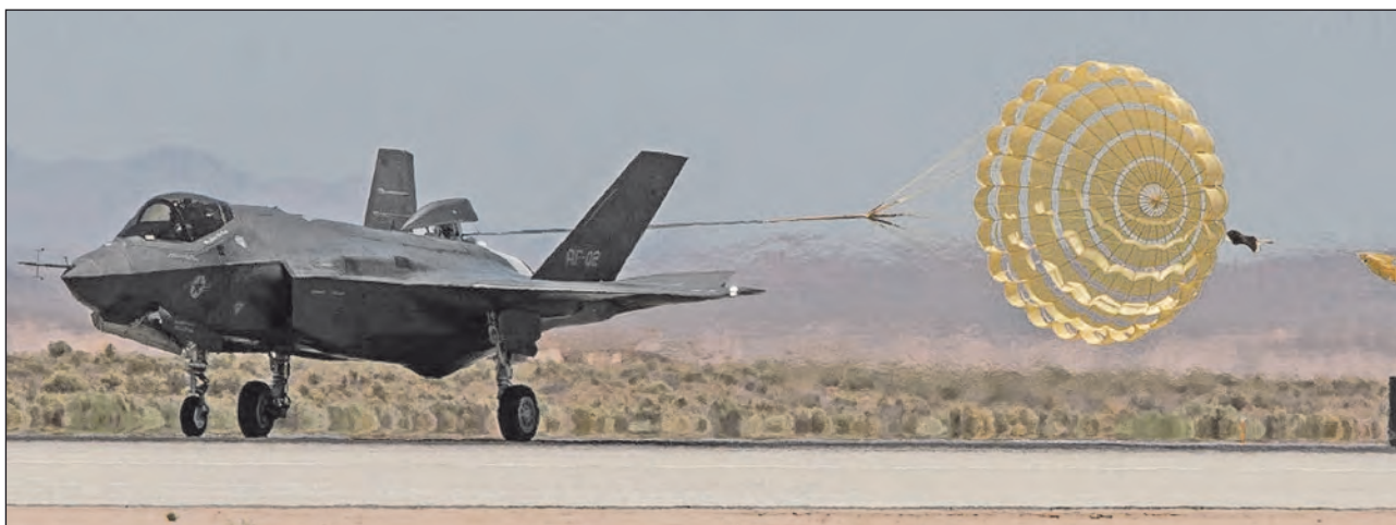
34. ábra. Az F-35-ös fékernyő próbája. A norvég légierő külön fizet a fékernyőért, amelyet felszerelhető konténerben kapnak; beépített fékernyő nincs
