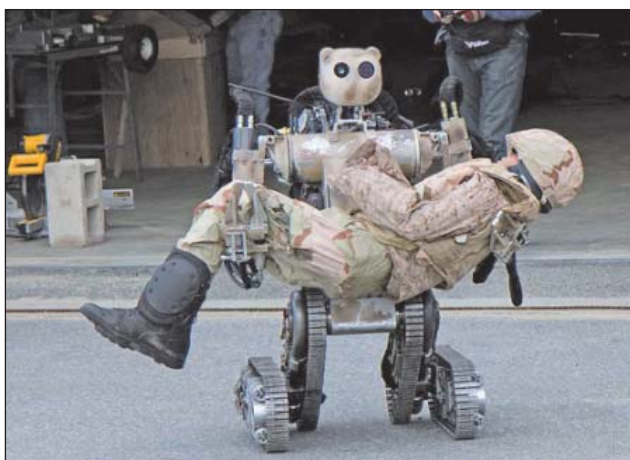
4. ábra. Felegyenesedett helyzetben szállít sebesültet a BEAR katonai mentőrobot (korai változat, még két pár két tagból álló láncaltpal
