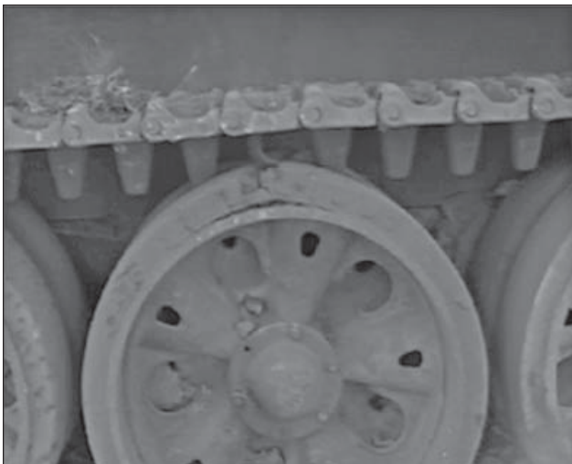
7. ábra. Az RPG-7-es találata a jobb oldali középső görgő felső részén
