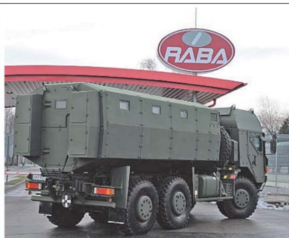
2. ábra. A Gamma Rt. KOMONDOR védett járműve, illetve a Rába Rt. védett-zárt felépítménye (VZF). A Zrínyi 2026 program részeként jövőben a járműtechnikai eszközök széleskörű fejlesztése várható
