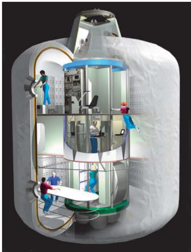
1. ábra. A NASA által az 1990-es években kidolgozott TransHab felfújható modul
