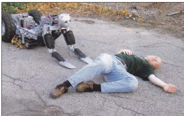
5. ábra. A BEAR mentőrobot felkészül sebesült felemelésére
