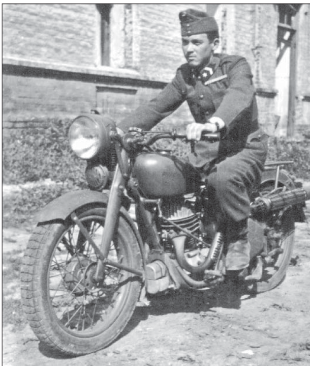
22. ábra. Puch GS 350-es motorkerékpár a Magyar Királyi Honvédségnek szállított kivitelben, tehát Bosch mágnes (magdino) gyújtással (amelyről itt hiányzik a bőrtok) és málhatartóval
