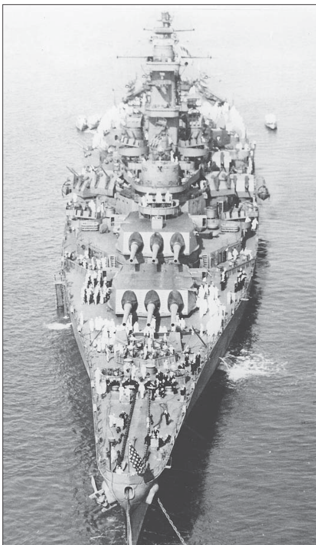
16. ábra. A NEW JERSEY, valószínűleg 1943-ban. A kép beállítására a hosszú orr-részt nem igazán adja vissza. A légvédelmi lövegek ekkor: 20 darab négycsöves 40 mm-es állás és 49 db egycsőű 20 mm-es gépágyú, de az orrba épített, két 20 mm-es befogadó állás még nincs meg. A hajóhíd is még a lekerekített változat
