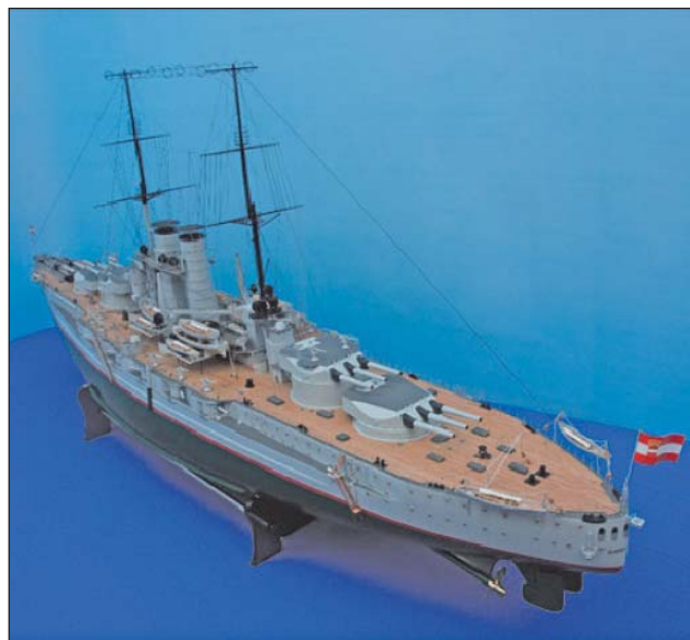
6. ábra. A 4 darab hármass toronyban elhelyezett 12 darab 305 mm-es löveg jelentős tűzerőt képviselt (Fotó: dr. Hűvös Ferenc modellje)
