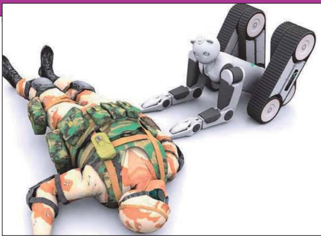
7. ábra. Korai koncepció a BEAR mentőrobotról, ahogy felkészül a sérült katonára emelésére
