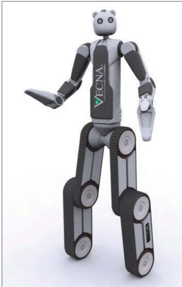
2. ábra. Korai koncepciós ábra a mentőrobotról – már ezen a változaton is látható a BEAR három állásban rögzíthető kialakítása
