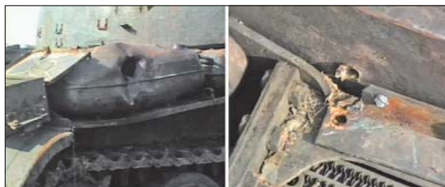
5. ábra. Az RPG-7-es találat a jobb hátsó külső üzemanyagtartályon, és áthatolása az oldalpáncélon a harckocsimotor vízhűtője felett
