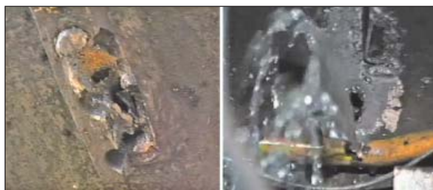
4. ábra Az RPG-7-es találat a bal alsó akna kifordító rögzítő felületen, valamint hatása a küzdőtérben a lyukas üzemanyag-vezetékre
