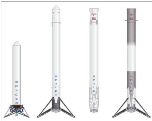
2. ábra. Az első fokozat visszatérési próbáihoz használt példányok. A Falcon-9-es hajtóműves visszatérési változatai, balról:
