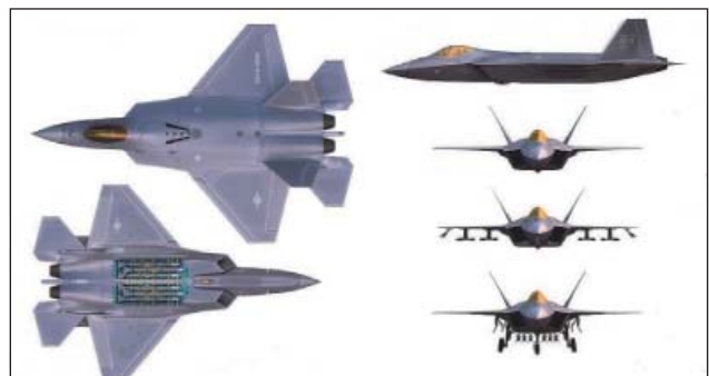
8. ábra. Jól láthatóak a belső és külső tartók a KF-X-102-es (C103-as) terven
