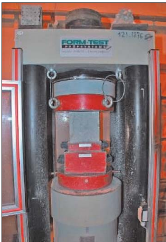
15. ábra. Nyomószilárdság mérése a BME Építőanyagok és Magasépítés Tanszék laboratóri- umában
