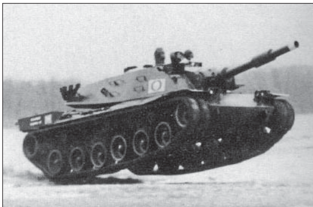
40. ábra. A KPz 70-es harckocsi hidropneumatikus rugózás vizsgálata
