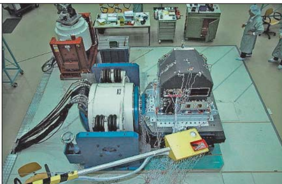
12. ábra. Vibrációs vizsgálatok; balról jobbra: kártya és CDMS, Philae, Rosetta-Philae szinten [Forrás: a szerző (kártya és CDMS) és az ESA (Philae illetve Rosetta-Philae)]
