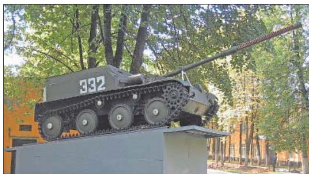
27. ábra. Szovjet ASZU-57-es légideszant harcjármű futóműve két torziós rúddal, Z tengelyenként
