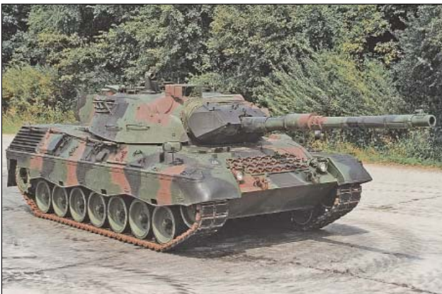
31. ábra. Leopard 1-es közepes harckocsi torziós rugózású felfüggesztéssel
