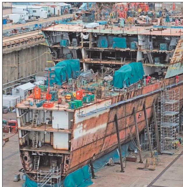
2. ábra. A hajótest orr-részének belső válaszfalai
