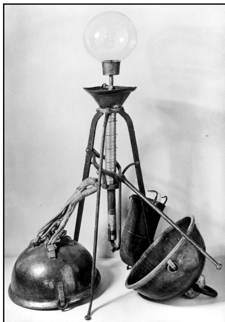
3. ábra • Az eredeti magdeburgi féltekék és egy eredeti Guericke-féle légszivattyú a Deutsches Museumból (Fotó DM)
