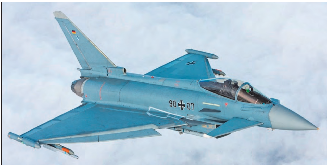
18. ábra. Aerodinamikailag módosított német IPA7 prototípus 2015. júniusban. Az aerodinamikai módosító készletet a Eurofighter Enhanced Manoeuvrability (EFEM) program keretében fejlesztették ki 2015 nyarára. A javított sárkány magasabb állásszöget, 25%-kal nagyobb emelkedési sebességet, jobb orszázást és manőverezést tesz lehetővé
