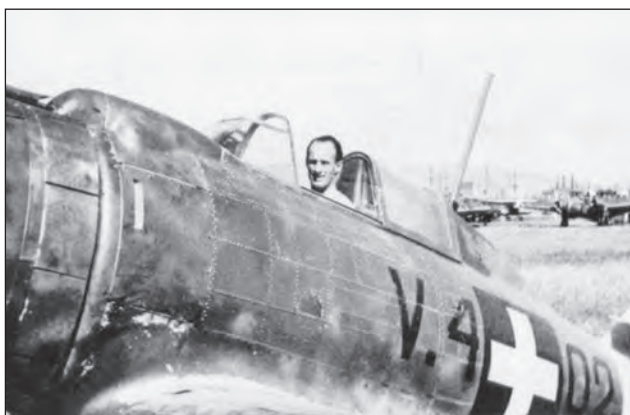
10. ábra. A V.402-es Héja a WM 14B motor és a Danuvia gyártású Gebauer típusú motorhajtású nehézgéppuskák beépítése után. A buborékkabin hátsó része nem üvegezett, hanem burkolt és lefestett. Mire az átalakítással végeztek, már az új keresztes hadijelel rendszeresítették és ezt fel is festették erre a gépre is. A gépen az eredeti fejpárna látható, páncélozás nincs
