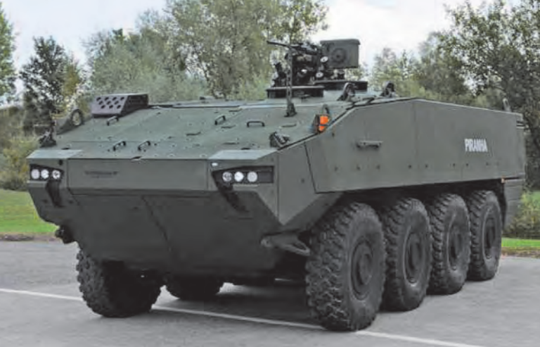
2. ábra. Piranha 5-ös, géppuskával szerelt fegyverállvánnyal
