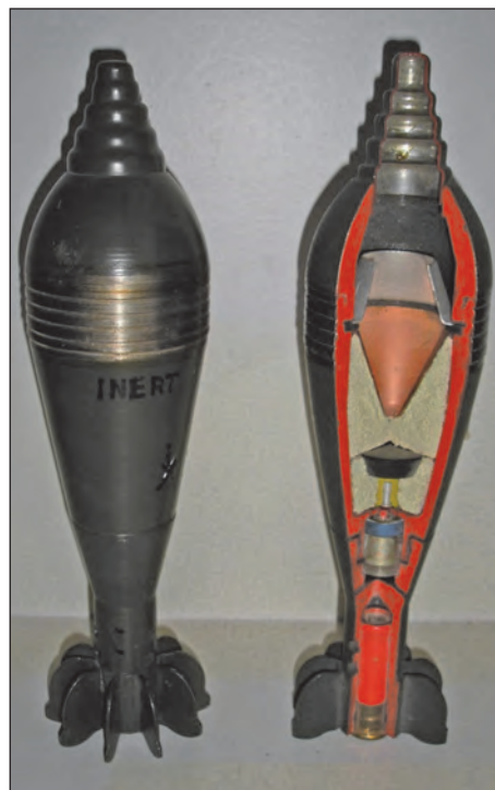
3. ábra. 82 mm-es repesz-kumulatív aknagránát inert és metszet gránátja
