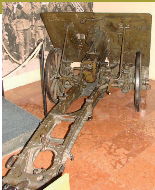
8. ábra. Az 1915/35M fogatolt hegyi ágyú (huszárágyú) az utólag beépített rugózással (S.Gy.)
