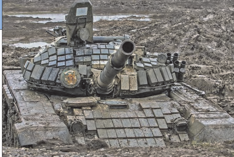
41. ábra. Sárba süllyedt T-72-es. Jól látszanak a reaktív páncél robbanótégla
