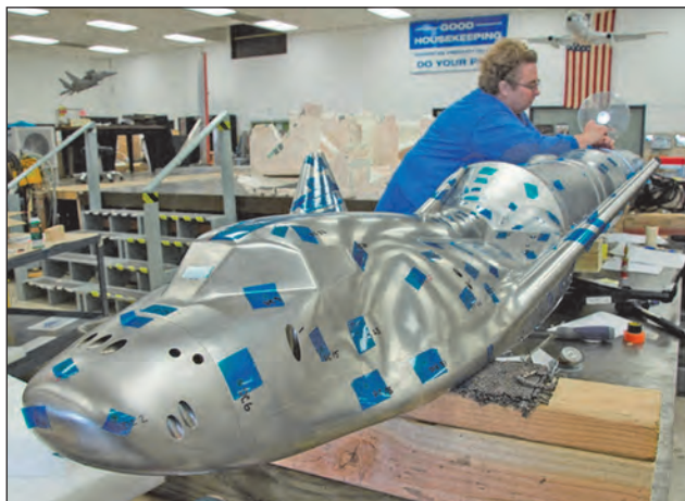
3. ábra. A Dream Chaser űrrepülőgép kicsinyített modellje a ráerősített hordozórakéta-fokozattal Langleyben, a NASA szélcsatornájában végzett kísérletre való előkészítés közben
