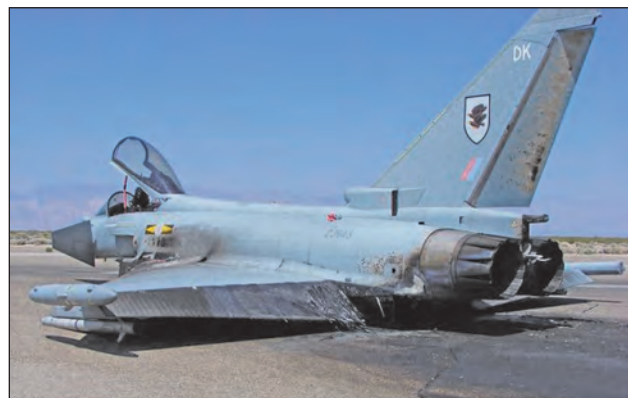
19. ábra. A Brit Királyi Légierő ZJ943-as oldalszámú Typhoon vadászbombázója az Egyesült Államokbeli China Lake haditengerészeti támaszponton, fegyvertesztlés követően, kemény landolás után tört össze 2008. áprilisban
