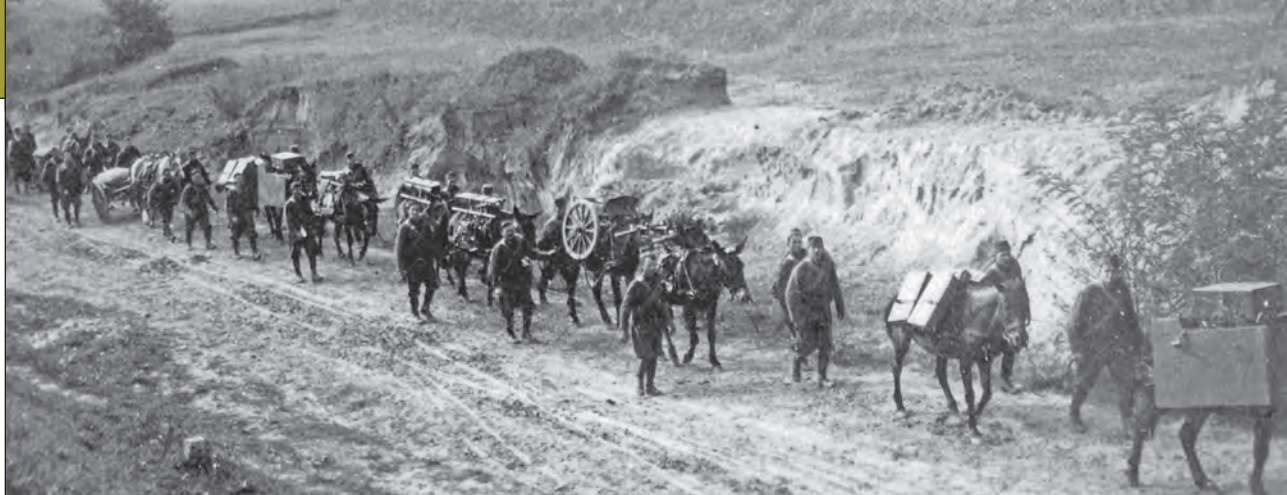
1. ábra. Az 1915M hegyi ágyút eredetileg részekre szerelve, málházva szállították a hegyi csapatok (Fortepan 38971)
