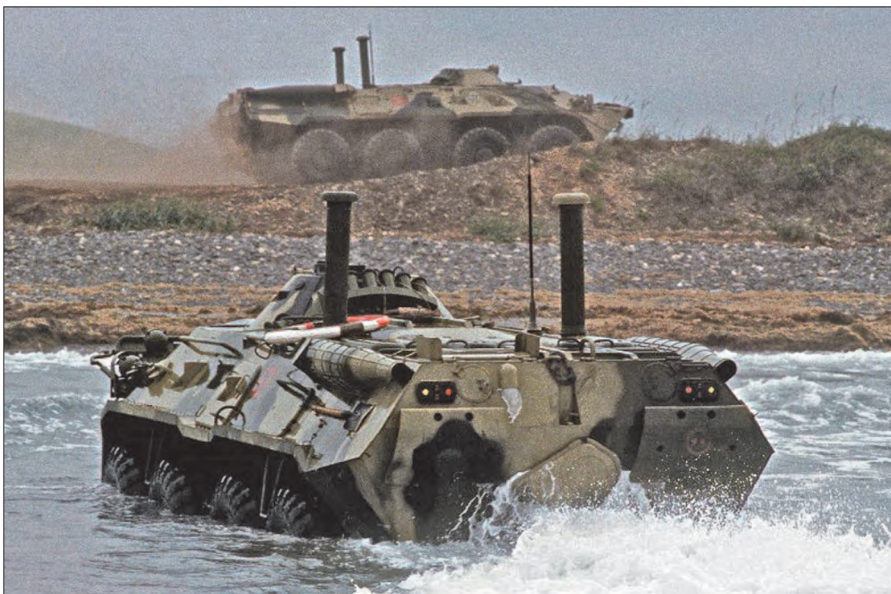
14. ábra. BTR-80-as páncéloszott jármű vízsugar-hajtóműve működés közben. Segítségével a jármű vízen 9 km/h sebességgel mozoghat
