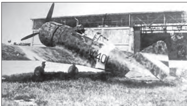
8. ábra. A „repülő próbapad”: a börgöndi hangár előtt áll az olasz motornál jóval erősebb WM 14B motorral szerelt V.401. Háromszínű, homok alapon zöld-barna foltozású festés. A törzs sárga csíkja és az azon felülfestett gépjelzés arra utal, hogy a fénykép a Szovjetunió elleni hadbalépés után készült (1941. június 26.)
