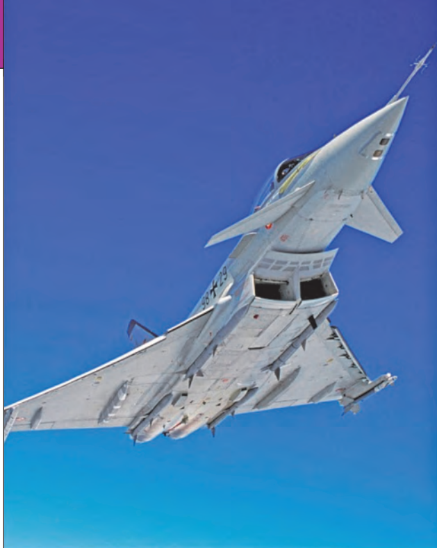
20. ábra. Négy AIM-120 AMRAAM és két IRIS-T rakétafegyverzete a Luftwaffe Eurofightereinek
