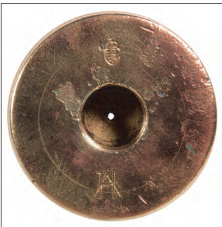
9. ábra. Nyershüvely bélyegzések. Az 1930-as évek átvételi bélyegzője felül, Állami Hadianyaggyár jelzése alul
