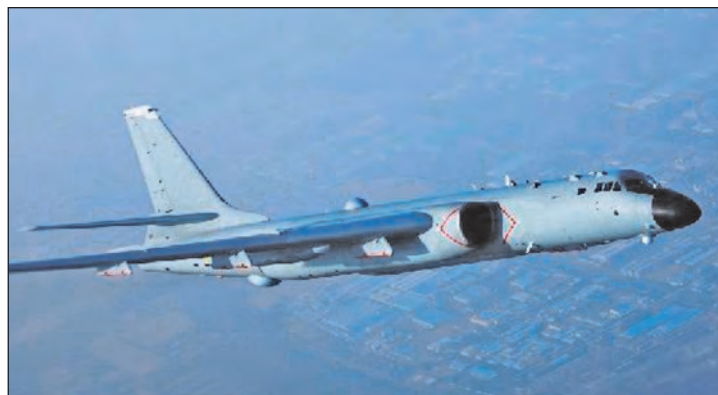
14. ábra. A H-6K hadászati bombázók hatótávolsága már eléri a 3500 km-t és 6 db CJ-10A-s 1500 km-es hatótávolságú robotrepülőgép hordozására képes. (S.Gy.)
