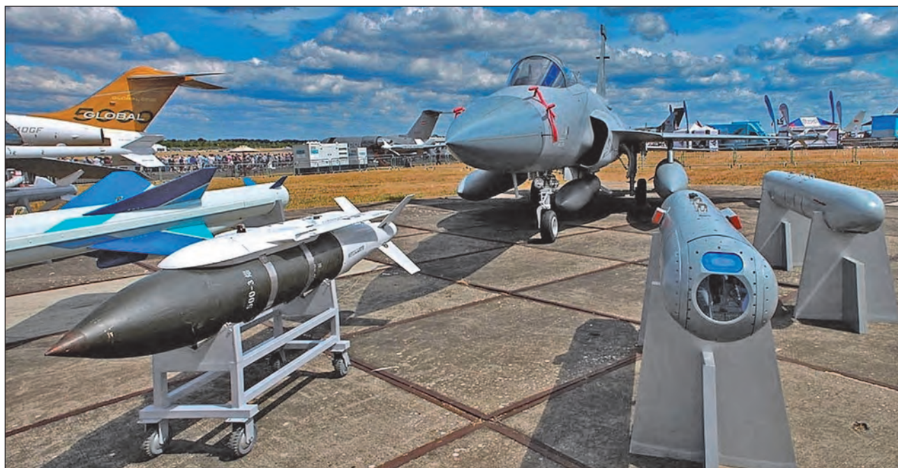
13. ábra. Néhány példány a JF-17-es Thunder repülőgép által hordozható eszközökből. Az előtérben egy 500 kg-os, LS-6-os GPS-vezérelt sziklóbomba és egy WMD-7-es optikai- és infracsaturnás célzókonténer (S.Gy.)
