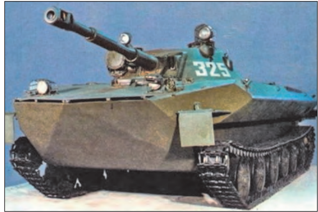
10. ábra. PT-76M változat. Jól látható az úszó képesség és a stabilitás tulajdonságainak javítása érdekében hidrodinamikai elvek figyelembevételével módosított orr-rész és a páncéltest oldalsó része
