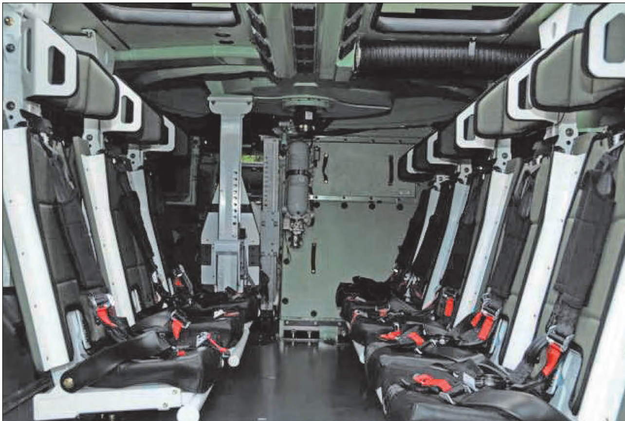
4. ábra. A harcjármű belső tere, függesztett, aknaálló ülésekkel
