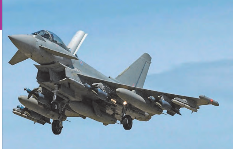
23. ábra. Eurofighter leszállás közben, nyitott törzs-féklappal, teljes fegyverzettel
