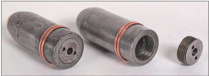
10. ábra. Szétszerelt 30 mm-es páncéltörő lövedékek. Jól látszik a szerkezeti kialakítás. Mindkét lövedék dísz tárgy volt, ezért vannak a fenékcsavarak középen átfúrva
