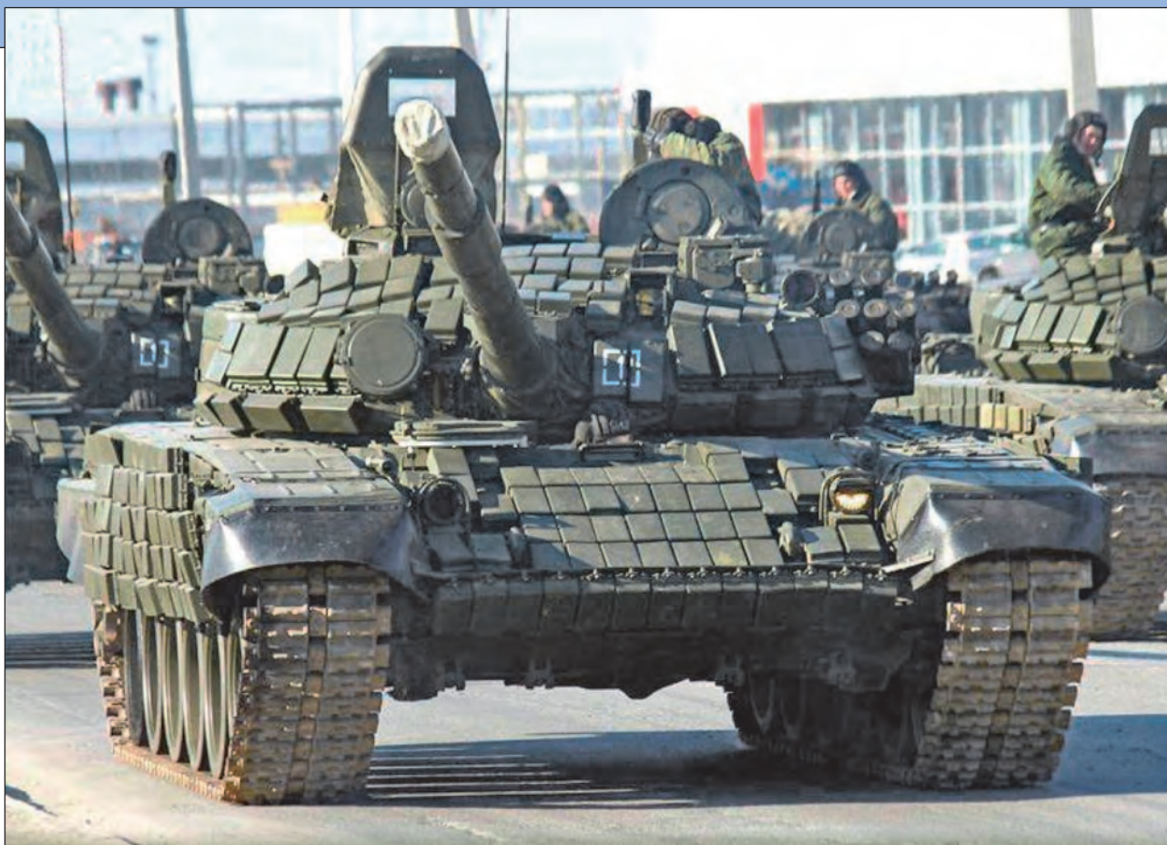
38. ábra. Reaktív páncéllal felszerelt orosz T-72-es harckocsi
