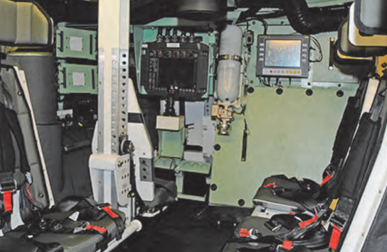
8. ábra. A képen két aknaálló ülés, elöl a fegyverplatform-kezelő munkahelye, balra elöl a járművezető helye látható
