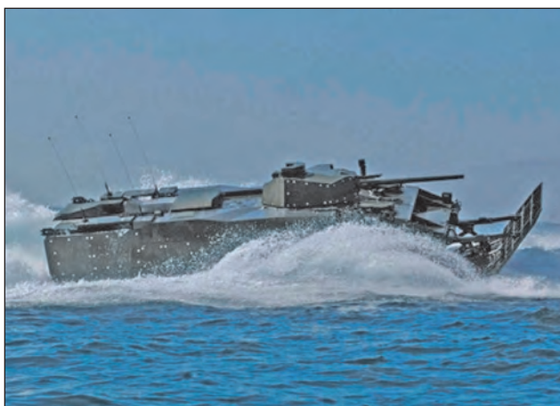
17. ábra. A legújabb amerikai EVF úszó harcjármű, előretolt hullámtörő lemezével nagy sebességgel halad a vízen
