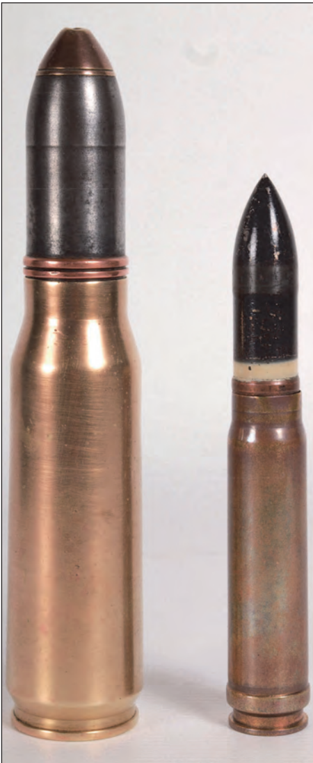
8. ábra. Fénykép a 30 × 139-es magyar kísérleti gépágyúlőszerőről. Jobbra mellette egy 20 × 105B 36M nehéz-puska páncélgránát-töltény
