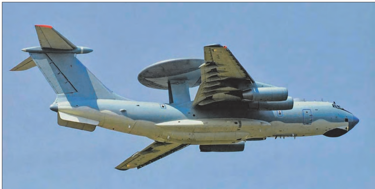
20. ábra. KJ-2000-es típusú légtérrelőrző repülőgép (AWACS) kínai gyártású Il-78-as bázisán (S.Gy.)
