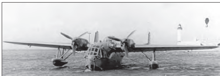
36. ábra. A harmincas években gyártott, két, 890 LE-s motorral szerelt SNCAC NC 4-10-es vízirepülőgép két torpedó, vagy 1100 kg bombateher hordozására volt képes (S.Gy.)
