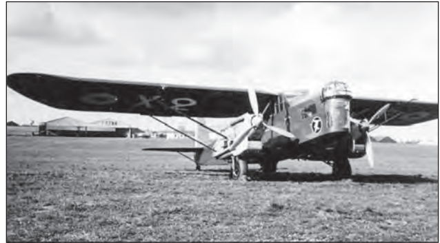
26. ábra. A mintegy egy tonna bombateher hordozására alkalmas francia Potez 540-es felderítő-bombázó (könnyű-bombázó) repülőgépből közel 200 db épült. Futóművei csak részben voltak behúzóhatóak, meghajtásáról két 790 LE-s soros motor gondoskodott (K.I.)
