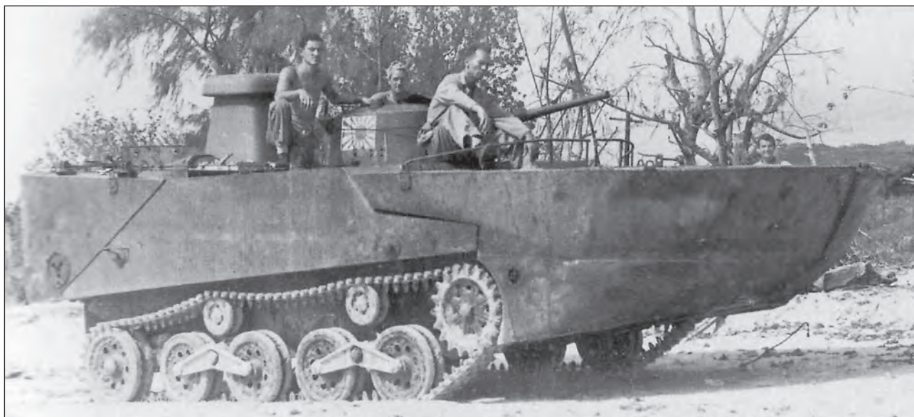
6. ábra. A japán Type-3-as Ka-Chi úszó harckocsi 29 tonnás tömegű, 50 mm páncélvastagságú, 47 mm-es löveggel felszerelt harceszköz volt
