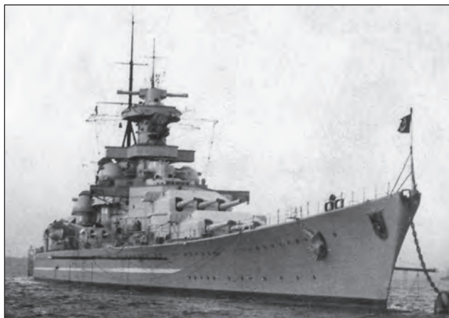
8. ábra. A GNEISENAU az első átalakítások után, 1939 tavaszán. A hajó orrának kialakítása itt már korszerűbb, ívelt vonalú (H.Z.)
