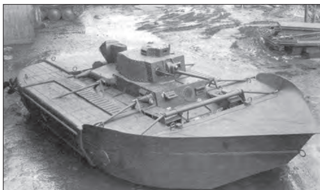
7. a-b. ábra. A Nagy-Britannia elleni partraszálláshoz tervezett német úszóképes harckocsi, amelyet a Pz. Kpwf 38 (t 1 ) (LT vz.38 2 ) könnyűharckocsi bázisán építettek meg
