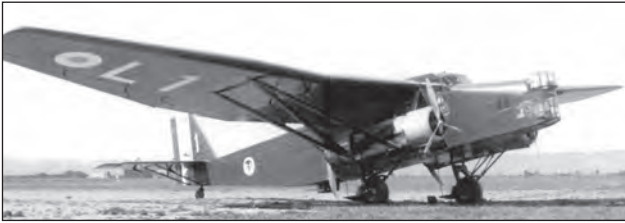
25. ábra. A francia Farman F221-es nehézbombázó repülőgépből tíz darab épült a harmincas évek elején. Két motorgondolájában négy 800 LE-s Gnome-Rhone csillagmotort helyeztek el, vegyes vonó-, illetve tolólégcsavaros megoldással (K.I.)
