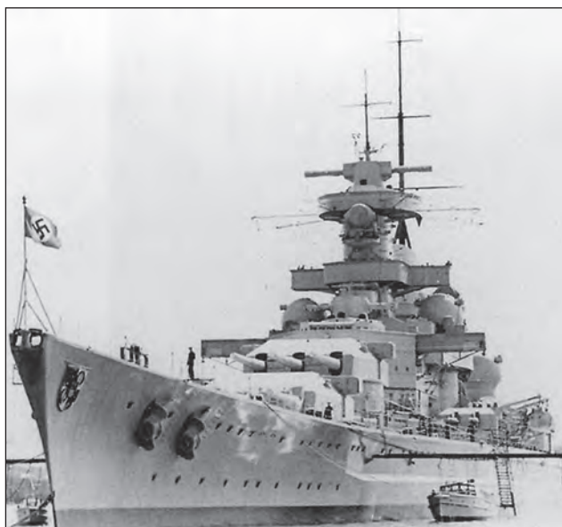
7. ábra. A GNEISENAU fő fegyverzetként kilenc darab, 28 cm-es löveggel rendelkezett. A torony tetején jól látható a tűzvezető rendszer számára adatokat szolgáltató távmérő (H.Z.)
