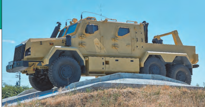
14. ábra. Az RDO-3932-es Komondor páncélozott műszaki jármű 2 + 3 fő szállítására alkalmas a védett vezetőtérben. A platón járművet emelve vontató berendezés, önrakó daru és hidraulikus csörlő került elhelyezésre
