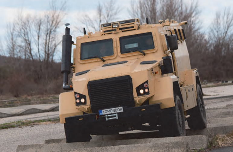
11. ábra. Az RDO-3921-es Komondor páncélozott jármű nagyobb tengelytávolságú az alapváltozatnál, ezáltal 2 + 8 fő felfegyverzett katona szállítására alkalmas
