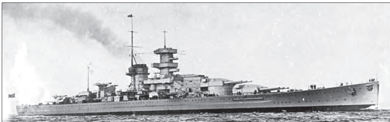
3. ábra. A csatacirkáló kategória páncélzata megközelítőleg megfelelt egy csatahajó páncélzatának (valamivel vékonyabb volt), azonban tűzereje kis mértékben elmaradt attól. A GNEISENAU 30,5 csomós sebessége viszont egy cirkálóénak felelt meg (H.Z.)
