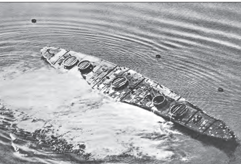
6. ábra. A vízben átfordított hajótest felépítmények nélkül, a tarantói kikötő előtti vízben
