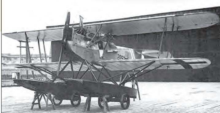
11. ábra. Egy német hidroplán példány a kikötői rámpán, az úszótestek alatt bakokkal és vendég-futóművel
