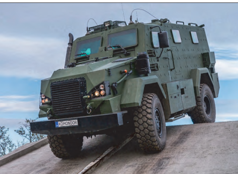
9. ábra. Kiegészítő páncélzattal felszerelt Komondor RDO-3221-es páncélozott jármű a próbapályán
