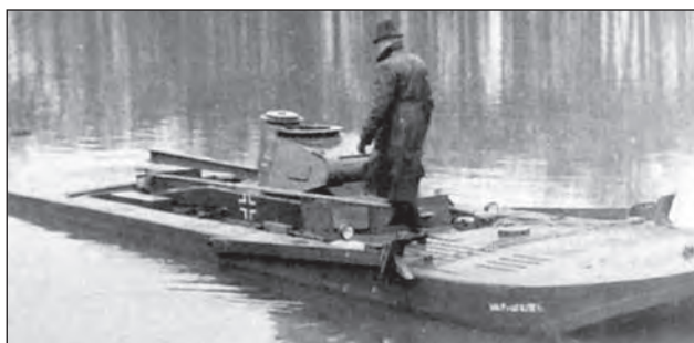
8. a-b. ábra. Próbaúton a Schwimmpanzer II-es. Láthatóak a jármű oldalára szerelt úszótetek. Az úszóképes páncélos a vízben is harcképes maradt
