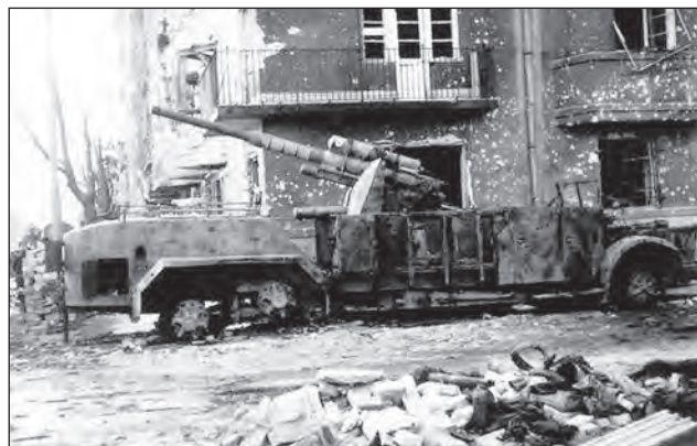
19–20. ábra. Önjáró 88 mm-es löveg VOMAG városi autóbuszalvázon Budán, a Batthyány térnél
