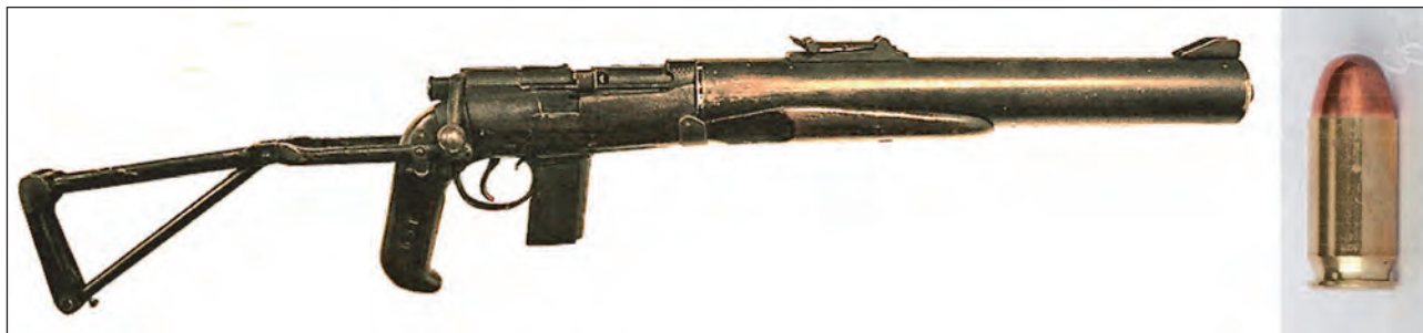
13. ábra. A váltómaszos DeLisle karabély és lőszer, a .45 ACP pisztolylőszer 25
