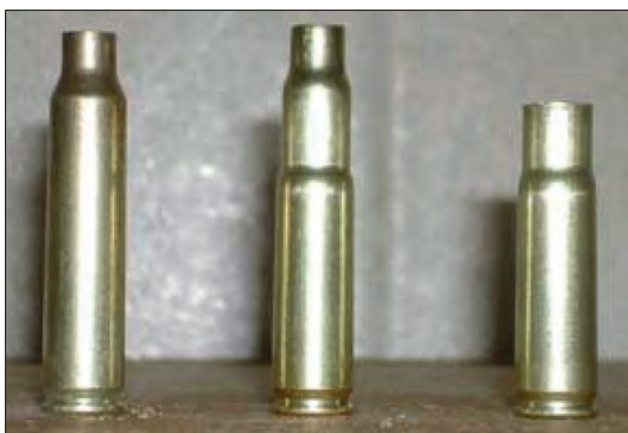
16. ábra. Bal oldalon egy .223-as, középen egy félkész, jobb oldalon egy .300-as Whisper hüvely látható 31
