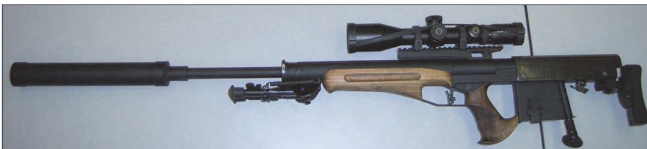
19. ábra. A Szép-féle mesterlövészpuska a rendszerezített hangtompítóval 37
