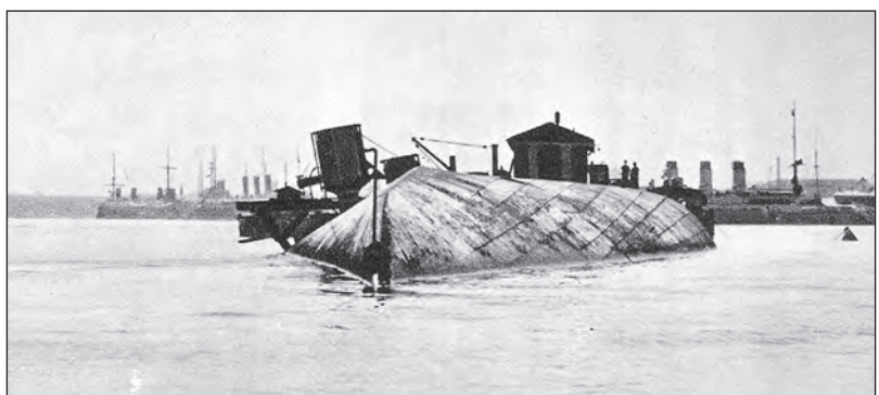
4. ábra. A kiemelés során a LEONARDO DA VINCI felúsztatott hajóteste még fenékkal felfelé van vízben
