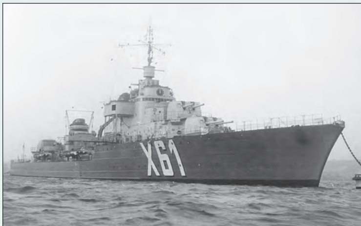
2. ábra. A francia MOGADOR romboló csöves fegyverzete 8 db 138 mm-es lövegből, illetve 2 db 37 mm-es és 2 db 13,2 mm-es légvédelmi fegyverből állt
