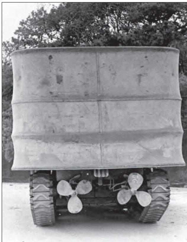
3. ábra. „DD” Sherman harckocsi kettős hajócsavar hajtással
