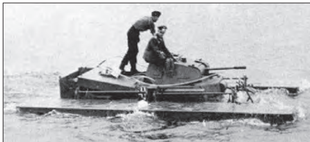
6. ábra. A japán Type-3-as Ka-Chi úszó harckocsi 29 tonnás tömegű, 50 mm páncélvastagságú, 47 mm-es löveggel felszerelt harceszköz volt
