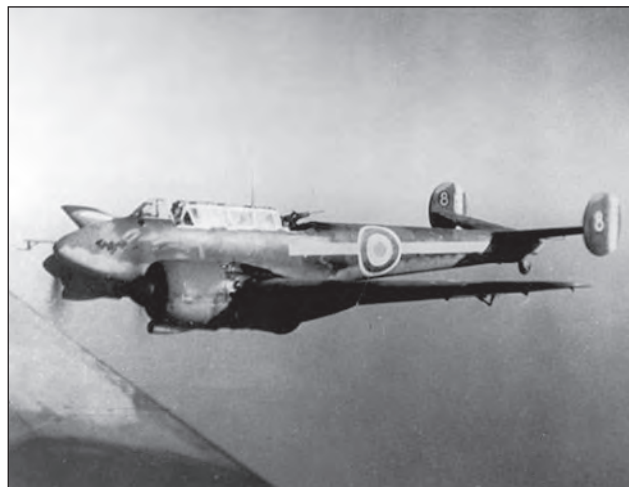
24. ábra. A 780 LE-s Gnome-Rhone csillagmotorral szerelt francia Potez 631-es nehézvadász repülőgépből több, mint kétszáz épült. A 440 km/h sebesség elérésére képes gép fegyverzete 2 db előretűzelő 20 mm-es gépágyú, 1 db hátra néző 7,5 mm-es géppuska, illetve 4 db 7,5 mm-es szárnyakba épített géppuska volt. Könnyűbombázó és éjszakai vadász változatát is gyártották (K.I.)
