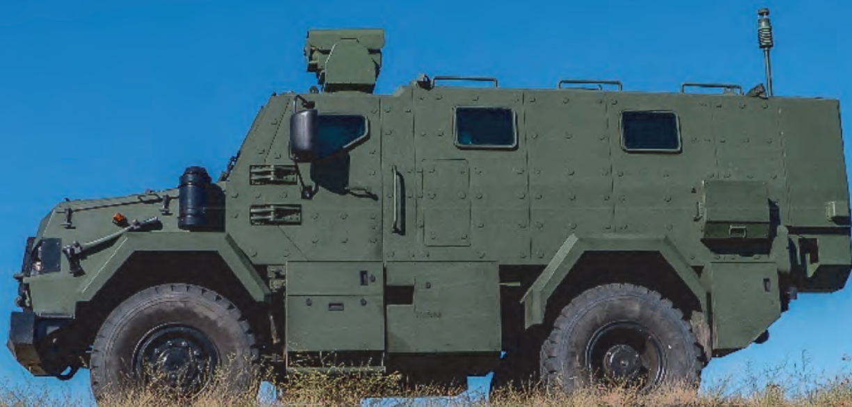
10. ábra. Az RDO-3221-es Komondor ABV felderítő változata kiegészítő páncélzattal
