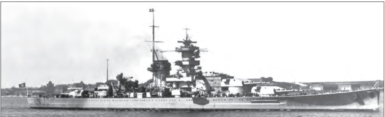
2. ábra. A GNEISENAU eredeti állapotában, nem sokkal szolgálatba állítása után. A hajó orrának kialakítása itt még az eredeti, egyenes vonalú (H.Z.)
