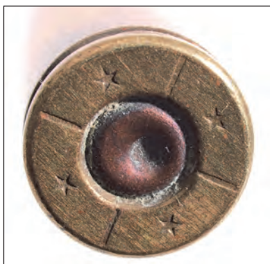
3. ábra. 7,65 mm-es géppisztolytöltény talpbélyegzése
