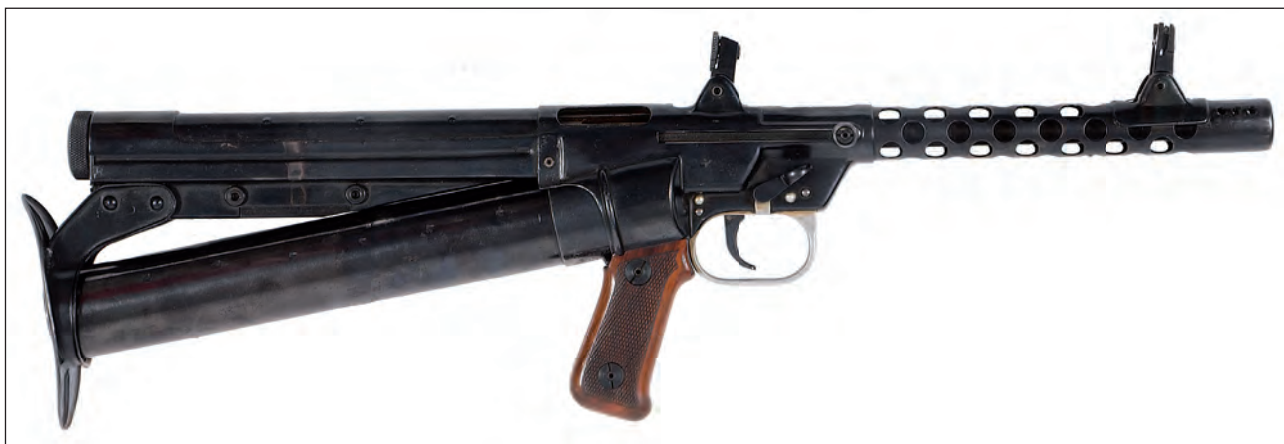
1. ábra. A Győrik-féle szuperkönnyű géppisztoly kísérleti mintája 15
