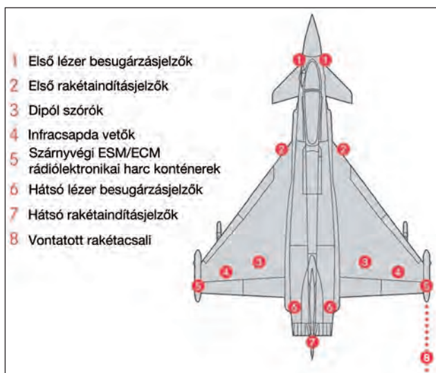
7. ábra. Különböző szenzorok, zavaró- és avionikai rendszerek elhelyezkedése az Eurofighter sárkányszerkezetén
