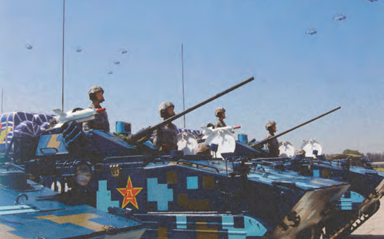
7. ábra. A ZBD05-ös kételtű gyalogsági harcjárművek rendelkezhetnek 2 db HJ-73C irányított páncéltörő rakétaindító állvánnyal is
