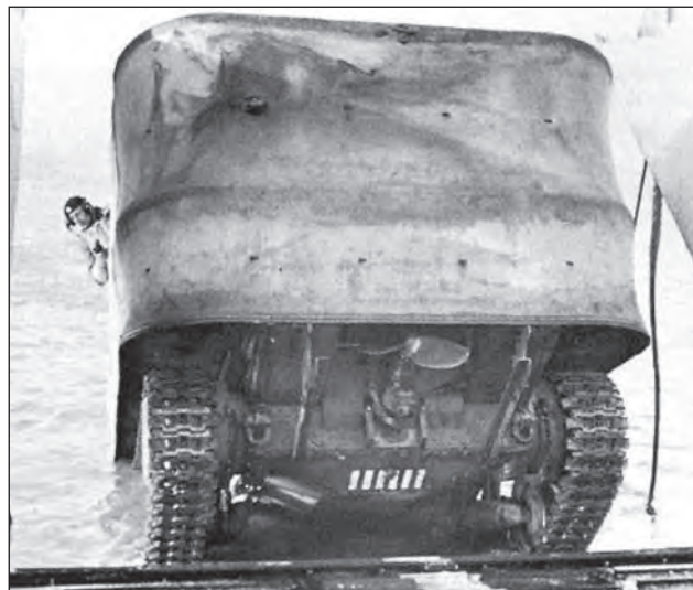
4. ábra. Úszóképes Sherman M4-es harckocsi vízre bocsátása partraszállító hajóról
