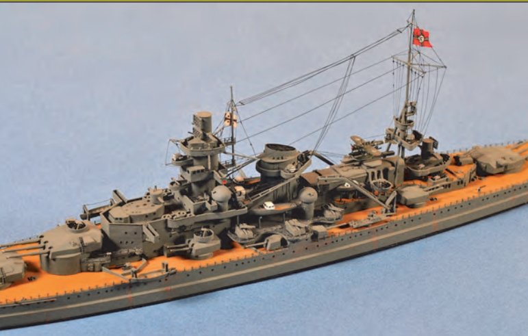
2. ábra. A SCHARNHORST csatacirkáló modellje. A parancsnoki torony tetején, illetve a főárboc mögött jól látható a két előre- és egy hátránéző, az optikai távmérővel együtt 180°-ra forgatható, rács szerkezetű radarantenna (Fotó: Gerencsér Attila, Makett: Dr. Pék György)
