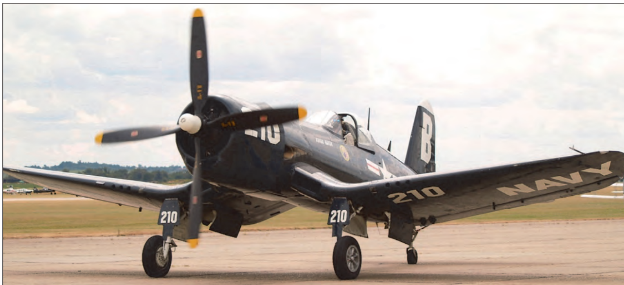
18. ábra. A Chance Vought F4U Corsair megjelenésekor, 1943-ban a legnagyobb teljesítményű, gyors és fordulékony gép volt. Nyolc géppuskával volt felfegyverezve, emellett 454 kg bombát is szállíthatott
