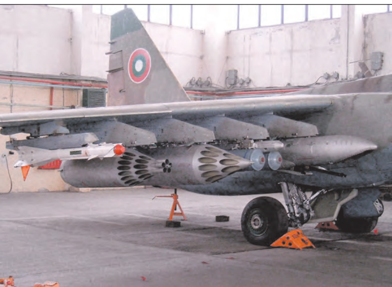
9. ábra. A szárny alatt belülről kifelé felderítő konténer, bombák, nem irányított rakéta blokkok, illetve R-60-as légi harc-rakéta látható függesztve
