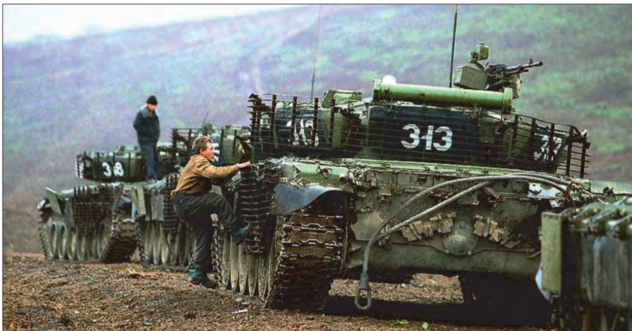
14. ábra. T-72-es harckocsiból álló oszlop RPG védőrácscsal. A rácscok egy részét a csapatjavító alegységek utólag szerelték fel
