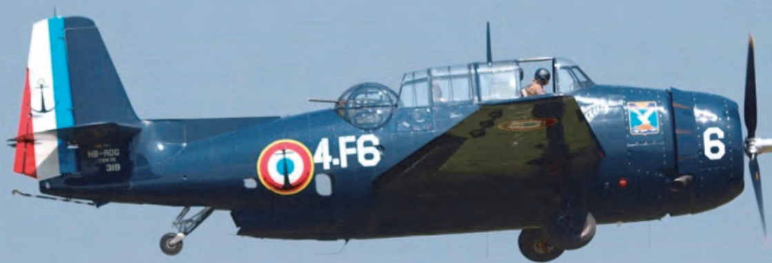
12. ábra. A Grumman TBF Avenger a háború vége felé került a harcoló alakulatokhoz. A támadó feladatokra alkalmas gépnek öt géppuskája volt és 900 kg torpedót vagy bombát tudott célba juttatni
