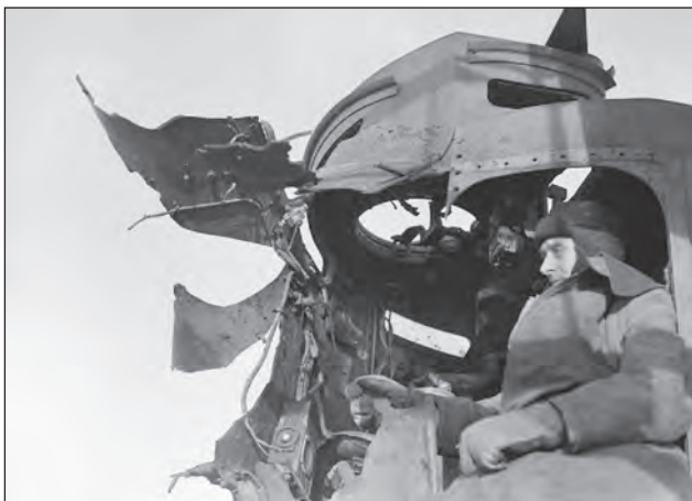
21. ábra. A SAUMAREZ romboló egyik tűzvezető állása, a csatában szerzett sérülésekkel
