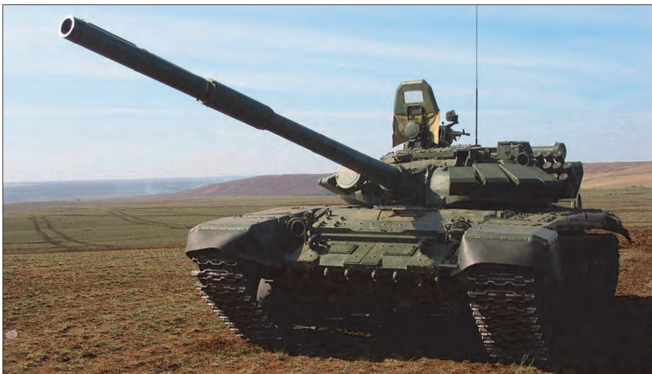
15. ábra. Szovjet T-72-es harckocsi, kiegészítő páncélzattal a homloklemezen és a tornyon
