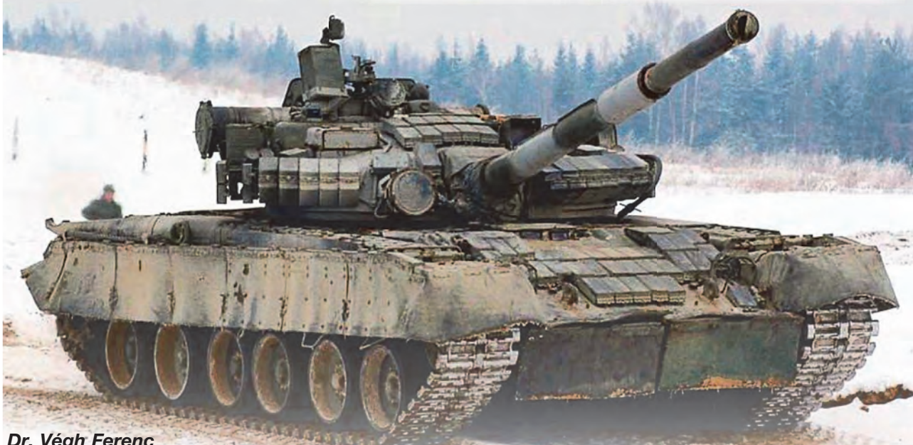
13. ábra. Gázturbinás T-80-as harckocsi. A csecsenöldi harcok során bebizonyosodott a gázturbina repesztalálattal szembeni fokozott sérülékenysége. A csecsen háború után a típus további példányainak egy részét már dízelmotorral szerelték
