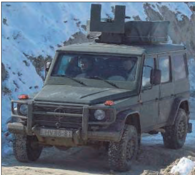
8. ábra. A páncélozott utasterű MB G280 CDI, a forgógyűrűs fegyverállvánnyal 11
