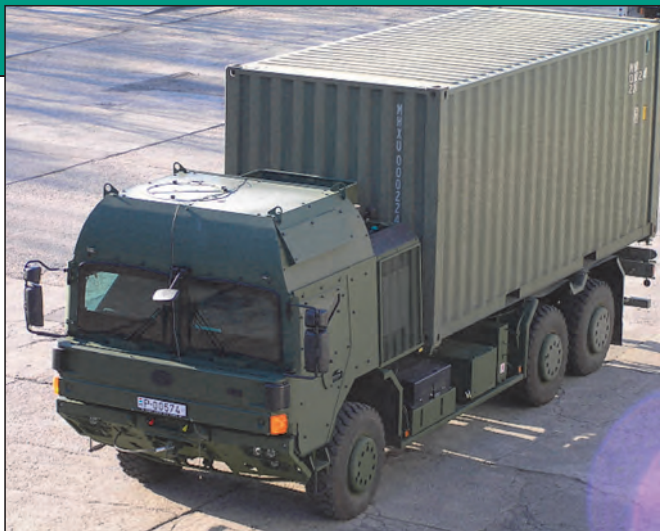
5. ábra. A H25.240 DAEC-111 típusú páncélozott vezetőfülkéjű konténerszállító bázisjármű, felhelyezett 20 „láb” méretű ISO 1CC konténerrel
