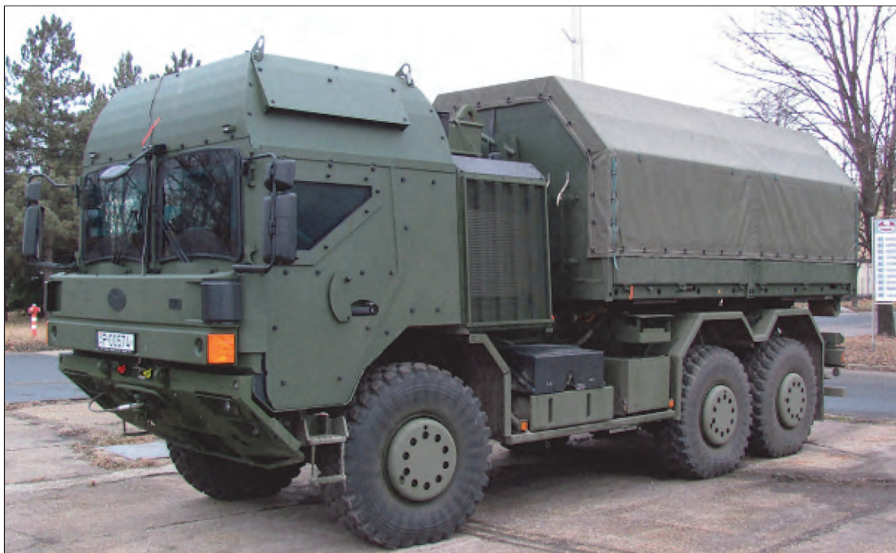
4. ábra. A H18.240 DAE-112 típusú bázisjármű hidraulikus horgos emelővel, (ponyvázott síkplatóval) és páncélos vezetőfülkével
