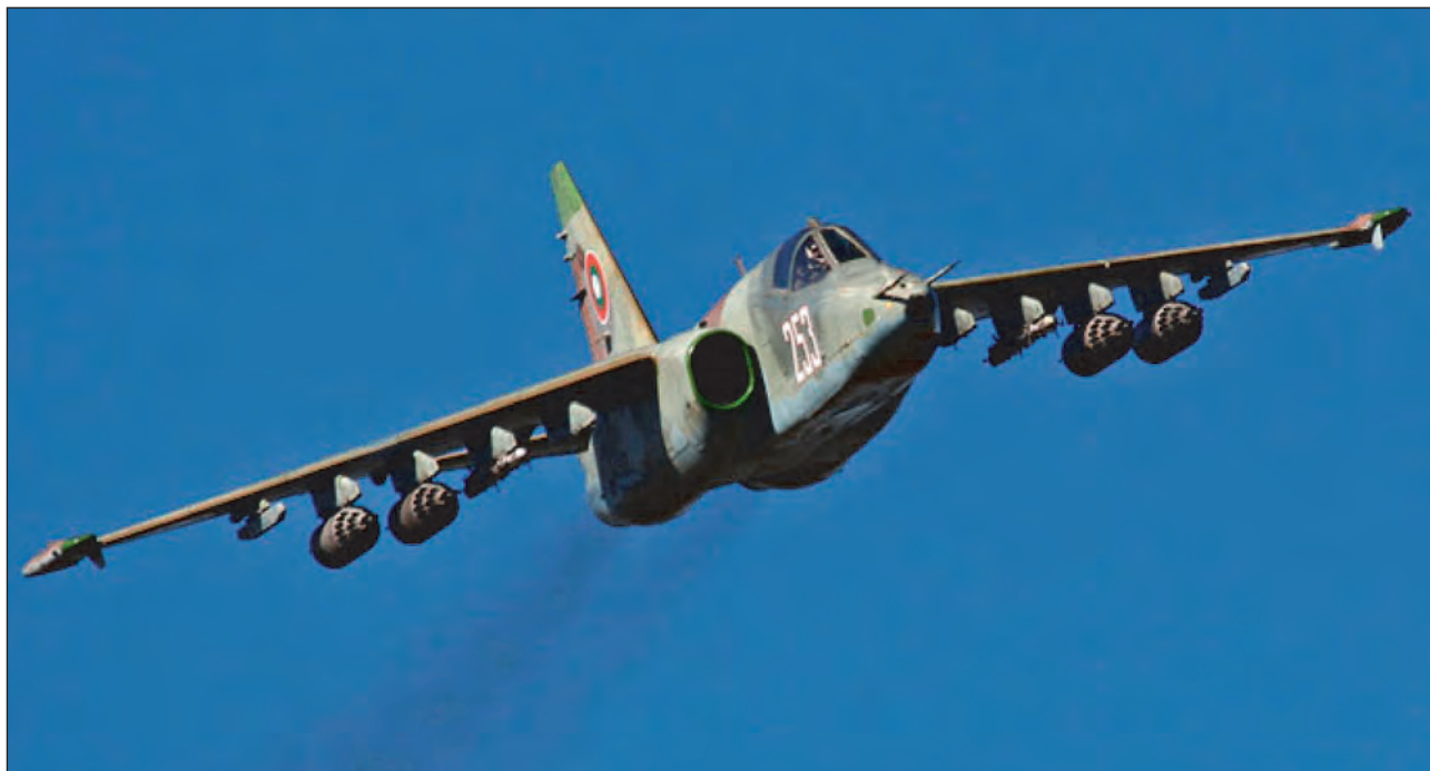
5. ábra. A két darab gázturbinás hajtómű alkalmazása a túlélőképesség növelését szolgálja
