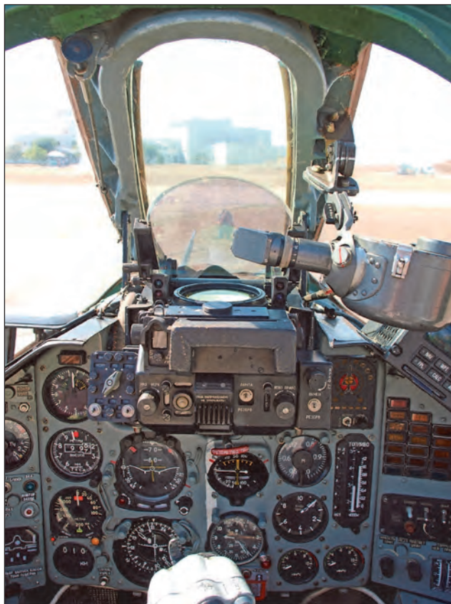
6. ábra. A csatarepülőgép műszerezettsége hagyományos kialakítású. A repülőgép-vezetőt szemből páncélüveg védi
