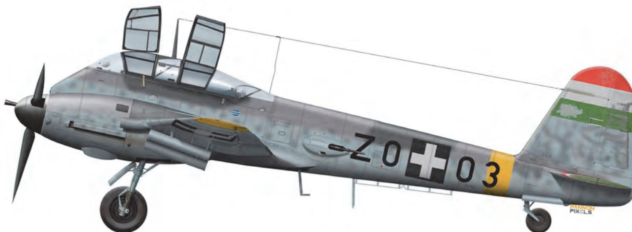
40. ábra. A csepeli Dunai Repülőgépgyárban licenccben gyártott Messerschmitt Me 210Ca-1, utólag átalakított nehézvadász-gép. Oldalszám Z003 (gyári szám 210.007.003), Repülő Kísérleti Intézet (RKI), Várpalota, 1944. október. Álcázószínek: sötétszürke (RLM 74, Kraye 7122.74), középszürke (RLM 75, Kraye 7122.75), világoskék (RLM 76, Kraye 7122.76). Sárga azonosítószín: RLM 04/27 (Kraye C.54). Légcsavarkúp: 1/3 fehér (RLM 21, Kraye G.1115), 2/3 feketészöld (RLM 70, Kraye 7122.70). Nemzeti színek: piros (Kraye G.1114), fehér (Kraye G.1115), zöld (G.1116). Fekete felségjelszín (Kraye C.28/A). A Me 210-en szintén alkalmazott RLM 02 színt is a Kraye szállította 7122.02 kóddal. A repülőgép 40 mm-es gépágyú-fegyverzetének és nem-irányított rakétáinak beépítési programjáért a Haditechnikai Intézet volt felelős (Illusztráció: Szalai Viktor, Pannon Pixels)
