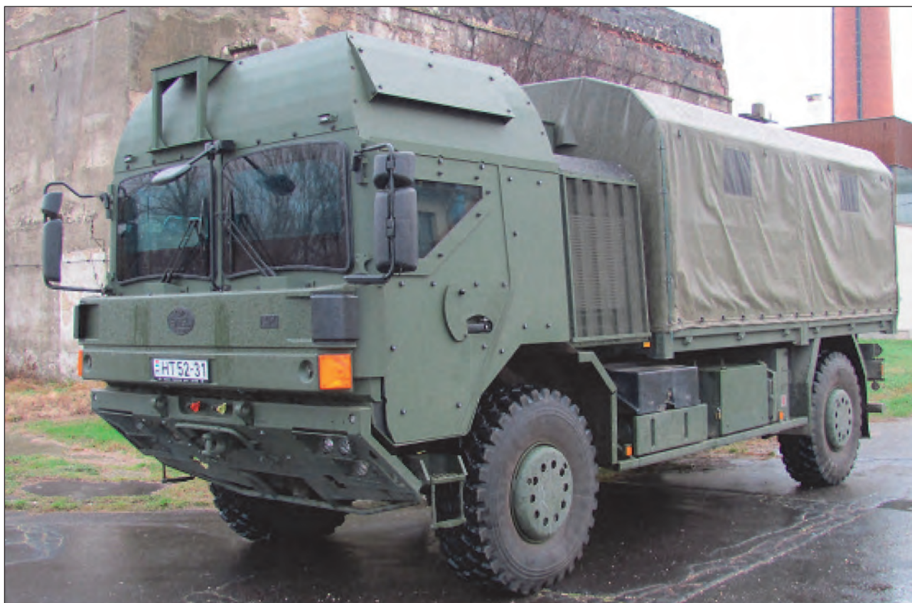
3. ábra. A H14.240 AEL-103 teher- vagy személyszállító jármű páncélos vezetőfülkével, felszerelt fegyverállvánnyal és vészfutógyűrűvel (Run-flat) szerelt kerekkel
