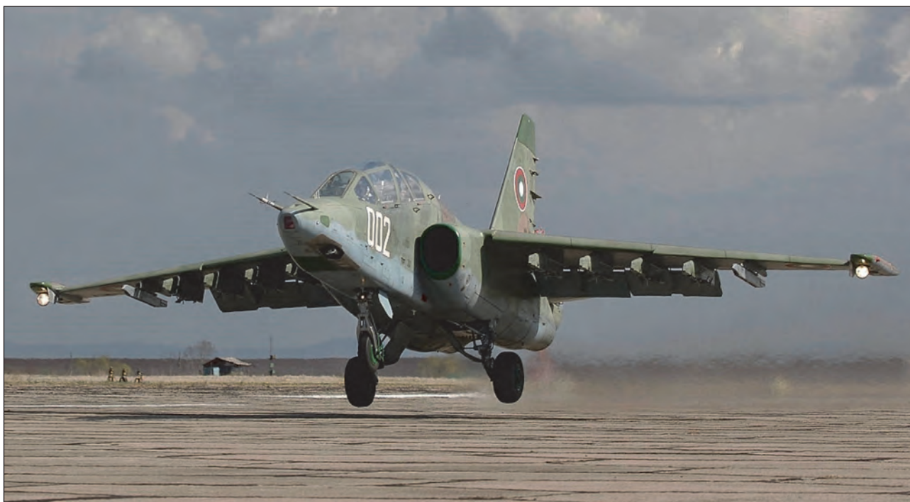
8. ábra. A szárnyak alatt kialakított 10 függesztési ponton nagy mennyiségű támogató fegyverzet helyezhető el
