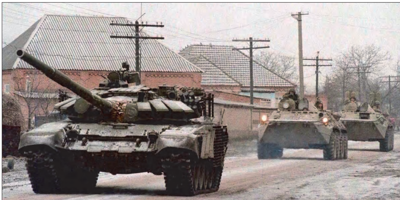
16. ábra. T-72BM harckocsi kiegészítő védőrácsokkal a torony hátsó részén, mögötte BTR-80-as páncélozott harcjármű
