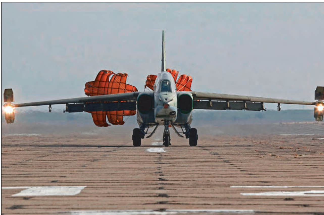
2. ábra. Leszálló Szu-25-ös csatarepülőgép fékernyővel és kitérített fékszárnyakkal. A kiterjedt páncélzat miatt nagy tömegű repülőgép fékezésénél hasznos kiegészítő eszköz a két ejtőernyő. A szárnyvégeken két további terpesztett féklap látható
