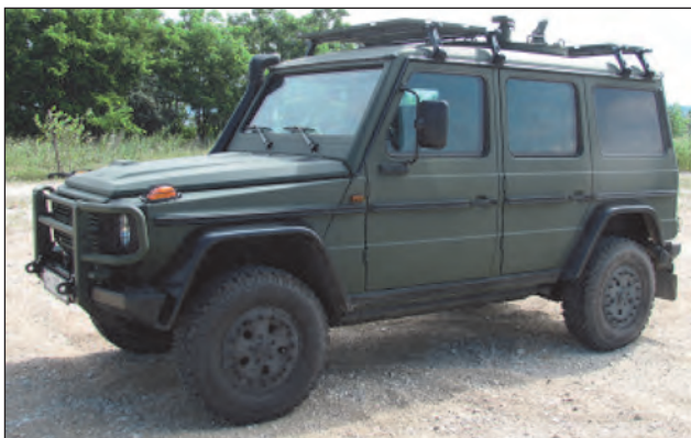
9. ábra. A páncélozott utasterű MB G300 CDI, kétrészes tetőcsomagtartóval. A forgógyűrű nem került továbbépítésre
