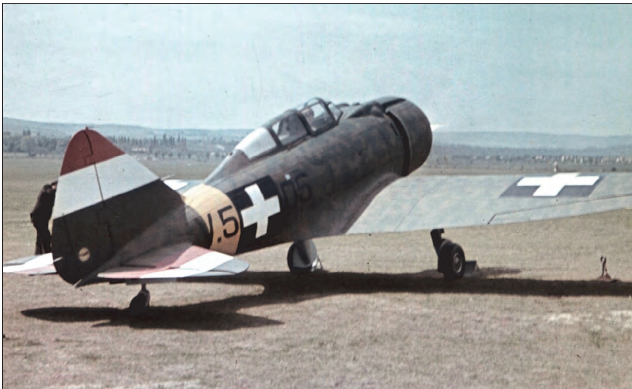
52. ábra. A homoksárga alapon sötétzöld foltos álcázási mintában pompázó V.505-ös jelű MÁVAG-Héja (gyári szám H-035) színes fotója jól mutatja a Krayér által gyártott és a MÁVAG-nak (is) szállított H.1795 jelű sárga, illetve a G.1103 jelű zöld terepszínű festékek árnyalatát
