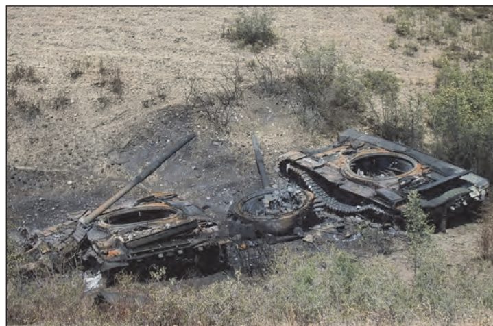
28. ábra. A groznij térségében vívott harcok során valószínűleg belső löszzerrobbanás által megsemmisült T–72-es harckocsik
