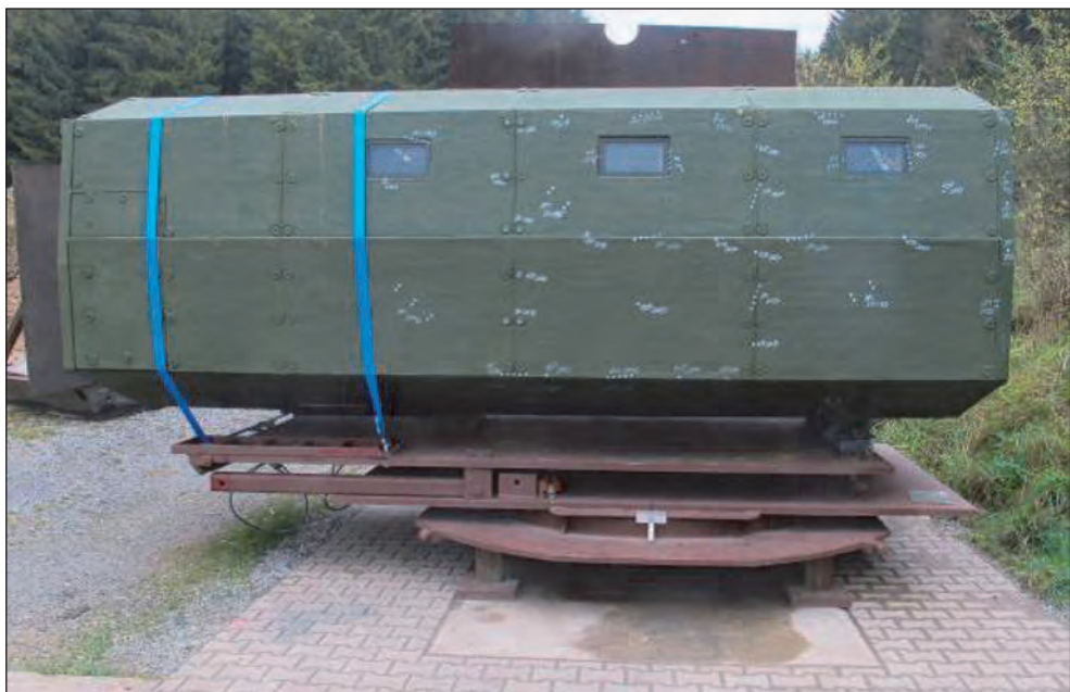
51. ábra. A VZF az IABG lövizsgálati elrendezésében, a menetirány szerinti bal oldal vizsgálatához előkészítve
