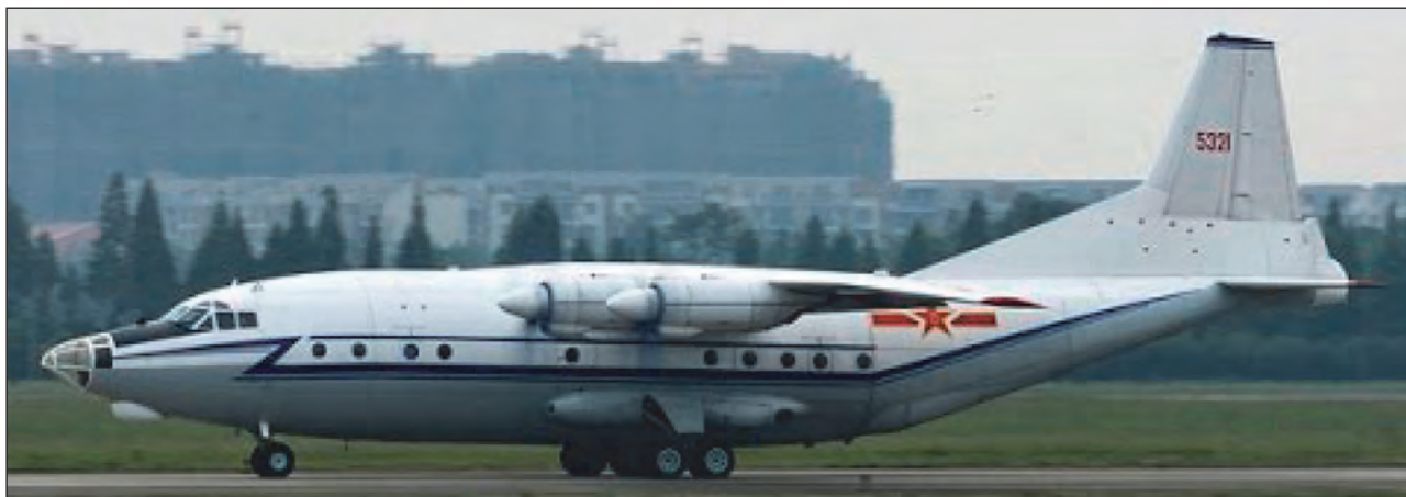
5. ábra. Az Y-8-as szállító repülőgép az Antonov An-12-es kínai változata. A képen a repülőgép oldalablakos változata látható
