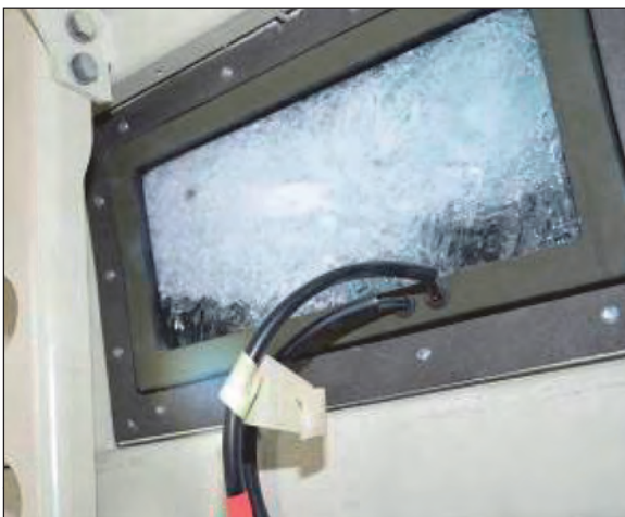
57. ábra. Lövések nyoma belül, az előző oldalablakon. (Áthatalás, leválás nem volt!)
