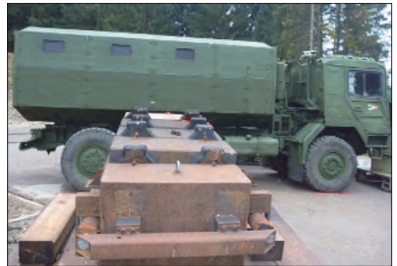
68/a,b. ábra. A VZF és az IED-vizsgáló szerkezet beállítása a robbantáshoz. Az IED-vizsgálatot a VZF – eddig érintetlen – menetirány szerinti jobb oldalán hajtottuk végre. (A VZF bal oldala [teljes vetületében], a homlokfala, a hátfala, a teteje a sikeres ballisztikai vizsgálatok után)
