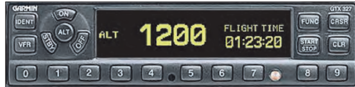
29. ábra. A Heronhoz használt Garmin típusú IFF készülék 24
