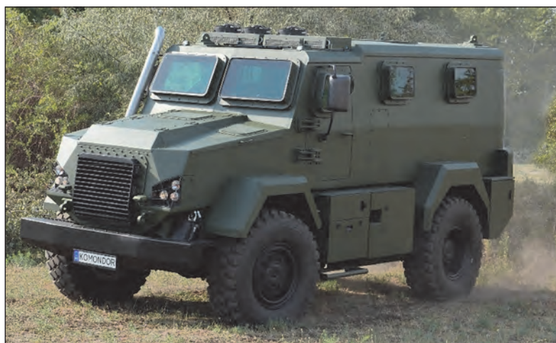
4. ábra. Az RDO-3221 Komondor páncélozott jármű a járműcsalád eddig elkészült változatai közül a legalacsonyabb szerkezeti tömegű, legkisebb tengelytávú változat
