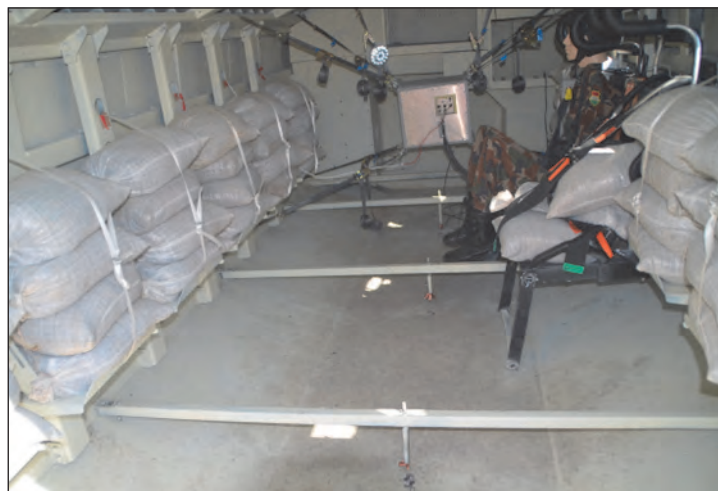
43. ábra. A VZF belső terének egy részlete (a Samu és a homokzsák műteherrel ellátott ülések, illetve ülés helyek) az első 6 kg-os akna robbantása után. A Samu mellkasán jól látszik az egyik mérőcella. A Samu bal oldalán a benyomódásjelzők vannak
