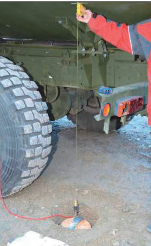
62. ábra. Az akna telepítése közben, elhelyezés a bal oldali utolsó ülés alatt
