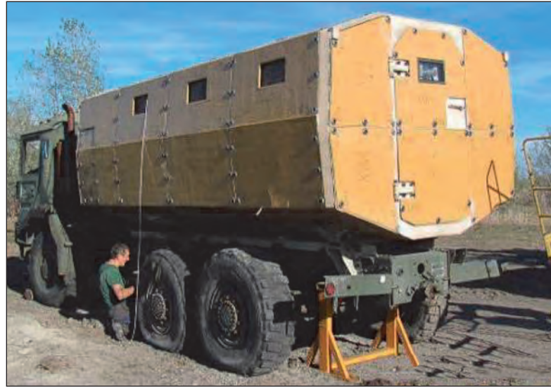
45. ábra. A negyedik robbantás előkészítése, a második 6 kg-os akna telepítése. Az eredeti magasság beállításához – a defektes kerekek miatt – az alvázat alá kellett támasztani
