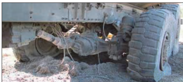
42. ábra. A VZF kísérleti járműve az első 6 kg-os akna robbantása után
