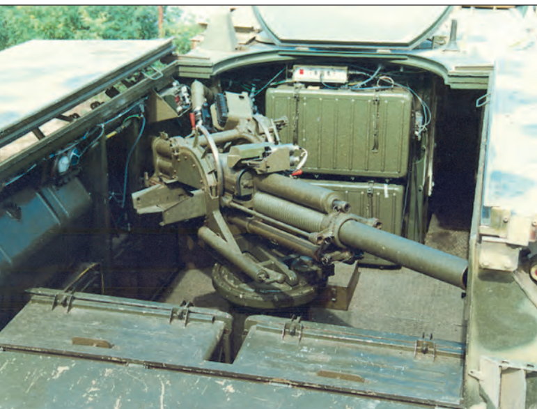
4. ábra. Az automata aknavető elhelyezkedése szállítási helyzetben, a küzdőtérben
