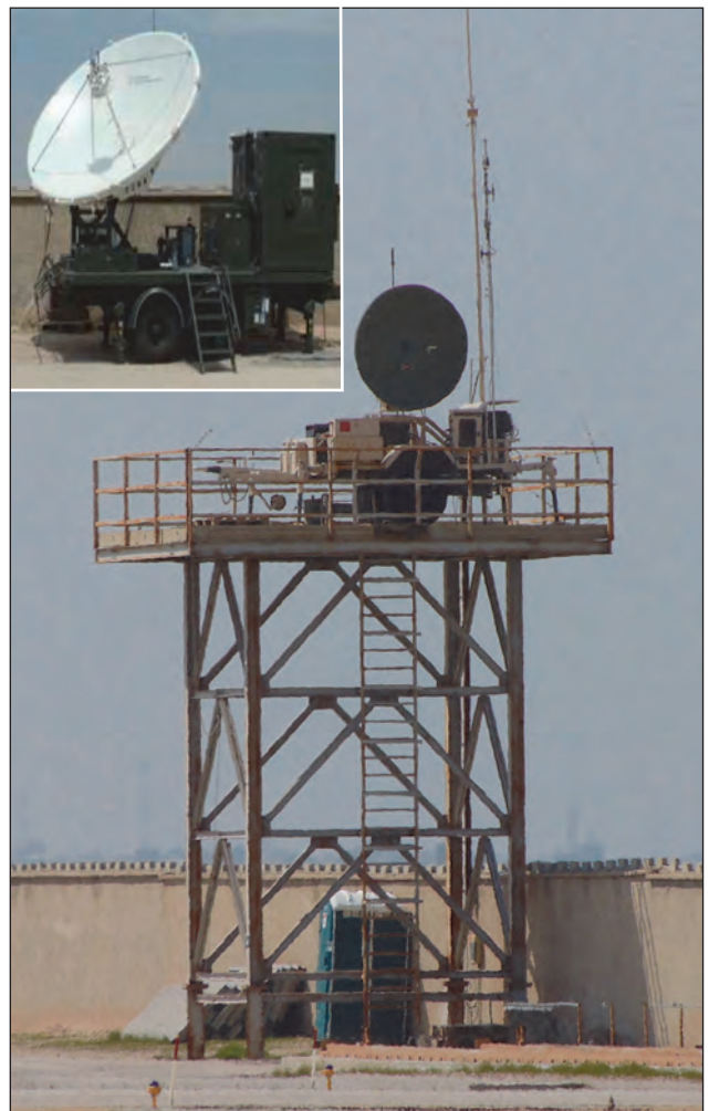
27. ábra. A Heron-1 LoS (GDT), illetve SATCOM (GST) vezérléshez használható antennája a mazar-e sharifi repülőtéren
