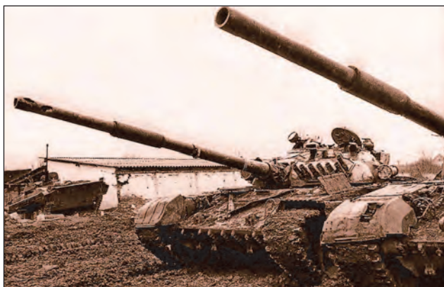
29. ábra. Javításra visszavont, sérült T-72-es harckocsik egy tábori javítópontra. A bal oldali jármű csövét átlőtték. A háttérben egy BMP-2-es páncélozott gyalogsági harcjármű látható
