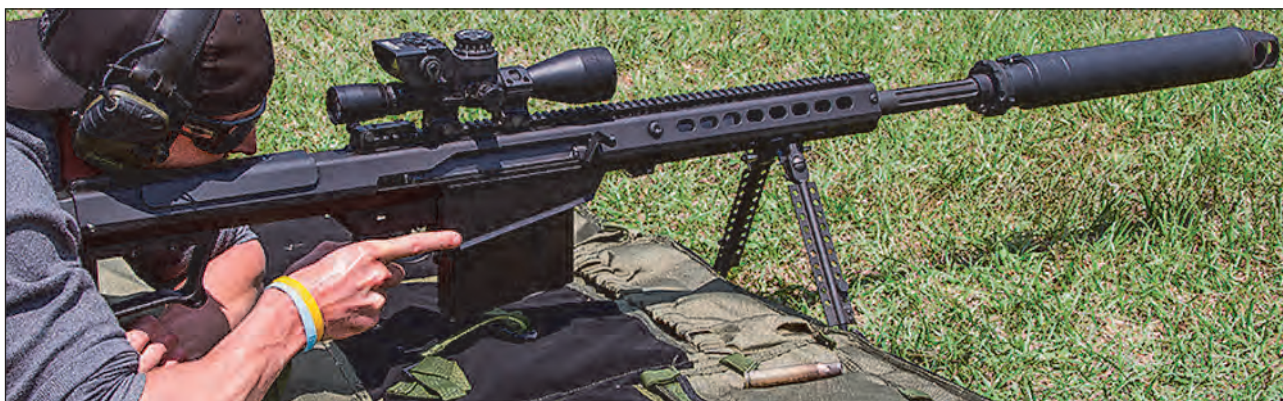
12. ábra. Barrett távcsöves öntöltő puska QDL hangtompítóval 21
