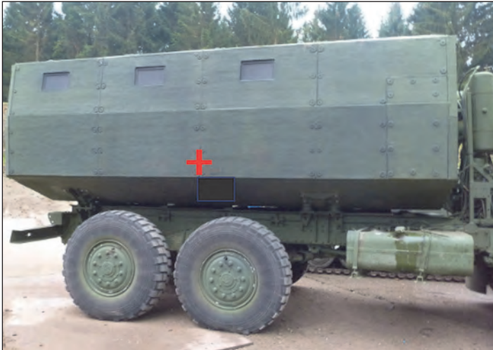
66. ábra. A VZF IED-vizsgálat felőli oldala. Keresztjelölve az imitációs vizsgálatöltet „hatásvonalának középpontja”. Kívül panel osztásvonal, belül ülésközép
