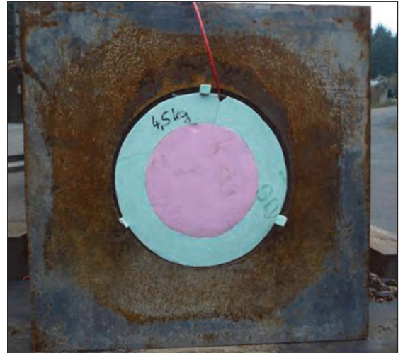
67. ábra. Az 50 kg TNT ekvivalens töltet, acél fészekben, előkészítve az IED-robbantáshoz
