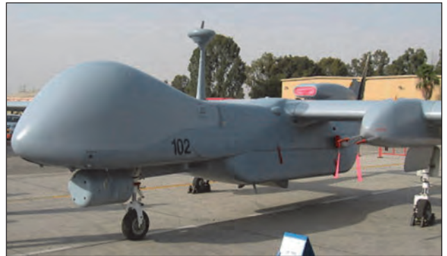
24. ábra. A Heron (Eitan) SIGINT konténer az orr alatt 18
