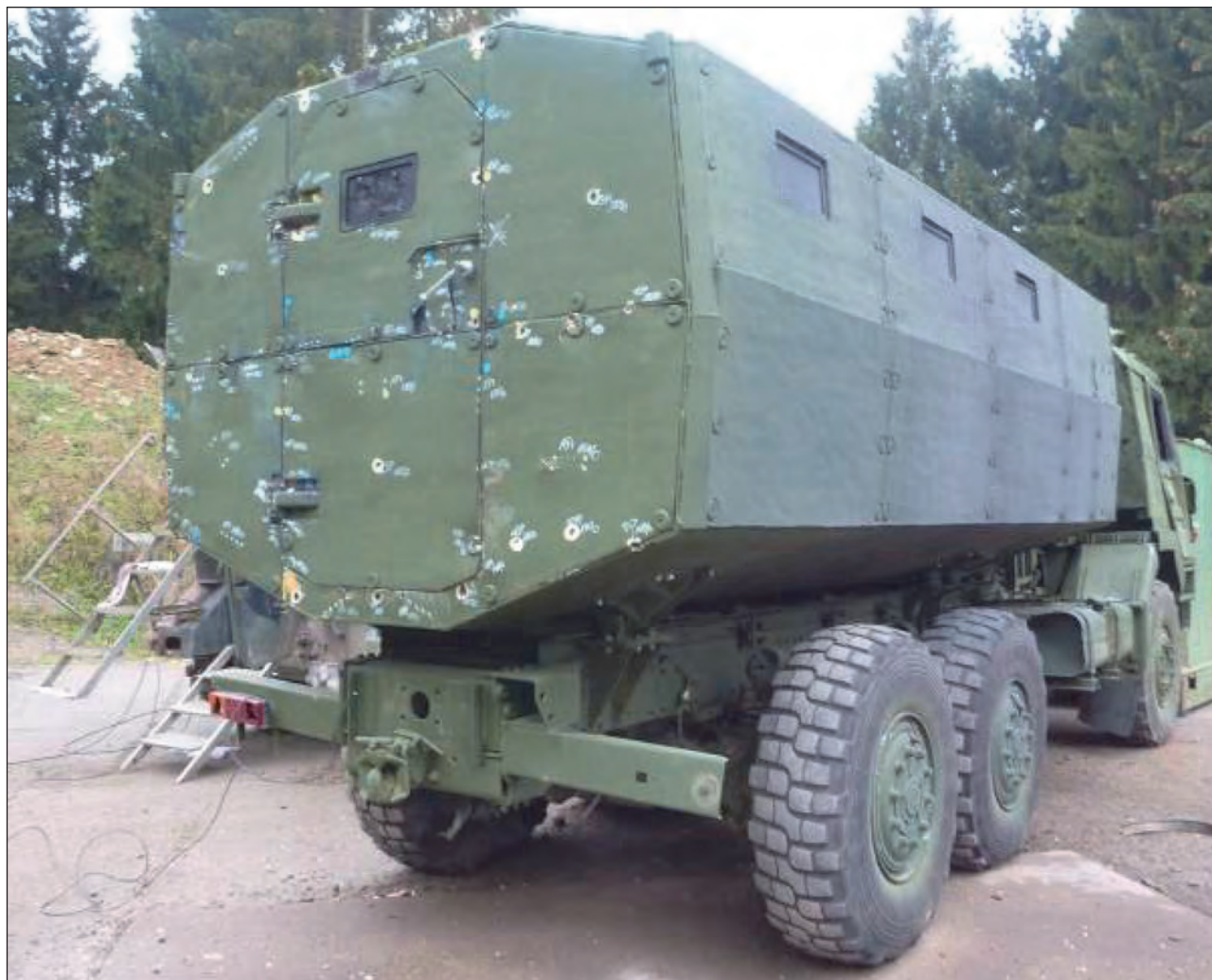
59. ábra. A ballisztikai vizsgálatokon és az IED-robbantáson már megfelelt VZF (és kísérleti járműve) beállítása a 6 kg-os akna telepítéséhez. (A VZF menetirány szerinti jobb oldala felől történt az IED robbantás végrehajtása)
