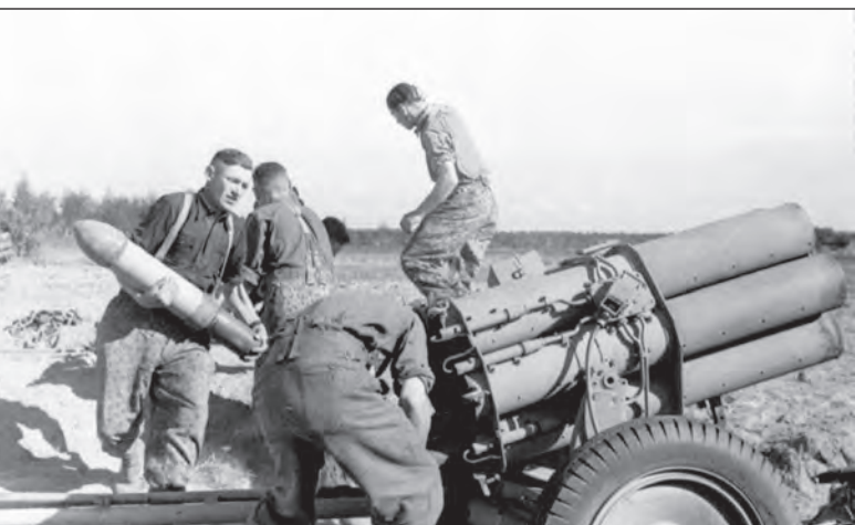
26. ábra. 15 cm-es Nebelwerfer 41-es hatcsövű rakétaindító
