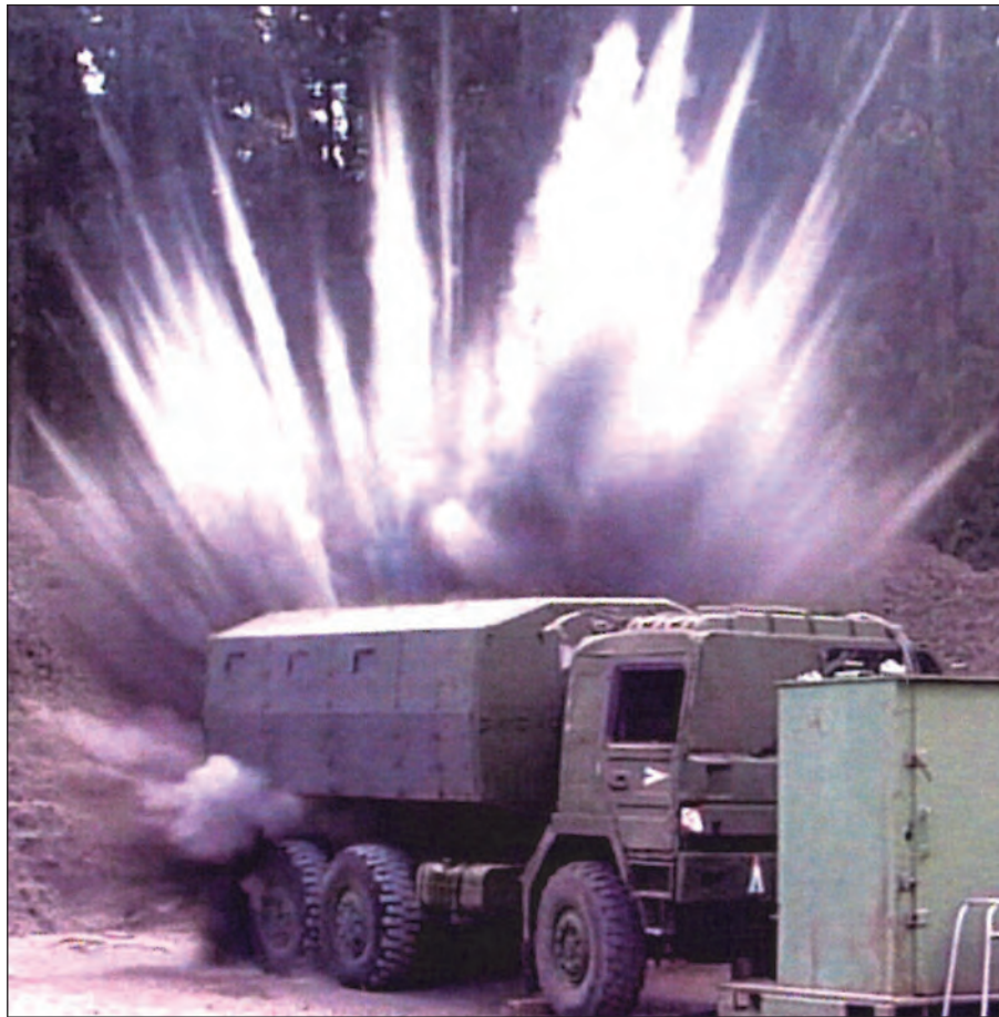
63. ábra. A VZF aknavédelmi megfelelőségének vizsgálata az IABG 33 -nél, Lichtenauban. A vizsgálatot (6 kg TNT) a VZF bal oldali ülésor utolsó ülés közepe alatt. Az első felvétel a robbantásról
