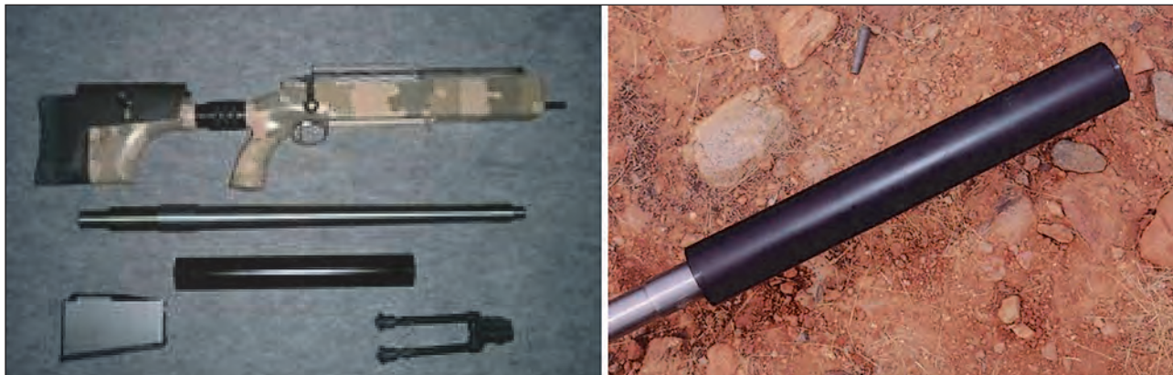
11. ábra. Az Arm's Tech Ltd. MD-50B hangtompítója a szétszedhető TTR-50-es puskán 20
