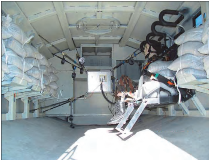
44. ábra. A VZF belső terének előkészítése a második 6 kg-os aknarobbantáshoz (ami azonban már a negyedik robbantás volt!)
