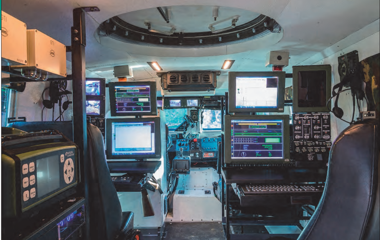
5. ábra. Az ABV-felderítő változat az RDO-3221-es Komondor páncélozott harcjármű bázisán került kialakításra
