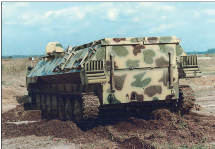
2. ábra. Az MTLB-U alváz as önjáró aknavető, zárt küzdőtérrel
