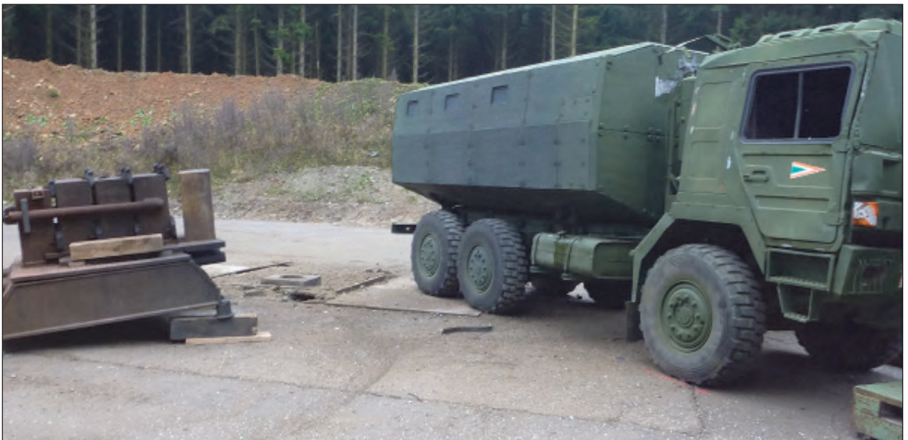
69. ábra. Az IED robbantása után, sérülés, repedés, áthatolás nincs a VZF-en (belső másodlagos repeszképződés, illetve sérülés sem volt)
