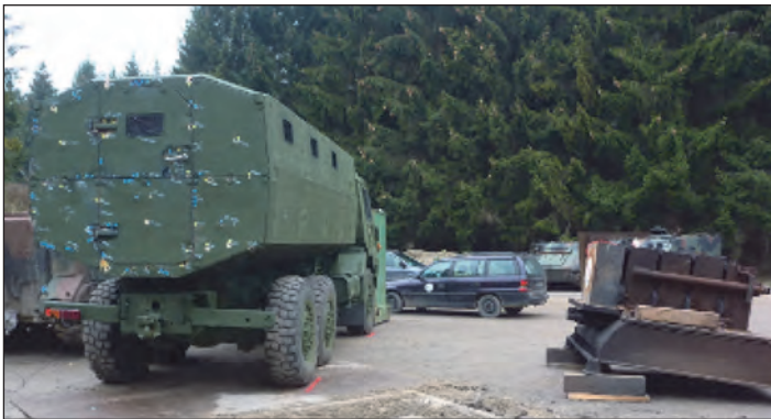
68/a,b. ábra. A VZF és az IED-vizsgáló szerkezet beállítása a robbantáshoz. Az IED-vizsgálatot a VZF – eddig érintetlen – menetirány szerinti jobb oldalán hajtottuk végre. (A VZF bal oldala [teljes vetületében], a homlokfala, a hátfala, a teteje a sikeres ballisztikai vizsgálatok után)
