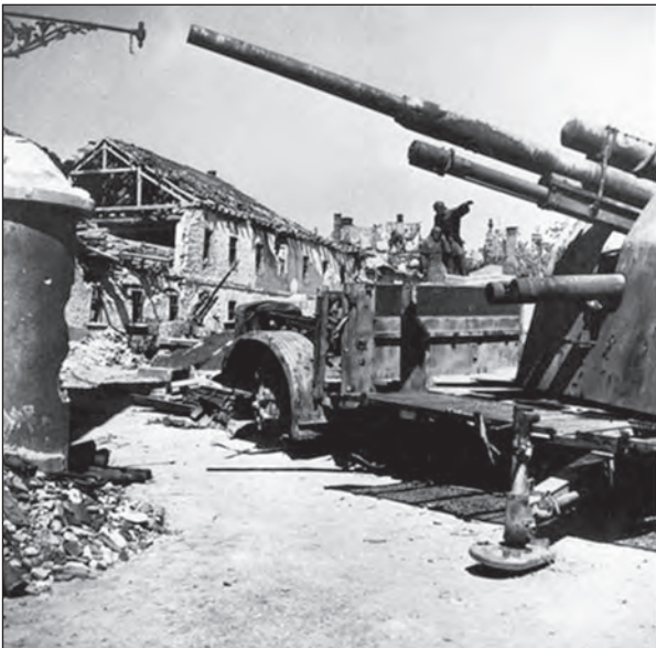
7–8. ábra. Háromtengelyes VOMAG autóbusz alvázra szerelt 88 mm-es légvédelmi ágyú a Budai Vár keleti oldalán, a mai Hilton szállónál
