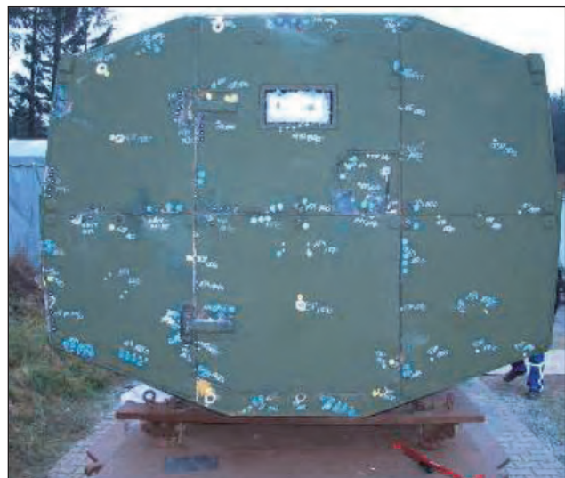
53. ábra. A hátfal vizsgálata közben, az FSP lövések egy része már végrehajtva
