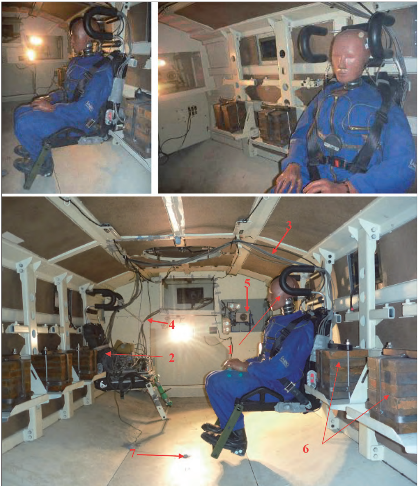
65/a,b,c. ábra. A belső tér előkészítve az IED hatásvizsgálatához: 1. Hibrid III ATD mérőbábu, 2. Belső adatgyűjtő 3. Kábelköteg a belső adatgyűjtőhöz 4. Kábelköteg kivezetés a külső adatgyűjtőhöz, ill. az adatfeldolgozó rendszerhez 5. Kamera, 6. Műteher az össztömeg biztosításához (az ülések helyén). 7. Az egyik gyorsulásmérő előkészített helye. A felsoroltakon kívül a mérőbábu rendelkezik erőmérőkkel, nyomásmérőkkel, gyorsulásmérőkkel, valamint a felépítmény több pontján is vannak különböző jeladók (lásd pl.: a 7. tételt)
