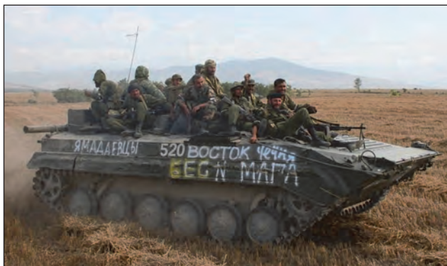
2. ábra. Szovjet BMP-1-es gyalogsági páncélozott harcjármű. A lövészedesant a harcjárművön utazik
