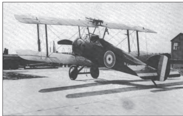
11. ábra. Az egyébként szárazföldi vadász feladatokra alkalmazott Sopwith Camel volt az első hordozófedélzeti harci repülőgép. A gép felső szárnyának közép részén megfigyelhető a géppuska
