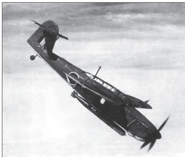
7. ábra. A Fairey Barracudát már 1937-től gyártották, de a Swordfish-eket csak 1943-tól kezdték el leváltani ezekkel a korszerűbb gépekkel. Szintén torpedóvető feladatra volt tervezve. A szárny felett kétoldalt látható a fedélzeti radar antennája, amely a hajók felderítésében nyújtott segítséget
