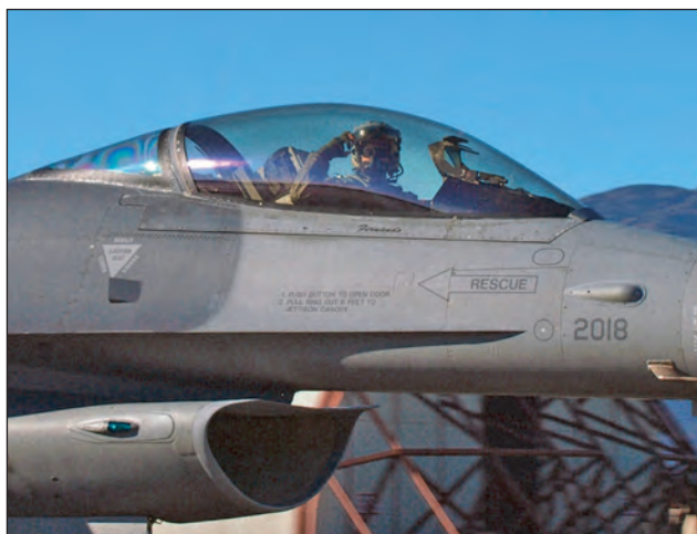
5. ábra. A Buzzards (Egerészölyv) század pilótájának lecsapó ölyvet szimbolizáló köszönése. Jól látható a szabályozás nélküli, törzs alatti szívócsatorna
