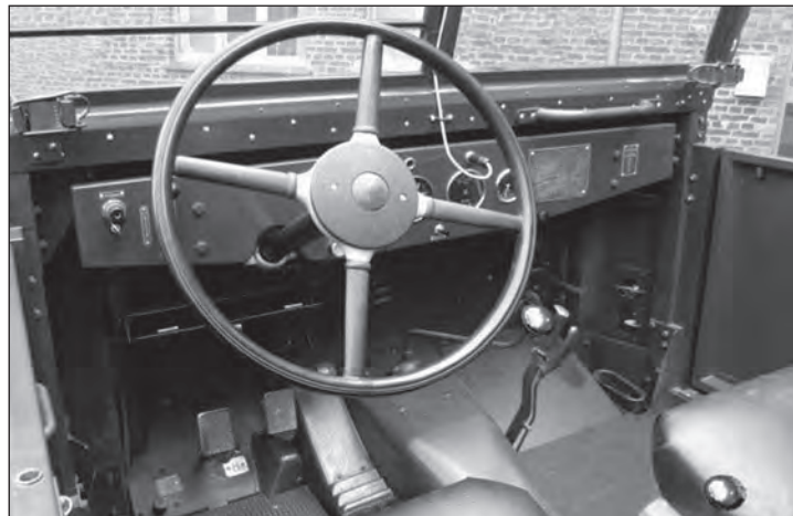
5. ábra. A gépkocsi kezelőszervei. Érdekes a gázpedál három eltérő cipőmérethez is kényelmessé tett lábtámasza
