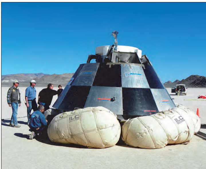
5. ábra. 2012-ben, Delamarban végrehajtott ejtési kísérlet a CST-100-as űrhajó modelljével, a légszakok kipróbálása céljából
