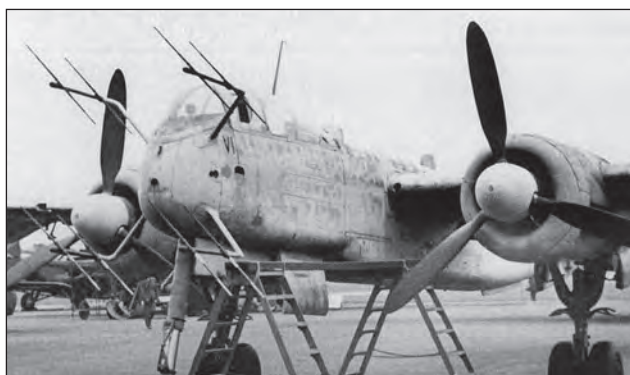
9. ábra. A fedélzeti lokátor-antennák a fülke orr-résznén
