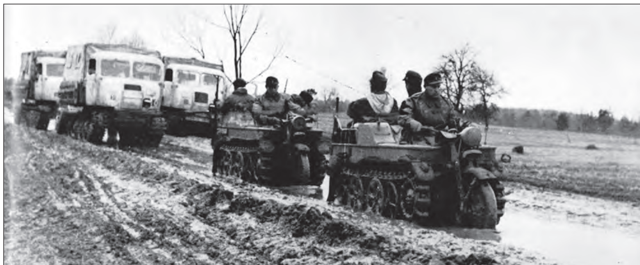
11. ábra. A teljesen lánctalpas, apró RSO tüzérségi vontatót (Raupenschlepper Ost – a háttérben) a keleti front mostoha útviszonyai hívták életre. Olyan könnyű tüzérségi eszközök vontatására szánták, mint a 7,5 cm Pak 40. RSO/Pak 40 néven fegyverhordozóként is épült (A karosszériák egy jelentős részét az Uhry-testvérek cége állította elő a gyártó részére – Szerk.)
