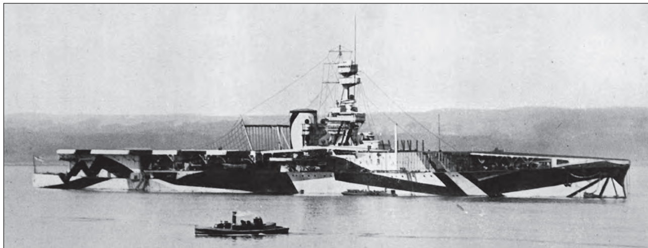
2. ábra. A FURIOUS 1918-ban, a második átépítés után, immár külön fel- és leszálló fedélzettel
