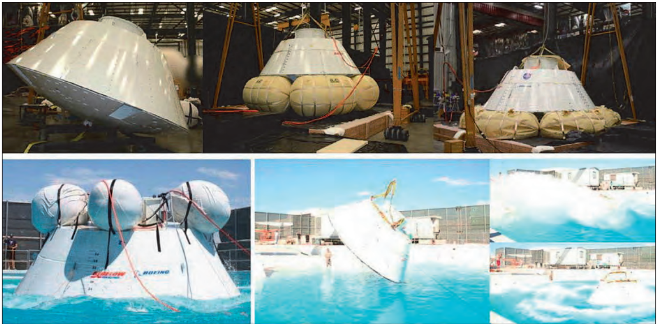
4. ábra. Felül: ejtési kísérletek szilárd talajra; alul: vízreszállás szimulálása különböző érkezési szögben
