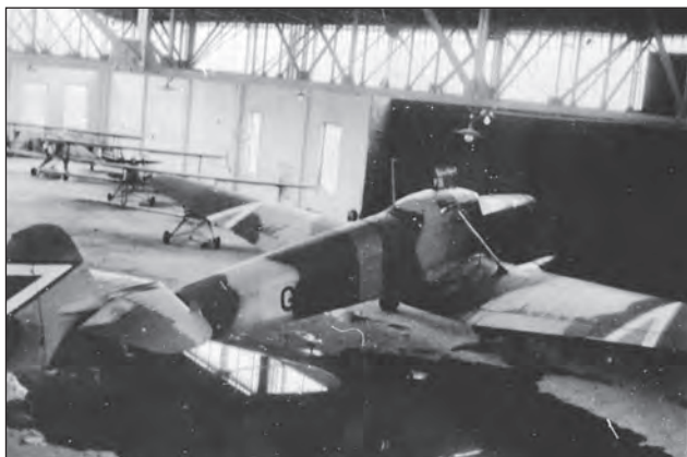
33. ábra. A bizonyítottan RLM 02-vel gyárilag festett győri MWG gyártású Focke-Wulf 58K-t (G.250) csapatszolgálat során kiegészítették sötétzöld (G.1103) és sötétbarna (G.1102) Krayér álcázószínekkel. A régi lajstromjelet Krayér szürkével (G.1100) átfestették. Az eredeti RLM 02 és a Krayér G.1100 közötti árnyalatkülönbség ezúttal is jól látható (lásd a G betű alatt és körül)
