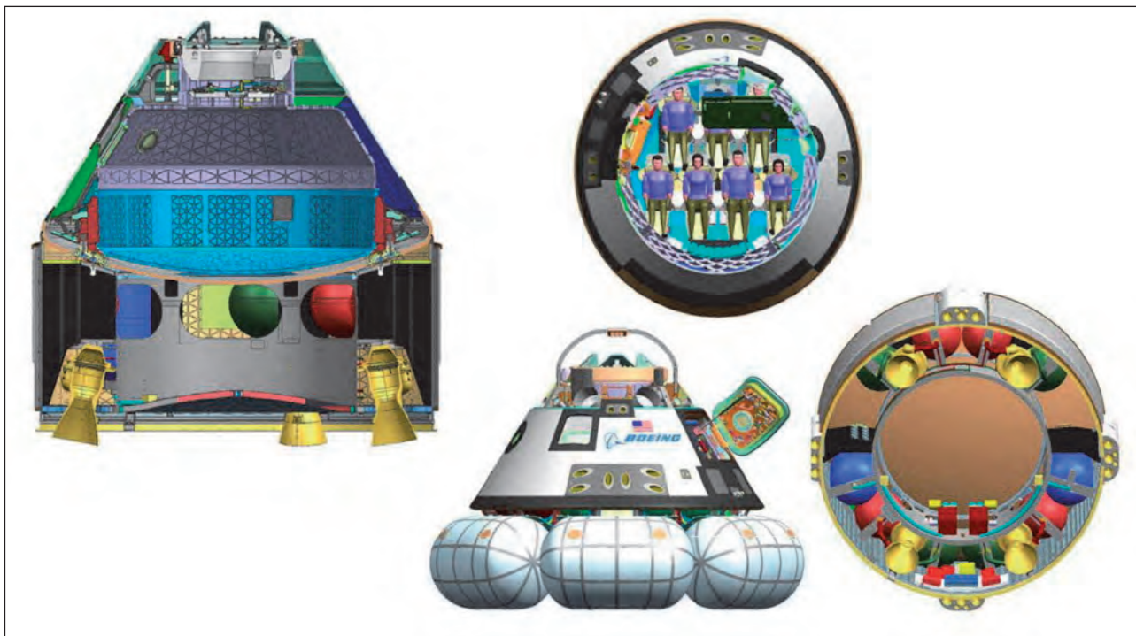
3. ábra. A CST-100-as űrhajó különböző típusú grafikai ábrázolásai. (Keresztmetszet; a légénységi kabin felülnézetben; az űrhajó oldalnézetben – a légzsákokkal és a nyitott beszállóajtóval; a műszaki egység szerkezeti rajza)
