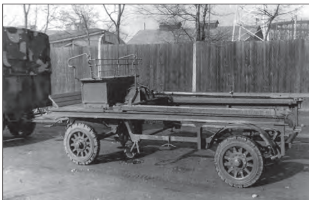
8. ábra. A kamraszállító pótkocsi eredetileg két lóval fogatolt eszköz volt, de Rába Botond katonai tehergépkocsival is vontathatták
