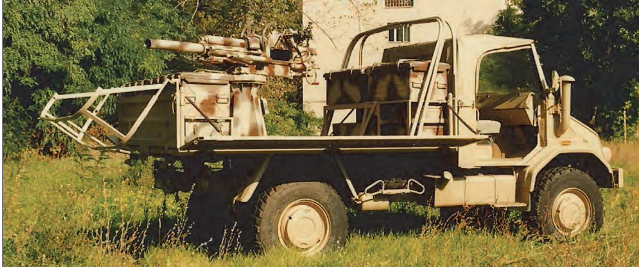
1. ábra. Vizsgálati próbán a HTI által fejlesztett önjáró automata aknavető
