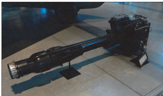
10. ábra. A Me 163-as vadászpülógép rakétahajtómúve
