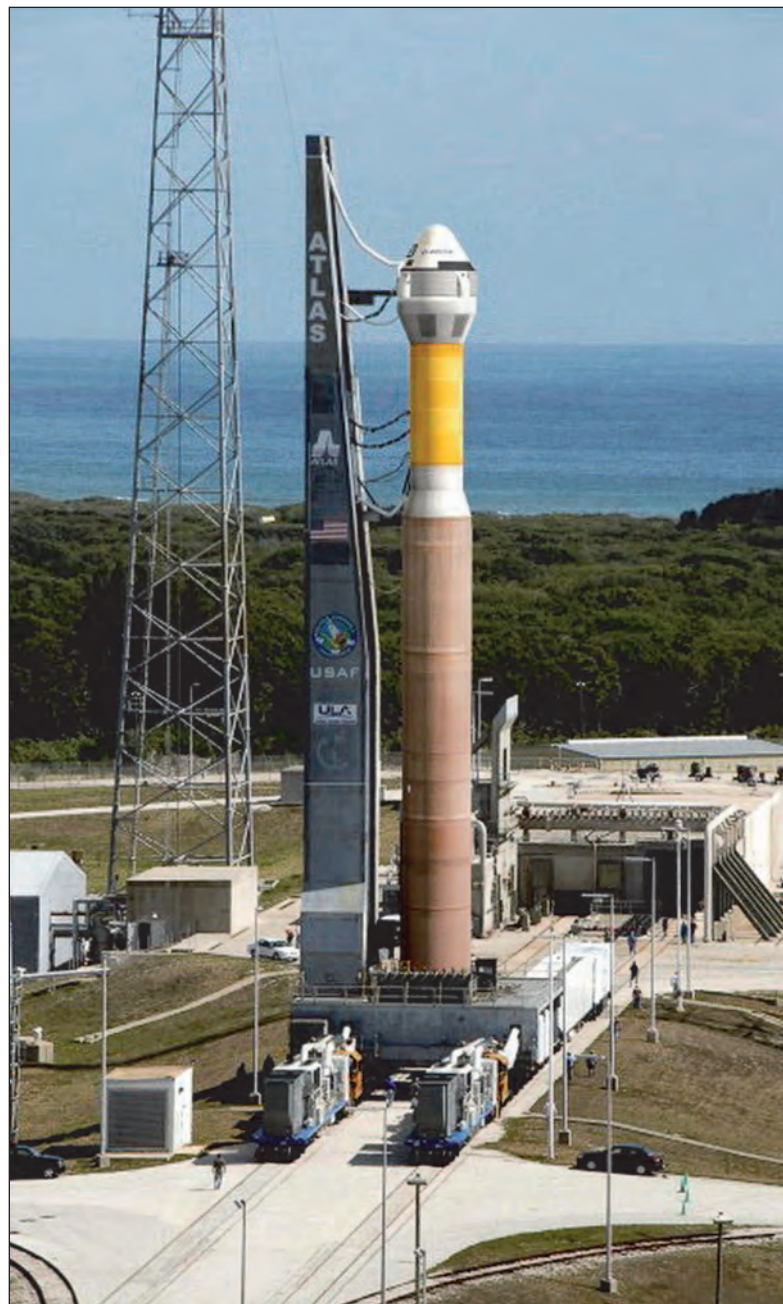
6. ábra. A CST-100-as űrhajó az Atlas V hordozórakéta csúcán. Jól megfigyelhető közvetlenül az űrhajó alatt az adapter, valamint a Centaur -fokozat (citromsárga)
