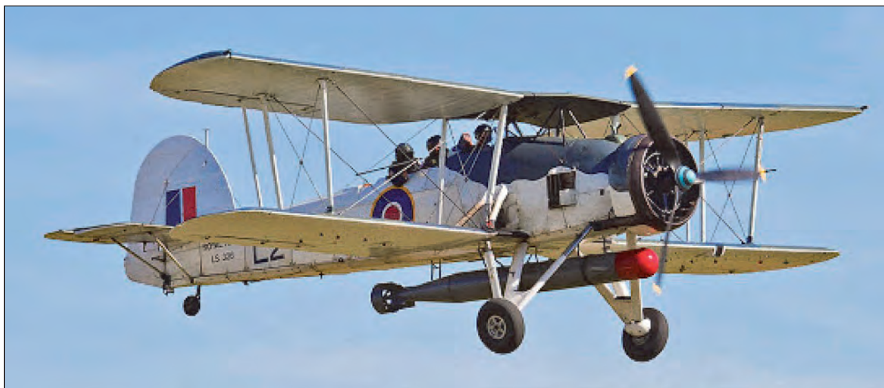
4. ábra. A vászonborítású, kétfedelű Fairey Swordfish torpedóvető repülőgép 224 km/h sebességével már a háború kezdetén sem számított korszerűnek, mégis olyan fegyvertény fűződik a nevéhez, mint a BISMARCK német csatahajó elsüllyesztésében való részvétel 1941-ben. A gép előnye a kis fel- és leszállósebesség volt. (A fotón felújított példány látható)
