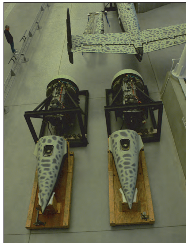
7. ábra. A gép két motorja (még a szállítási csomagolásban), illetve a motorgondola hátsó áramvonalazó burkolata
