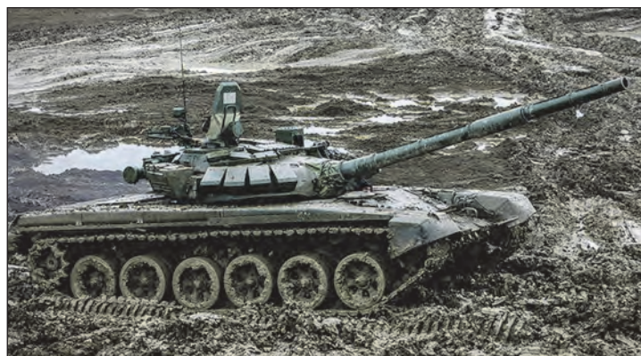
12. ábra. Szovjet T-72-es harckocsi reaktív páncélzattal a tornyon
