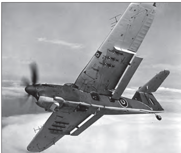
7. ábra. A Fairey Barracudát már 1937-től gyártották, de a Swordfish-eket csak 1943-tól kezdték el leváltani ezekkel a korszerűbb gépekkel. Szintén torpedóvető feladatra volt tervezve. A szárny felett kétoldalt látható a fedélzeti radar antennája, amely a hajók felderítésében nyújtott segítséget
