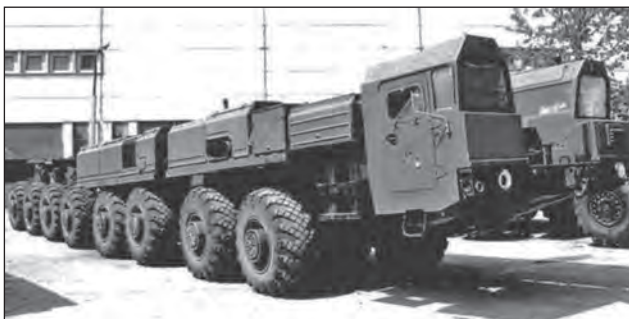
65. ábra. MAZ-7923 Bizon villamos erőátvitelű önjáró alváz (1992)
