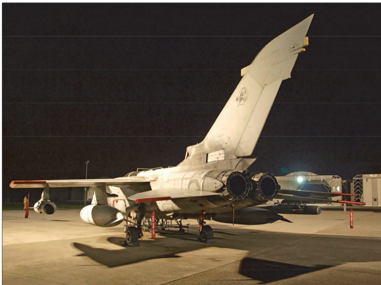
34. ábra. A képen jól láthatóak a Tornado két gázturbinás hajtóművének változtatható keresztmetszetű gázsebesség-fokozó redőnyei
