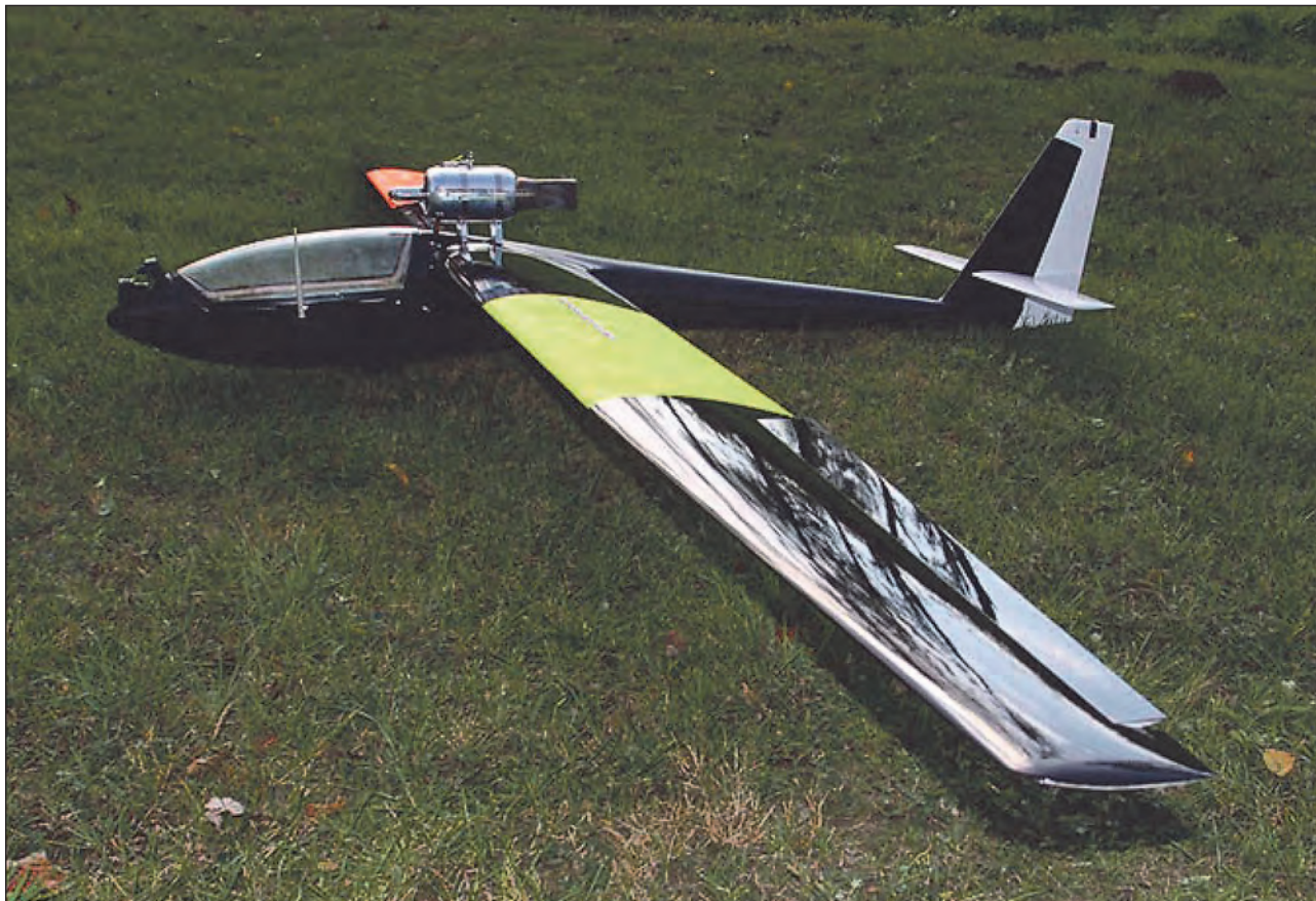
13. ábra. A gázturbina nemcsak a célrepülőgép nagy sebességét biztosítja, de kellőképpen intenzív hőképet is ad az éleslövészetek során
