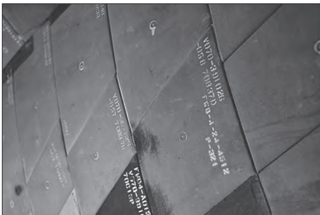
13. ábra. Számozott hővédő téglák az űrrepülőgép alján
