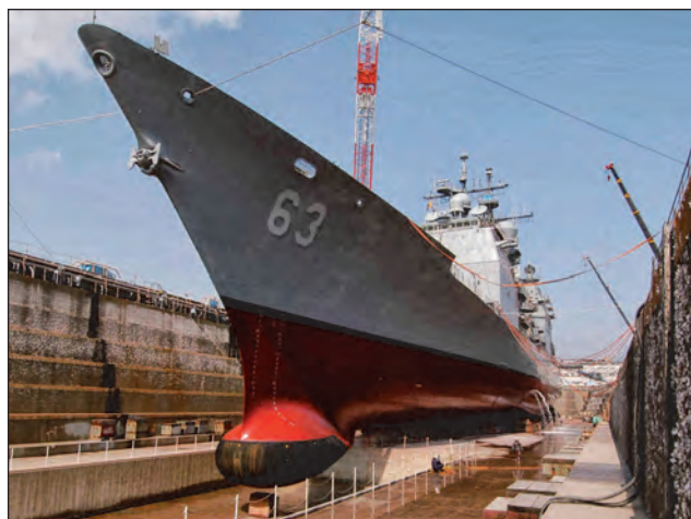
26. ábra. A USS COWPENS (CG 63) a yokosukai (Japán) szárazdokkban. Jól megfigyelhető az AN/SQS-53-as szonár dómja, a fekete színű burkolat nem fémből, hanem gumiból készült
