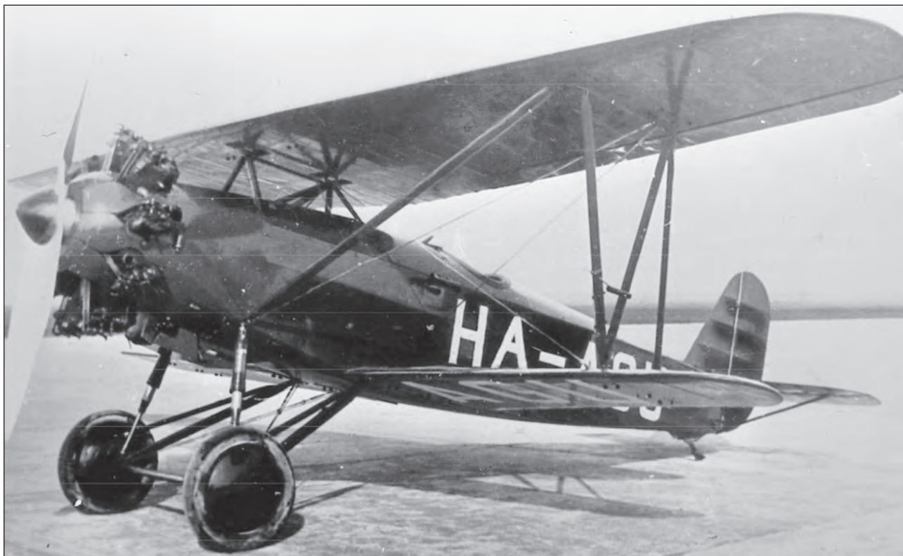
12. ábra. A világháborúk közötti időszak első, hadiszíneket viselő, magyar szolgálatban álló repülőgépe az 1930/1931-ben érkezett Fokker D.XVI „sportgép” (valójában vadászgép) volt. Az úgynevezett „Fokker khaki” színben érkezett repülőgépeken csak a holland PH polgári lajstromjelet festették át a magyar HA-ra
