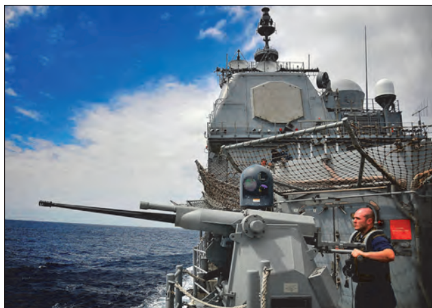
30. ábra. A kis csónakkal végrehajtott támadások elleni védelem fontos eszköze a távvezérelhető, 25 mm-es Mark 38 Mod 2-es stabilizált géppuska
