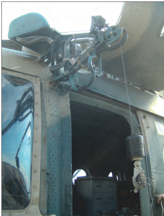
6. ábra. A Mi-17 LPG-150 típusú fedélzeti csörlője alkalmazási (kihajtott) pozícióban. Teherbírása 150 kilogramm
