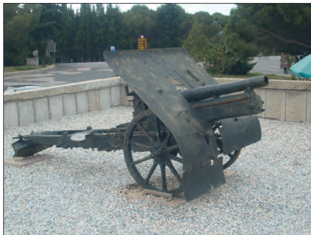
2. ábra. Francia 6,5 cm-es hegyi ágyú, a Tulle-i Ágyúgyár terméke 1917-ből, a lövegpajzs hiányos
