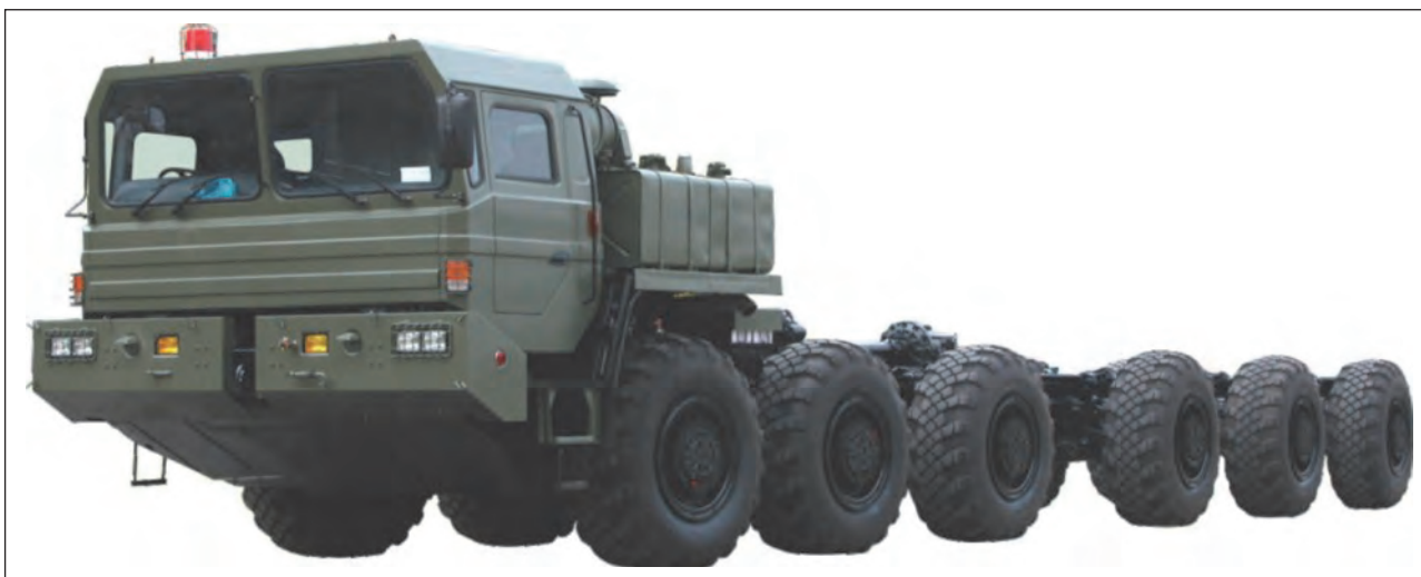
69. ábra. WS-2900-as 12 × 10 kerékképletű alváz 40 t terhelésre
