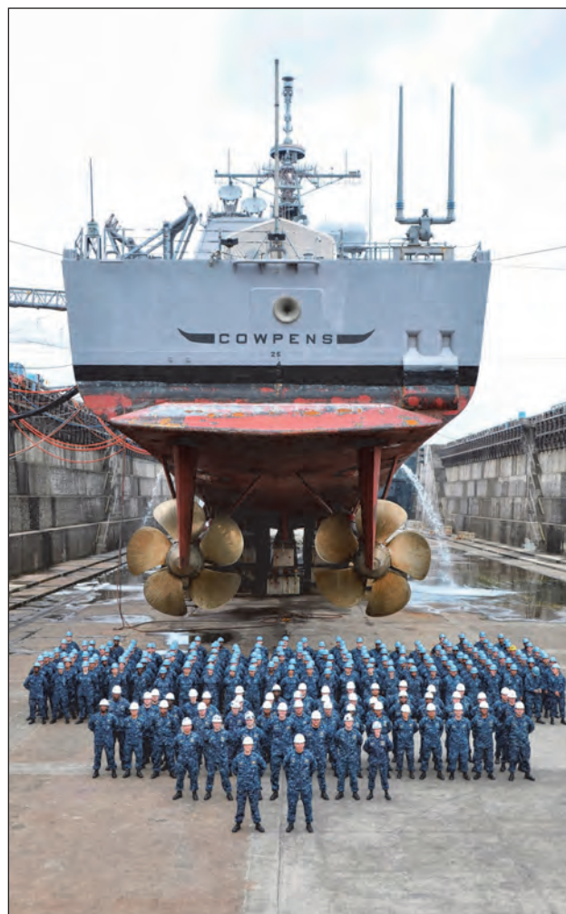
27. ábra. A USS COWPENS (CG 63) és legénysége. A tat közepén látható nyíláson át eresztik le a vontatott szonárt, tőle jobbra pedig a Nixie torpedózavaró csalikát
