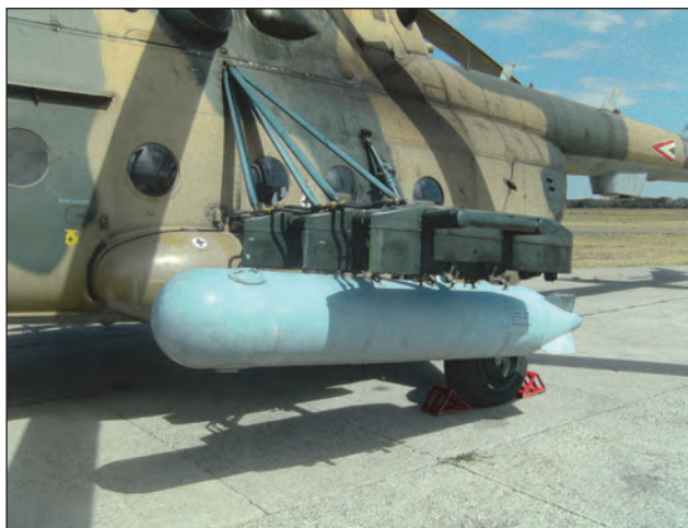
4. ábra. A Mi-17N változat 475 literes póttartálya úgy növeli a hatósugarát, hogy közben nem foglal el értékes helyet a tehertérben
