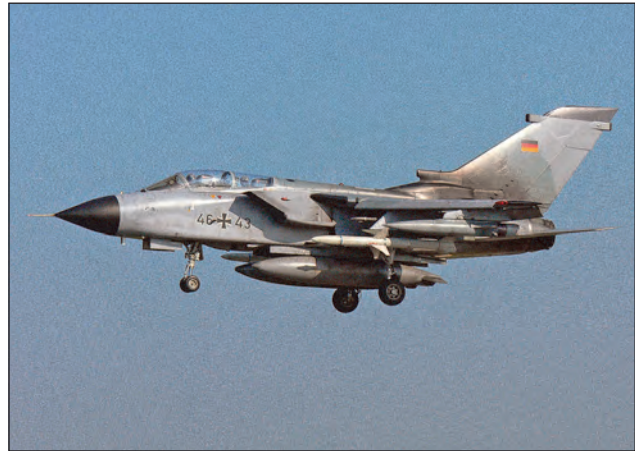
7. ábra. A német légierő egyik Tornado harci repülőgépe a szárny alatti tartókon rakétafegyverzettel, a törzs alatt két nagyméretű póttartállyal a levegőben
