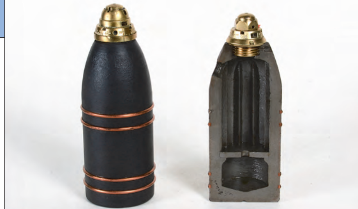
5. ábra. Uchatius-féle ágyúhoz rendszeresített lőszer metszete (HM HIM)
