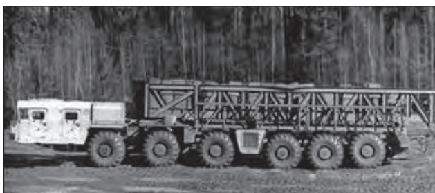
41. ábra. MAZ-7916-os alváz üzemi próbán (1979)
