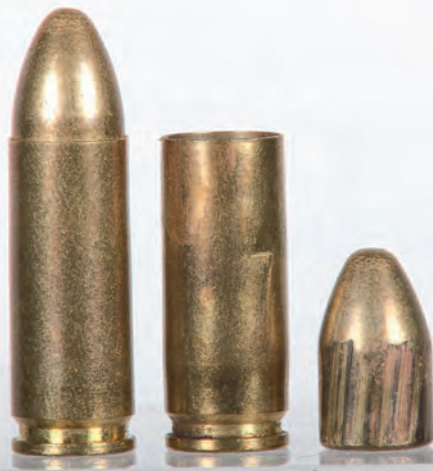
5. ábra. A PKLV szakemberei által készített 9 × 25 mm-es kísérleti pisztolytöltény hüvellyel és a kilőtt lövedékkel
