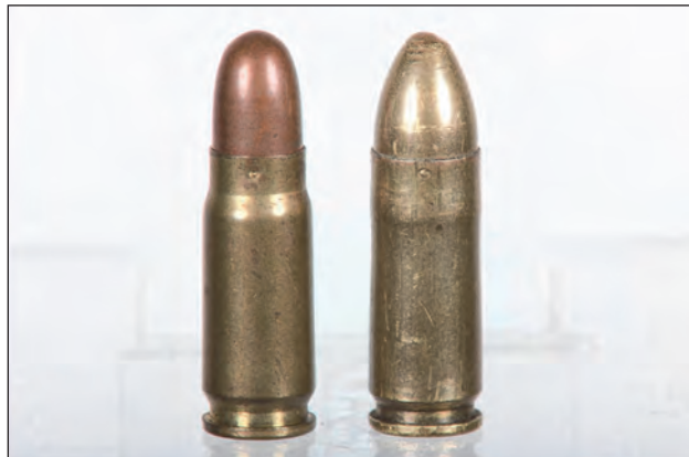
4. ábra. 1933M 7,62 × 25 mm-es TT pisztolytöltény és a belőle készült kísérleti Mauser Export pisztolytöltény
