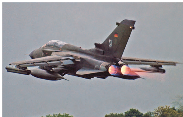
10. ábra. Utánégetőt kapcsol a német légierő egyik Tornado harci repülőgépe, amelynek szárny alatti tartóira egy-egy póttartályt függesztettek
