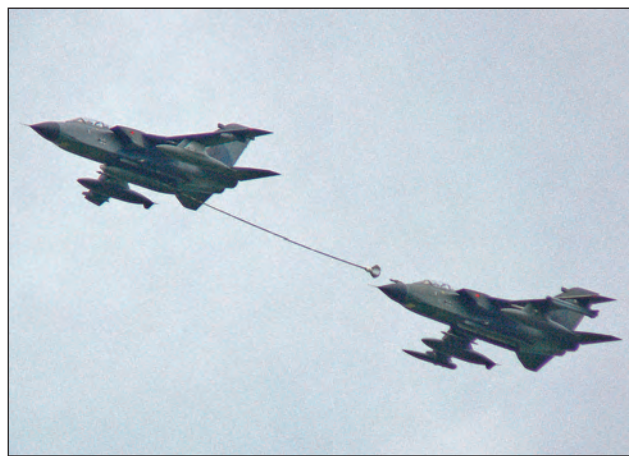
4. ábra. Német Tornado géppár a légi utántöltés gyakoroltása közben
