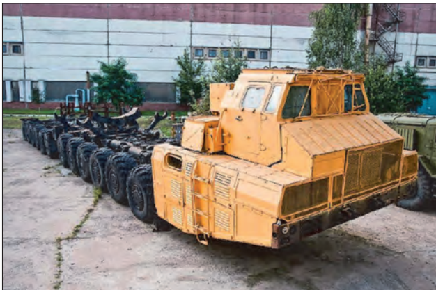
39. ábra. MAZ–7907-es, kísérleti 24 kerekes rakétaszállító-indító alváz (1985)
