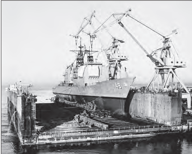
5. ábra. A USS YORKTOWN (CG 48) az Ingalls-i úszódokkban. A Bath Iron Works-ben gyártott hajók esetében súlyáról történt a vízrebocsátás
