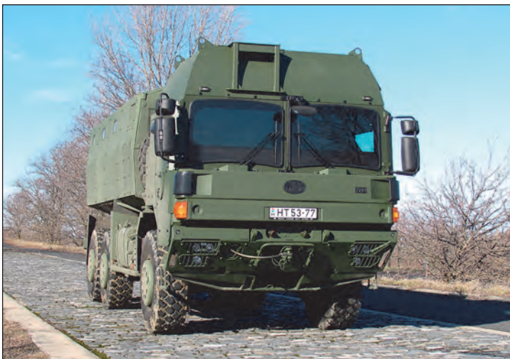
2. ábra. A RÁBA H18.240 DAEZ-111 típusú katonai terepjáró jármű, amelyet a missziós feladatok biztonságos ellátása érdekében védett zárt felépítménnyel szereltek fel
