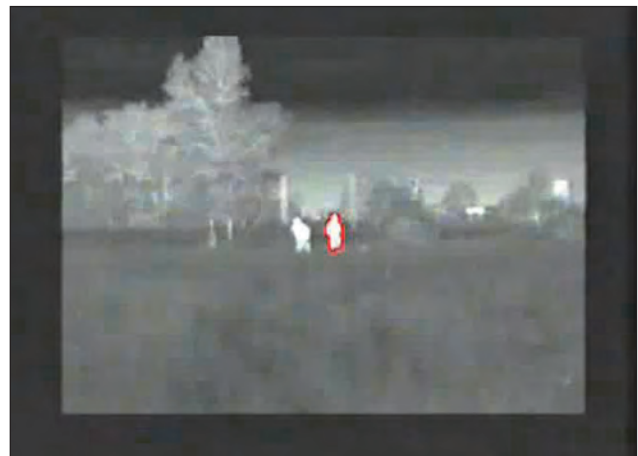
6. ábra. Infrakamera mozgásérzékelő üzemmódban. A rendszer a megtalált mozgó objektumokat piros határolóvonallal jelöli meg
