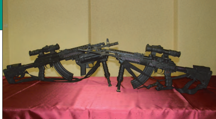
8. ábra. Az AK-63 MF gépkarabély a módosított váltámmasszal, hátsó és mellősi sínrendszerrel, markolattal, illetve lángrejtővel és tűzkiváltó karral. A karabélyt éjjel-nappali célzóberendezéssel, villalábbal és gránátvetővel szerelték fel
