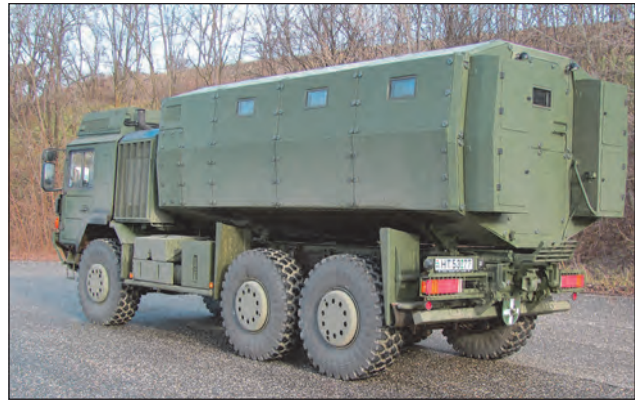
3. ábra. A katonai terepjáró járművet a magas szintű védeltséget biztosító RÁBA H860.01 típusú, páncélozott védett zárt felépítménnyel látták el
