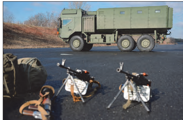
4. ábra. A védett zárt felépítménnyel ellátott RÁBA katonai terepjáró jármű és a lövészraj támogató fegyverzete
