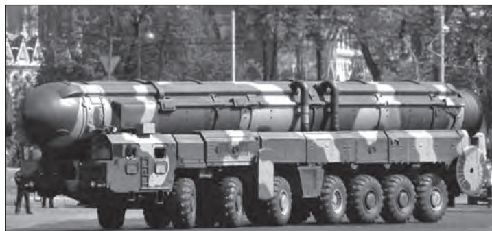
42. ábra. Topol rakétarendszer, 15P158 szállító-indító jármű MAZ-7917-es alvázon
