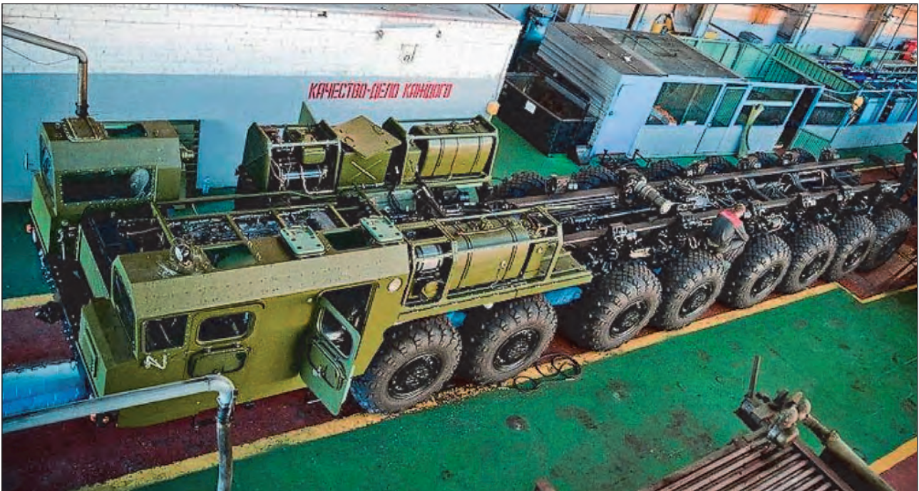
44. ábra. Az MZKT-79221-es alváz a szerelőcsarnokban
