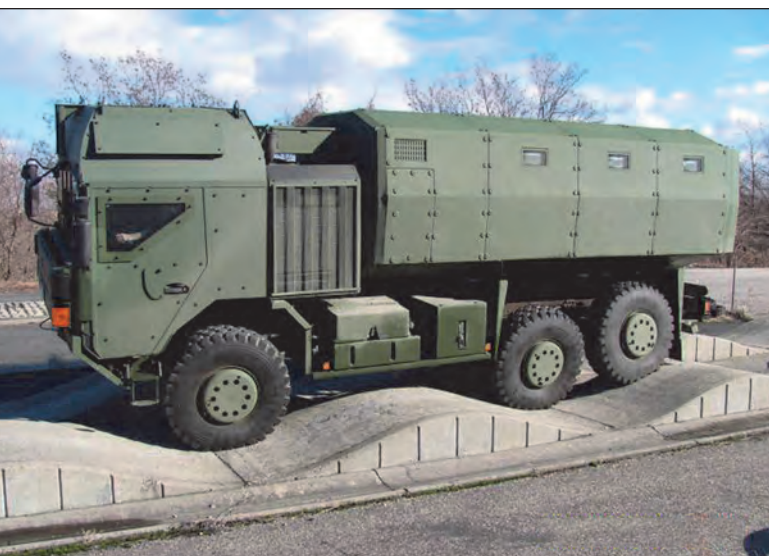
6. ábra. A VZF alvázcsvaró vizsgálata eltolt szinuszpályán
