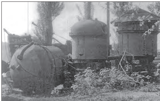
1. ábra. A DRAVA monitor három fedélzeti tarackja a páncéltoronnyal együtt leszerelt állapotban
