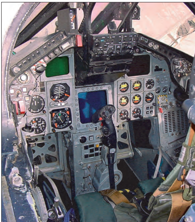
12. ábra. Műszerfal a Tornado harci repülőgép első pilótafülkéjében
