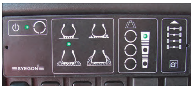
10. ábra. Syegon CTIS ECU, fejlesztett változat
