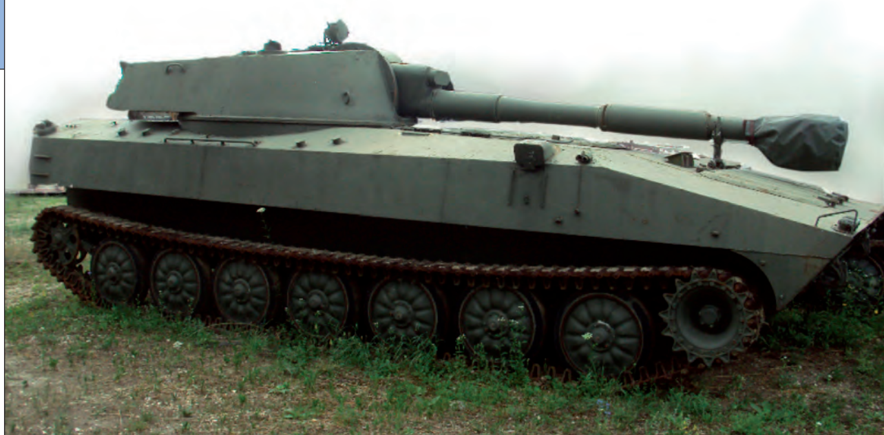
10. ábra. 122 mm-es 2S21 Gvozdika önjáráó tarack. Maximális lőtávolsága 15 300 m. Lőszere osztott, egy javadalmazás 40 db. Önsúlya 15 650 kg. Rendszerben 1971-től, 1980-tól kiegészítve az 1V12 „MASINA” tűzvezetési komplexummal
