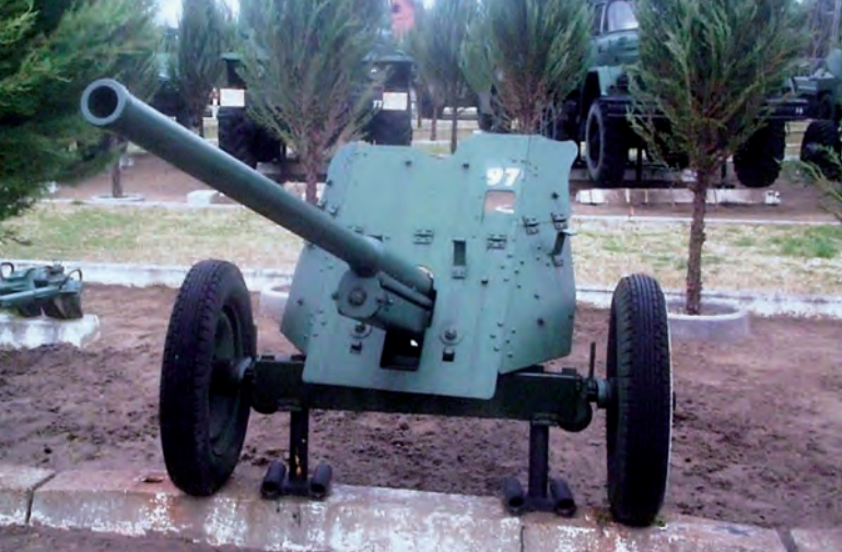
2. ábra. 45 mm-es 42M ZiS-1 páncéltörő ágyú. Maximális lőtávolsága 4550 m, löszere egyesített, egy javadalmazás 200 db. Páncél átütőképessége 90°-on 500 m-ig 61 mm, 1000 m-ig 51 mm, önsúlya 625 kg. Vontatása gépjárművel, vagy 2 lovas löveg mozdonnyal. Rendszerben: 1946–1947
