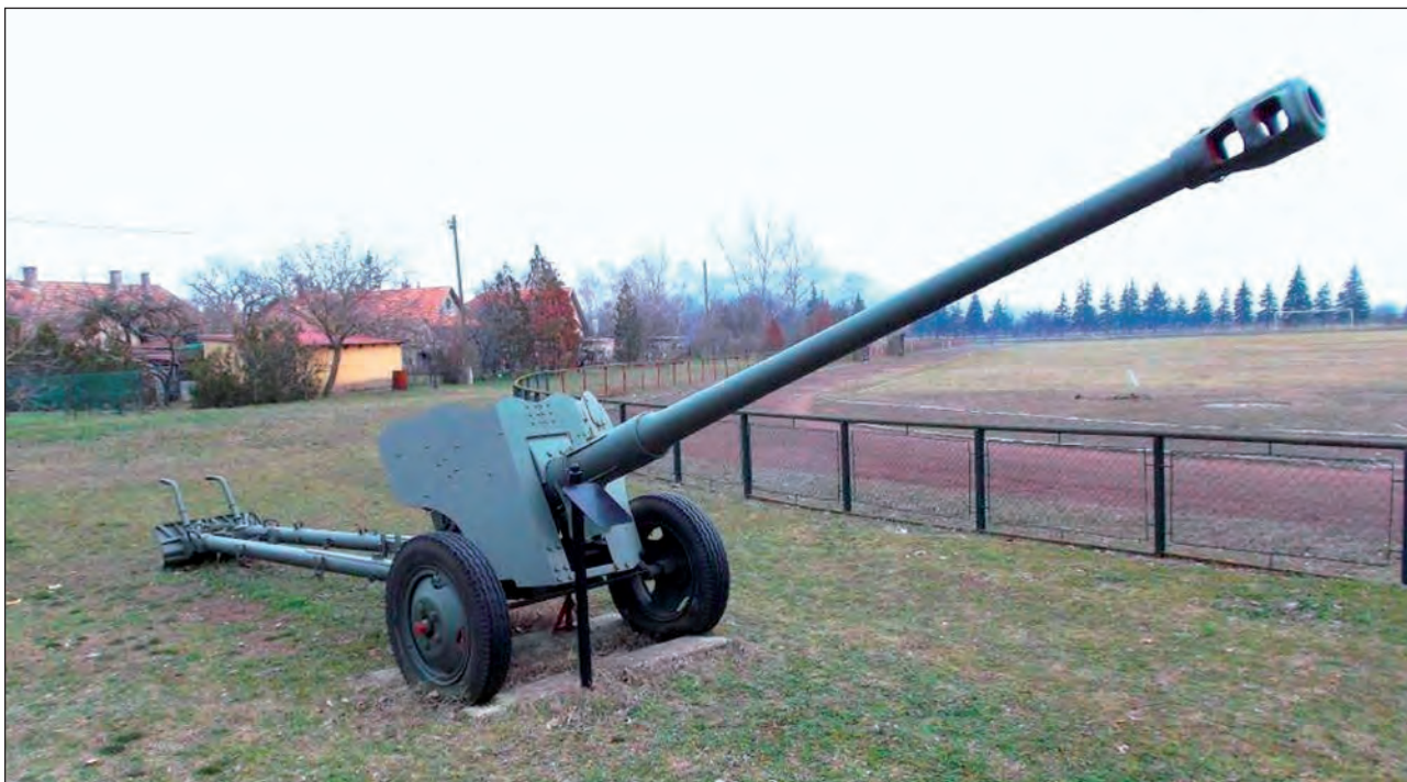
7. ábra. 85 mm-es D-44 pct ágyú. Maximális lőtávolsága 15 650 m. Lőszere egyesített, egy javadalmazás 80 db. Önsúlya 1700 kg, menete gépjárművel vontatva. Rendszerben 1960-tól
