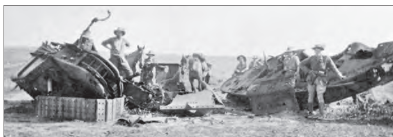
1. ábra. Egy a második gázai csatában kilőtt brit Mark I harckocsi roncsa az ausztrál 14. könnyűlovas-ezred katonáival. A belső lőszer- és üzemanyagrobbanás szétvetette a jármű testét (Australian War Memorial P03092.002)
