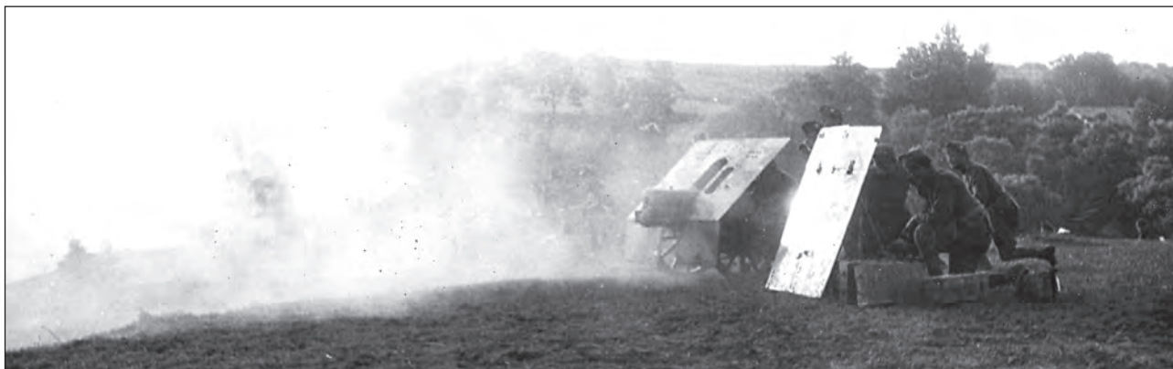
2. ábra. 1915M 7,5 cm-es hegyi ágyú lövés közben, mellette a lőszereket és a kezelők egy részét védő, az 1920-as években még rendszeresített lövegpaizs
