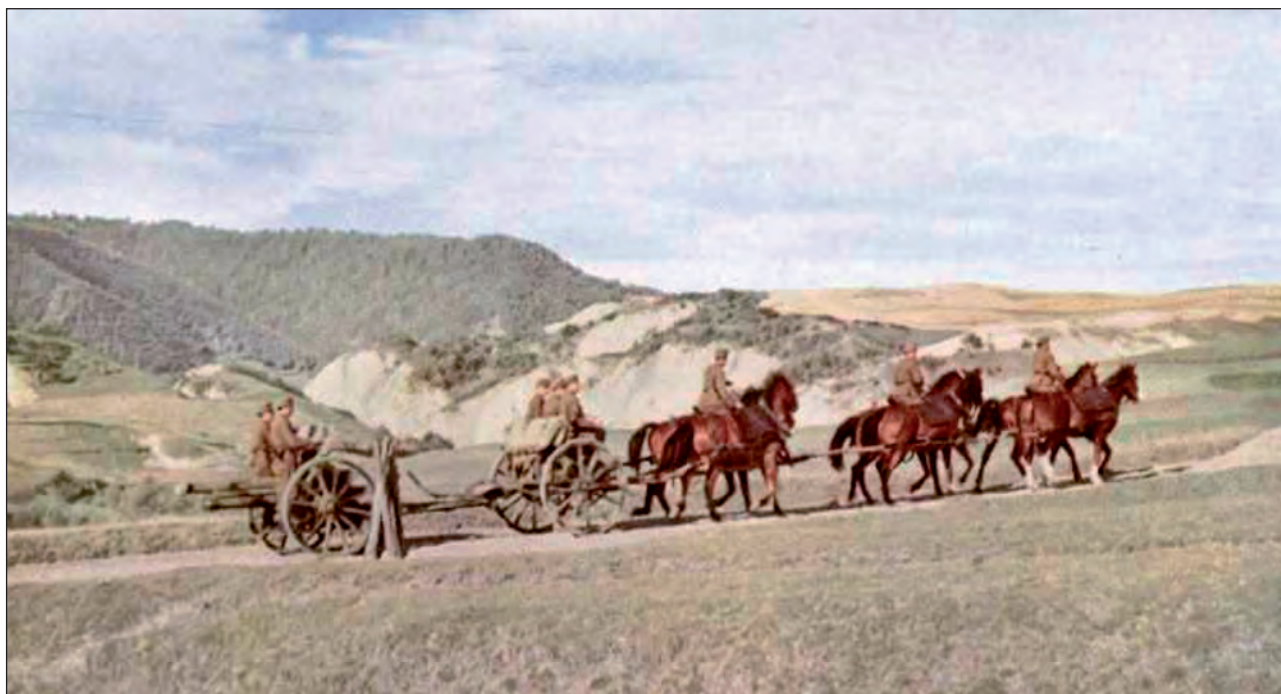
3. ábra. A magyar gyártású, 10,5 cm-es könnyűtarack fogatolt mozgatásához – több mint másfél tonnás tömege miatt – szintén hat ló kellett (S. Gy.)
