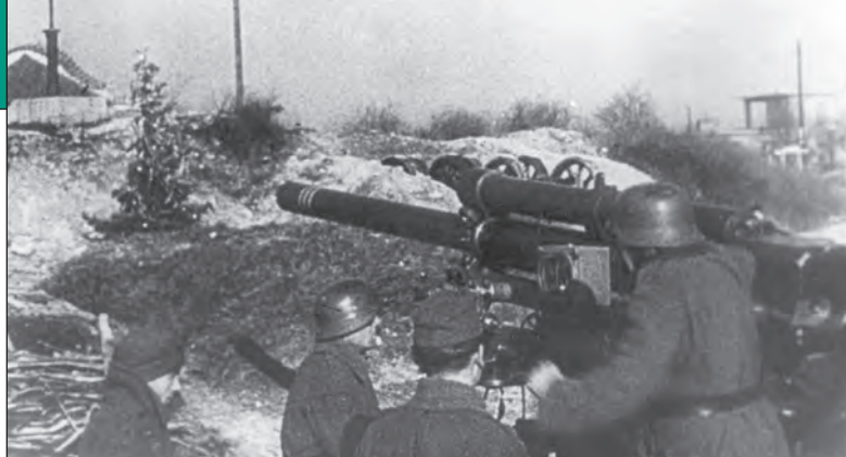
3. ábra. A Bofors licenc alapján hazánkban gyártott 8 cm-es légvédelmi ágyú közvetlen tűzkiváltásra is alkalmas volt
