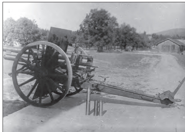
4. ábra. 1905/08M 8 cm-es fogatolt tábori ágyú – még az 1920-as években is használt – időzítető gyújtóval szerelt srapnelekkel, illetve a hüvelytölténnyel
