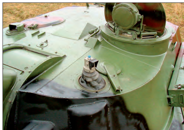
3. ábra. A forgatható torony a forgózsámollyal és a farrész a lőszertartóval alkotja a küzdőteret
