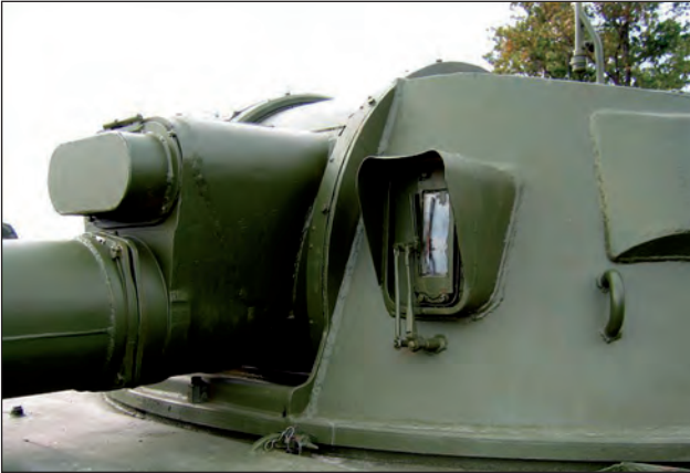
4. ábra. A küzdőtér bal elülső részében helyezkedik el a PG-2 irányzék, valamint a közvetlen irányzásra szolgáló OP5-37 optikai irányzék
