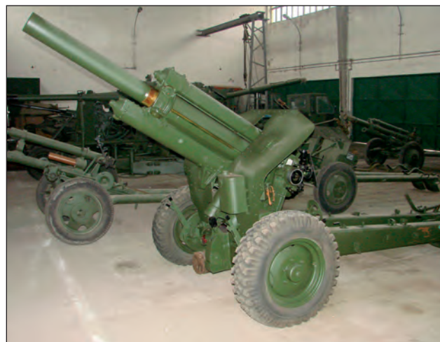
6. ábra. 122 mm-es 38/68M tarack. Rendszerben állt: 1968-tól. A Haditechnikai Intézet közreműködésével a tarackot korszerűsítették. A korszerűsítés lényege a nagyobb vontatási sebesség eléréséhez a kisebb átmérőjű és szélesebb futófelületű kerekek alkalmazása volt
