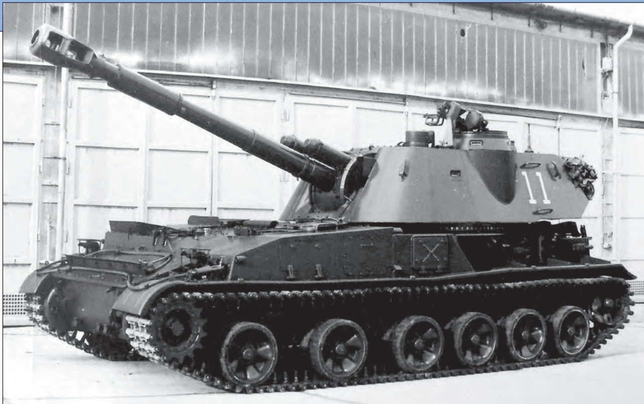
11. ábra. 152 mm-es 2S23 Akácia önjáró tarack. Maximális lőtávolsága 17 400 m. Lőszere osztott, egy javadalmazás 46 db. Önsúlya 27 500 kg. Rendszerben 1970-től
