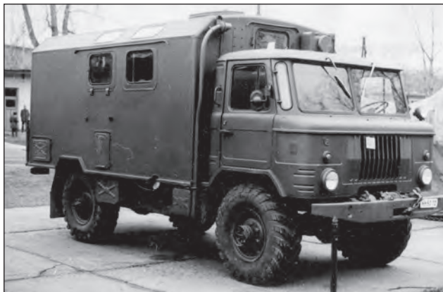
34. ábra. GAZ-66T bemérő gépkocsi
