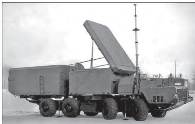
20. ábra. Sz-300PMU légvédelmi rakétarendszer, 30N6 X-sávú tűzvezető radar
