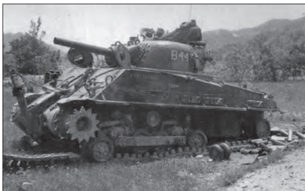
14. ábra. A sérülések ellenére az M4 harckocsi továbbra is harcképes maradt, amit a kilőtt ágyúszerek hüvelyei is jeleznek
