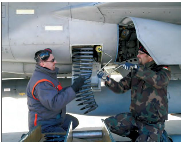
23. ábra. A gépágyú töltése (B.L.)
