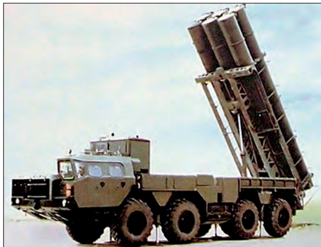
30. ábra. Reljef partvédelmi rendszer, robotrepülőgép 9V2413 szállító-indító járműve
