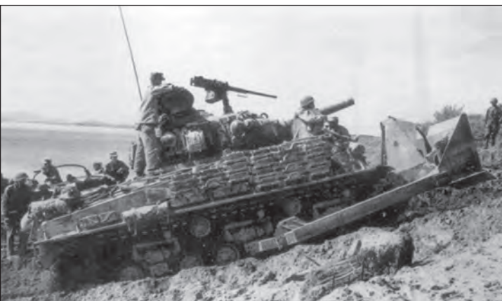
17. ábra. Tolólappal ellátott harckocsi, a koreai harcok fontos eszköze
