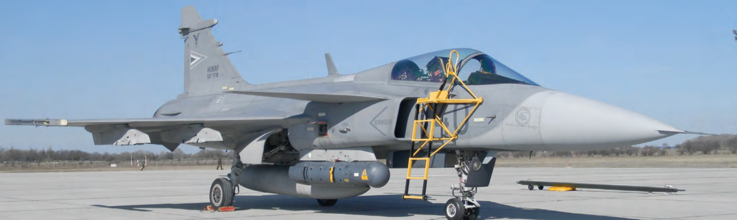
21. ábra. A Gripen törzs alatti, jobb oldali tartójára függesztve látható a Litening lézeres célzó és navigációs konténer (B.L.)
