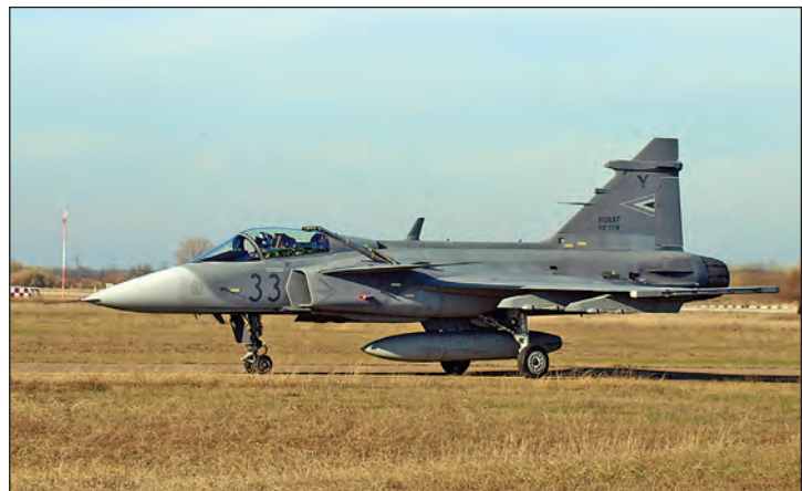
20. ábra. A szárnytőben jól látszik a Gripen kinti helyzetben lévő üzemanyag utántöltő csomója (B.L.)
