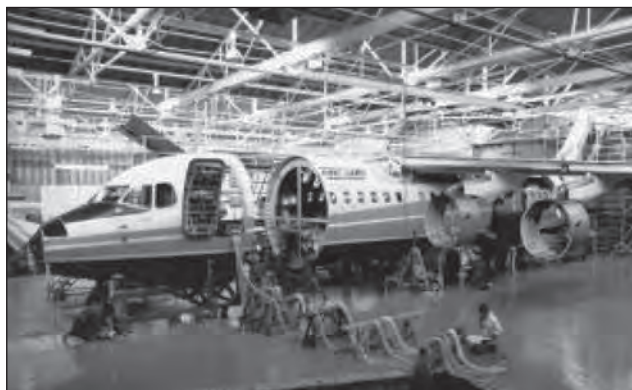
13. ábra. A G-SSSH átalakítás alatt 17
