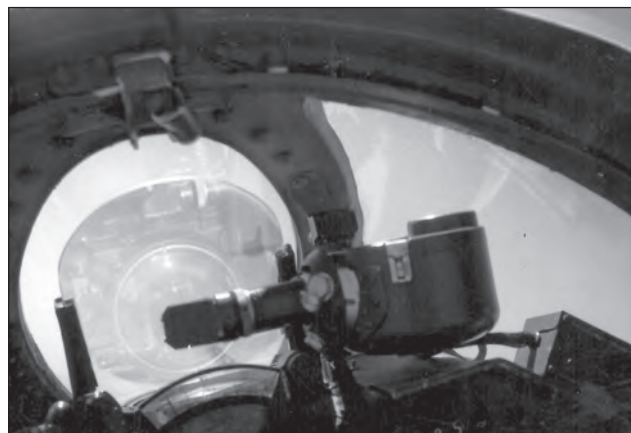
17. ábra. Kilátás a MiG–21MF, bisz gépekből, amit a később beépítésre kerülő berendezések tovább rontottak (a szerző felvétele)
