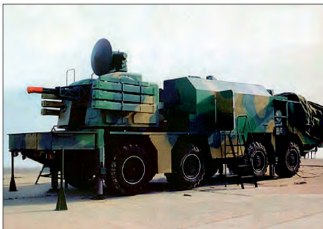
32. ábra. LD–2000-es pontlégvédelmi rendszer, WS–2400-es járműre telepítve
