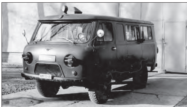
33. ábra. UAZ-452T bemérő gépkocsi
