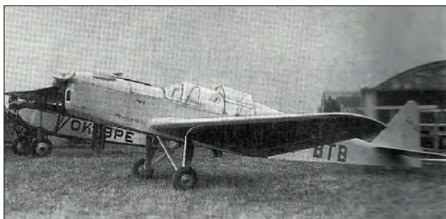
28. ábra. Z-XII típusú kétszemélyes, faépítésű repülőgép
