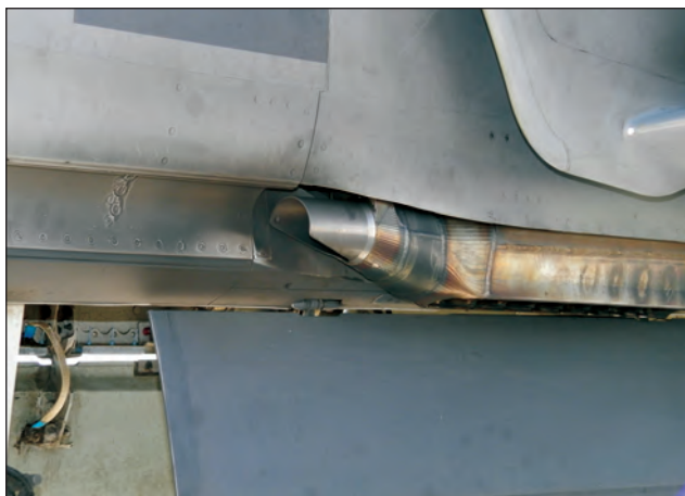
22. ábra. A repülőgép fedélzeti gépágyújának hőálló és rozsdamentes acélból készített borító-árnyékoló lemeze (B.L.)
