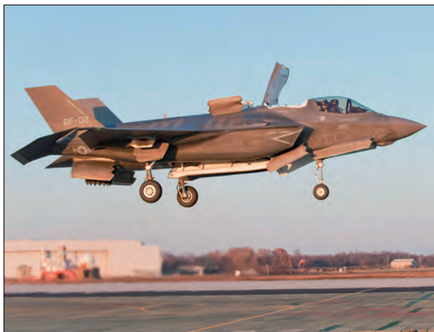
30. ábra. F-35B típusváltozat függőleges leszállása. Jól látható a nyitott ventilátor-fedél
