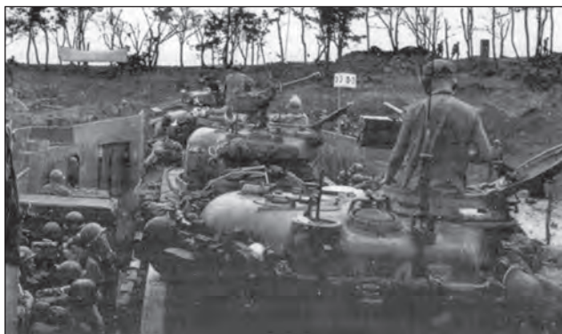
15. ábra. A képen látható harckocsikon a géppuskákat a toronnyírlás elé helyezték a jobb kezelhetőség érdekében
