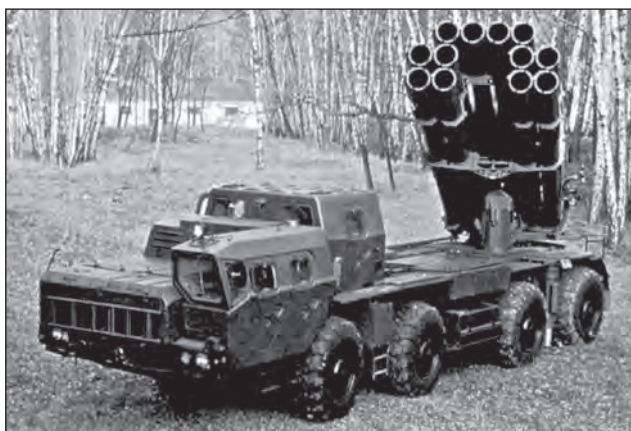
14. ábra. BM-30 Smercs rakéta sorozatvető 9A52 szállító-indító járműve
