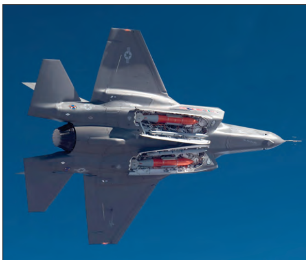
28. ábra. Az F-35 bombákkal és rakétákkal feltöltött, nyitott fegyverkamrákkal
