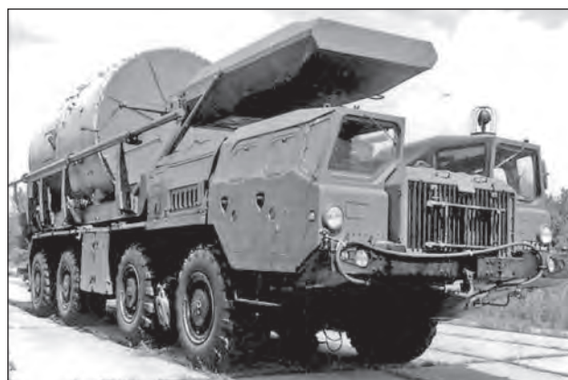
17. ábra. TUAP-2 interkontinentális rakétasiló-betöltő jármű (15T146)
