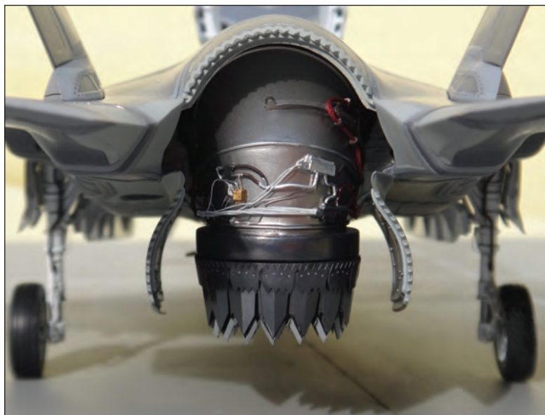
32. ábra. Az F-35 B farokrésze és felszálló helyzetbe állított fűvőcsőve (Makett: Szrna István)
