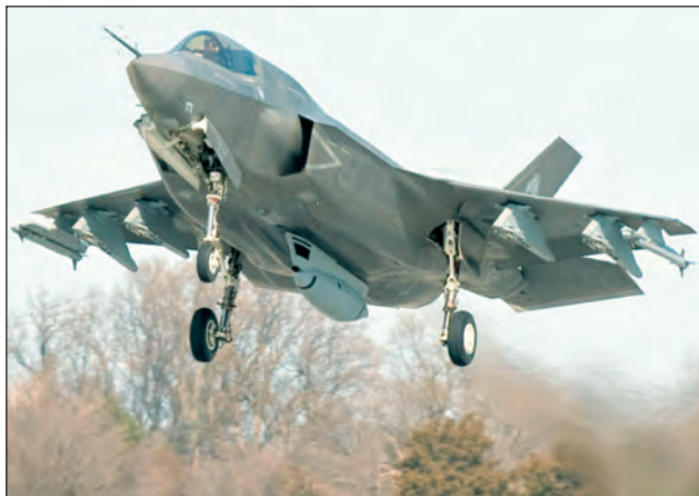
24. ábra. Egy F-35B a törzse alatt a GAU-22/A gépágyúkonténerrel és két AIM-9X makettal a szárnyai alatt (LM)
