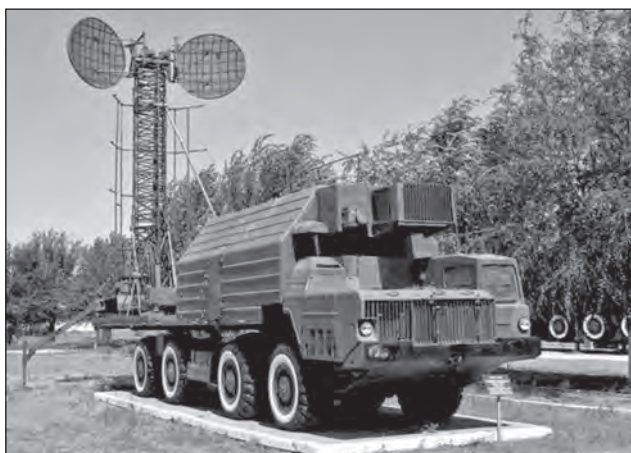
15. ábra. Barjer-M mobil parancsnoki harcálláspont MSz-2 Torf-2 híradástechnikai járműve (15V75)
