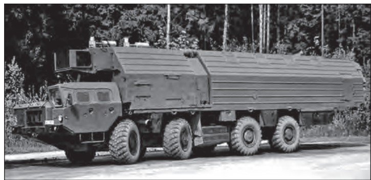
13. ábra. MAZ–543M jármű 7903 típusú zárt felépítménnyel a hadászati rakétaerők (RVSzN) számára
