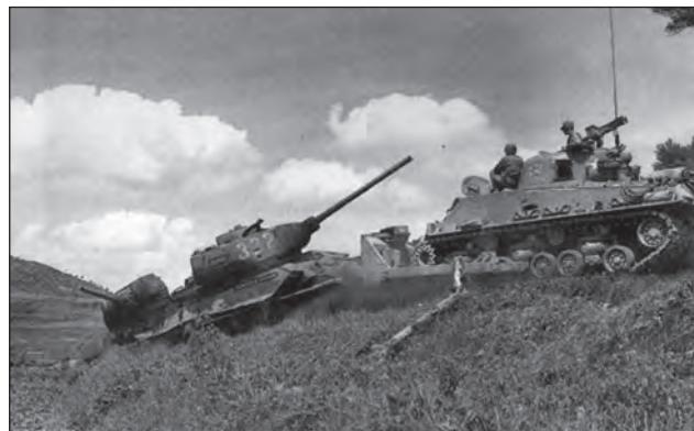
21. ábra. Az első Naktongi csata során egy tolólappal felszerelt M4 harckocsi megsemmisített T-34-eseket tol el
