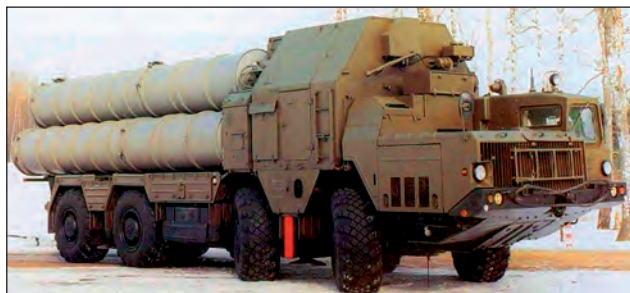
19. ábra. Sz-300PMU légvédelmi rakétarendszer 5P85 szállító-indító jármű
