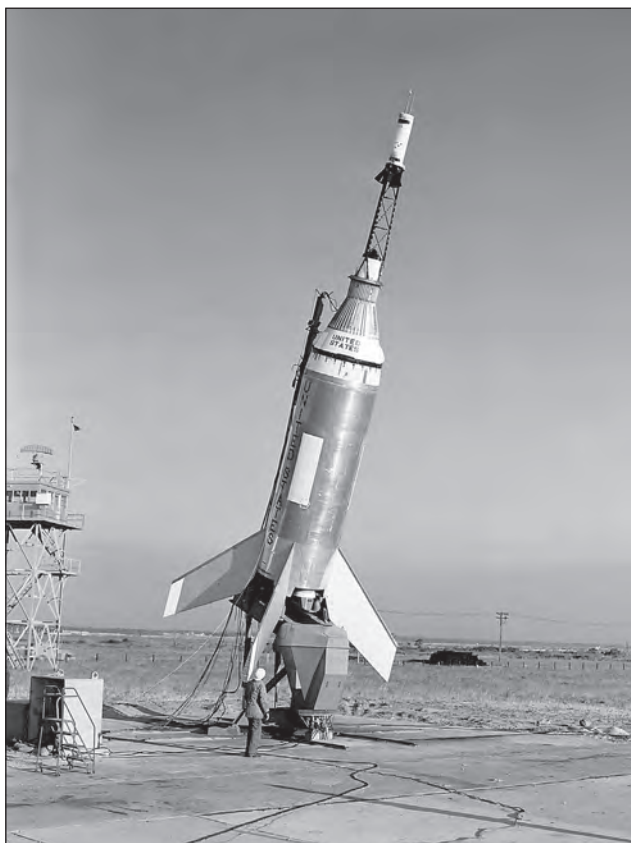
3. ábra. A fejlesztési kísérletekhez használt Little Joe-1 rakéta, tetején egy Mercury BP (boilerplate) űrhajóval
