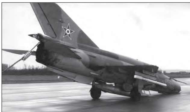
7. ábra. A 3732-es oldalszámú MiG-21bisz balul sikerült leszállása. A repülőgép farokrésznél, a függőleges vezérsík alatt becsatlakozva megfigyelhető a fékernyő kötél
