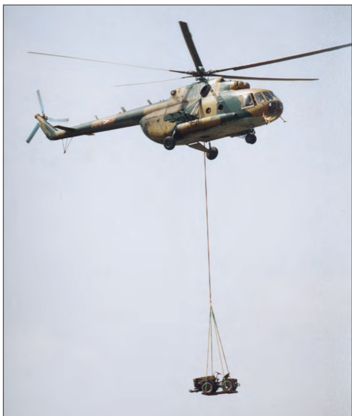
9. ábra. A Mi-17-es mintegy 4 tonnás terhelhetősége lehetővé teszi nagyobb tömegű eszközök külső teherként történő szállítását. A járműtechnikai eszközök a belső térben is elhelyezést nyerhetnek (B.L.)
