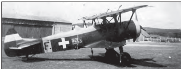
7. ábra. A Weiss Manfréd művek által tervezett, majd Csepelen és Győrben 128 példányban gyártott WM-21 Sóló, bombázó és géppuskával is felszerelt közelfelderítő repülőgép. 1941-ben a csapatok közvetlen támogatására is bevetették
