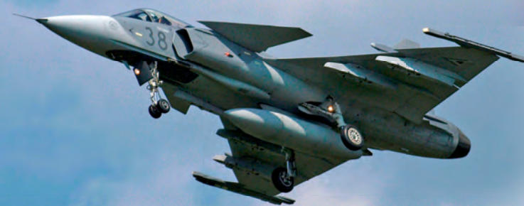
7. ábra. Hét ponton 5300 kg fegyverzet függeszthető a magyar Gripenre, ami közvetlen támogató feladatok végrehajtása során is hatékony csapásmérésre teszi képessé a típust
