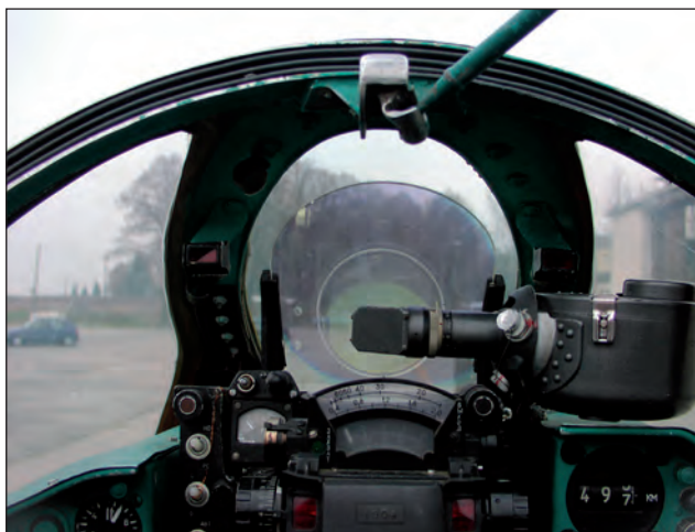
13. ábra. MiG-21bis repülőgép célzó berendezése és reflexüvege a fülkében, a páncéllevegő mögött
