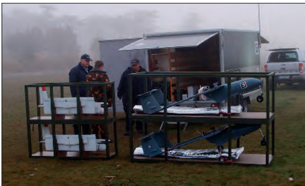
6–7. ábra. Az MRVP és a pilóta nélküli légi jármű konténerizált szállítása
