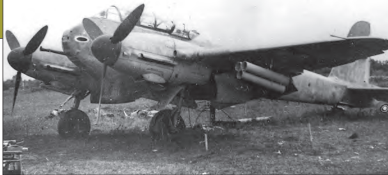
5. ábra. A Haditechnikai Intézet és a Repülő Kísérleti Intézet által átépített Me 210 harci repülőgép 40 mm-es gépágyúval és nem irányított rakétákkal a Dunai Repülőgépgyár Rt. repülőterén Tökölön, 1944 nyarán (S.Gy.)
