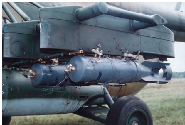
7. ábra. Bombafegyverzet célba juttatására is alkalmas a helikopter célzó berendezése. Ennek gyakoroltatására 50 kg-os bombákat függesztettek (B.L.)
