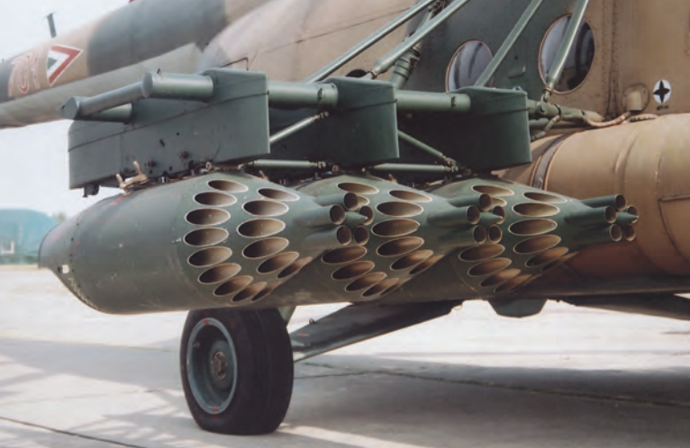
6. ábra. Oldalanként 3-3 db UB-32 nem irányított rakéta-blokk függeszthető a helikopterre (B.L.)
