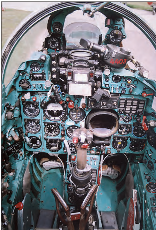
14. ábra. Hagyományos analóg műszerek sokasága a MiG-21bis pilótafülkéjében
