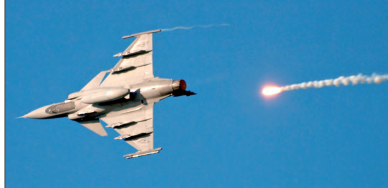
9. ábra. Infracsapdávétel a Gripenről az ellenfél által indított infravörös irányítású rakéta fegyverzet megsemmisítése érdekében
