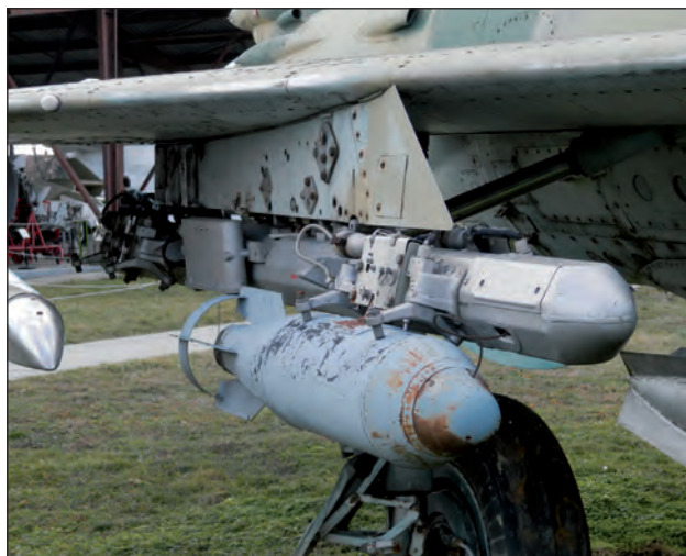
10. ábra. Négyzárás bombatartó egy MiG-21-esen (B.L.)
