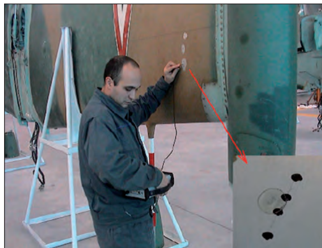
15. ábra. Ultrahangos repedésvizsgálat az L-39-es repülőgép szárnyán
