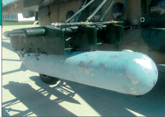
12. ábra. A póttartályok megegyeznek a Mi-24 típuson alkalmazottal. Megfigyelhető a rácstartóra szerelt tüzelő- anyag vezeték (Fotó: Sáros Zoltán)
