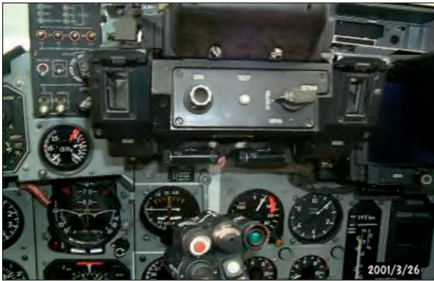
5. ábra. Ellenség-barát rendszer sorozatbeépítése MiG-29B és UB típusú repülőgépekbe
