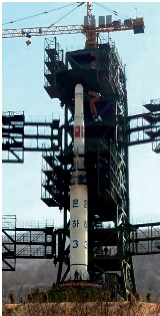
3. ábra. Az Unha-3 hordozórakéta az indítópádon, a szerelőtorony már nyitott helyzetben van
