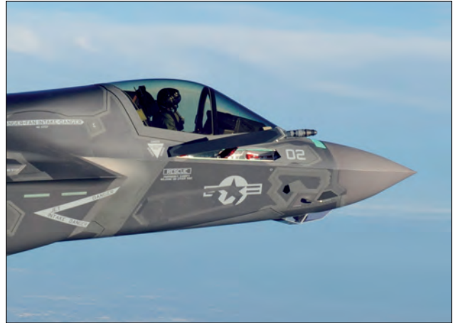
19. ábra. Az F-35B orr része, jól látható az EOTS az orr alján, továbbá a kibocsátott töltőcsomk (LM)
