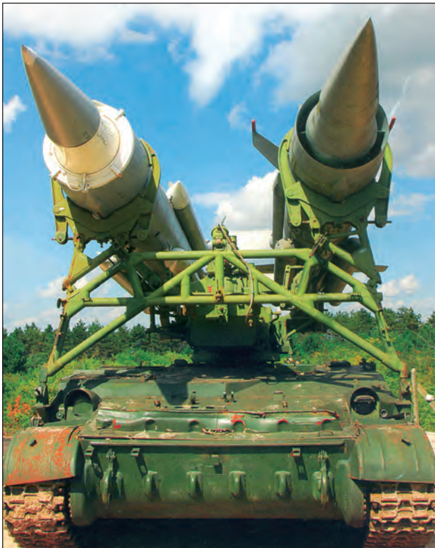
9. ábra. A Krug légvédelmi rakétarendszer önjáró lánctalpas indító járművön
