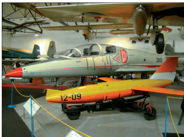
5. ábra. Letov KT-04 célgép és speciális L-39 vontatója. A felszállás a kocsi
