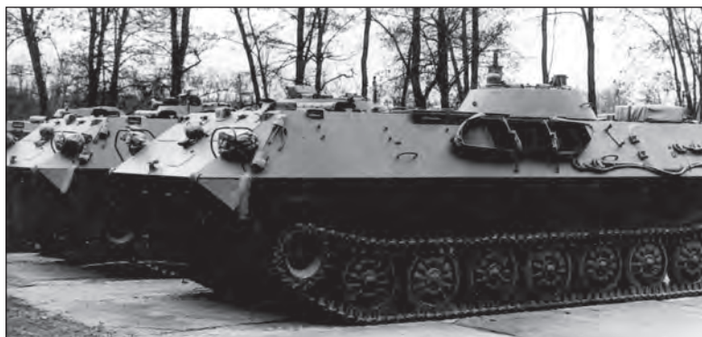
30. ábra. 1V12 „MASINA” önjáró tüzérosztály tűzvezető komplexum
