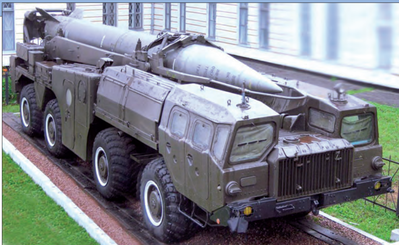
11. ábra. R-300 Elbrusz harcászati rakétarendszer 9P120 szállító-indító járműve
