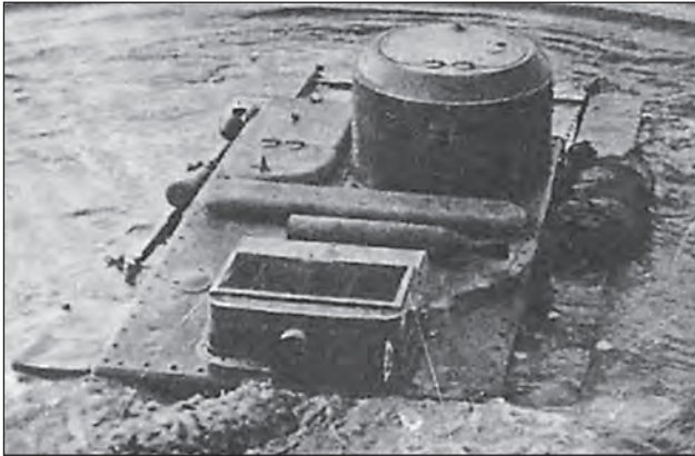
5. ábra. Az 1942-ig nagy számban rendszerben tartott, mindössze kétszemélyes T-37 kisharckocsi úszóképes volt ugyan, ám egyetlen 7,62 mm-es géppuskából álló fegyverze- te csak felderítési feladatokra tette alkalmassá, a német páncélosok elleni küzdelemre nem
