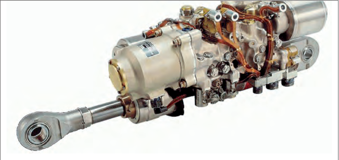
15. ábra. Az F-35 oldalkormány-mozgató EH motorja (Parker Aerospace)
