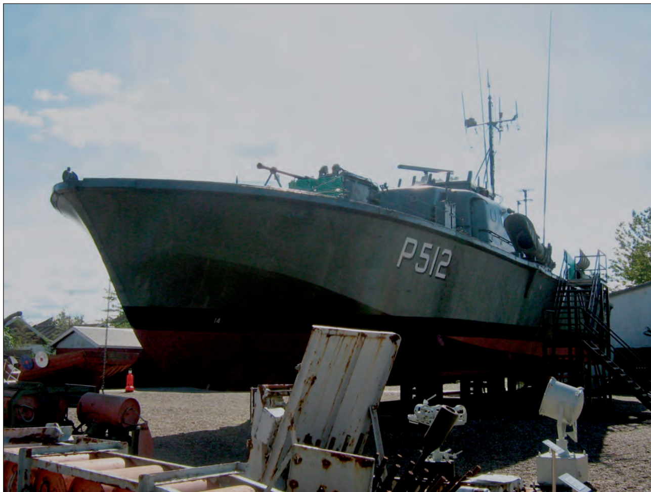
10. ábra. A „Sjøbjørn” gázturbina hajtású, torpedókkal, ágyúval és aknákkal felfegyverzett gyorsnaszád
