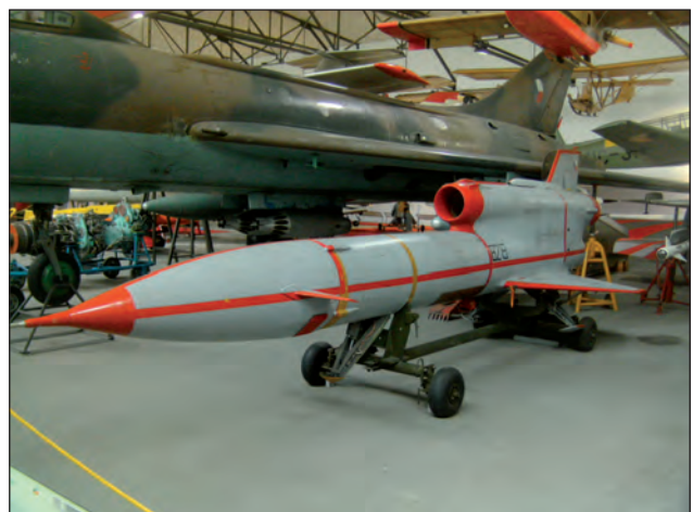
8. ábra. VR-3 Rejs szovjet gyártmányú pilóta nélküli felderítő repülőgép. A Tupoljev iroda terméke 1984-től állt hadrendbe
