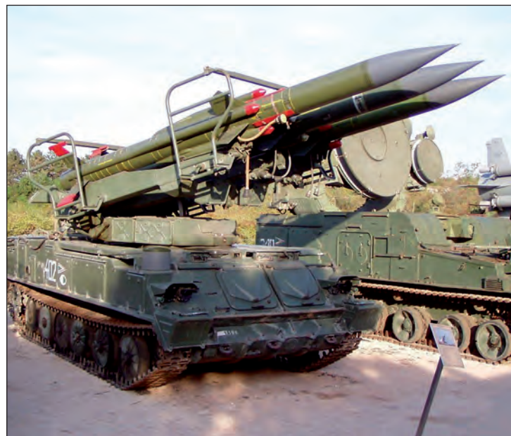
6. ábra. A Kub alegységben négy darab 2P25 típusú önjáró indítóállvány volt, ezért a nem VSZ országokba Kvadrat néven szállították. A háttérben egy lokátoros jármű látható
