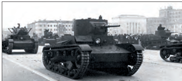
4. ábra. A szovjet páncéloscsapatok eszközparkjának 1941-ben még a gerincét képező T-26 könnyűharckocsinak nemcsak 15 mm-es páncélzata bizonyult elégtelennek a német harckocsikkal szemben, de a rendkívül kis futógörgői és 50 LE-s teherautó-motorja miatt maximálisan elérhető 28 km/h-s sebessége is
