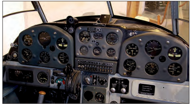
16. ábra. Saab 91D Safir műszerfal
