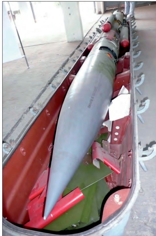
7. ábra. 3M9 típusú Kub légvédelmi rakéta a tartós tárolásra alkalmazott konténerben. A képen a rakéta tantermi változata látható, amelyen kialakított nyílásokon a belső szerkezeti elemeket is tanulmányozhatták
