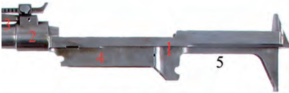
16. ábra. Ismétlő puska tok 1. tok, 2. csőfogalvány, 3. szerelt cső, 4. tárfészek, 5. elsütőberendezés fészek
