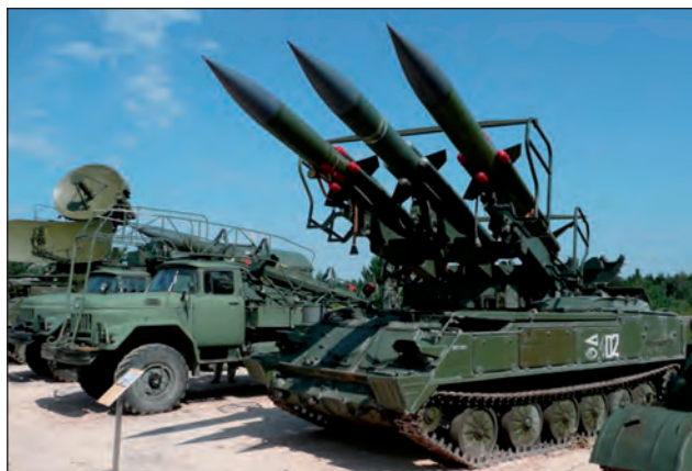
4. ábra. Kub légvédelmi rakétarendszer elemei elől az indítóállvány három rakétával, mellette töltő-szállító harcjármű, háttérben a rakétarávezető állomás
