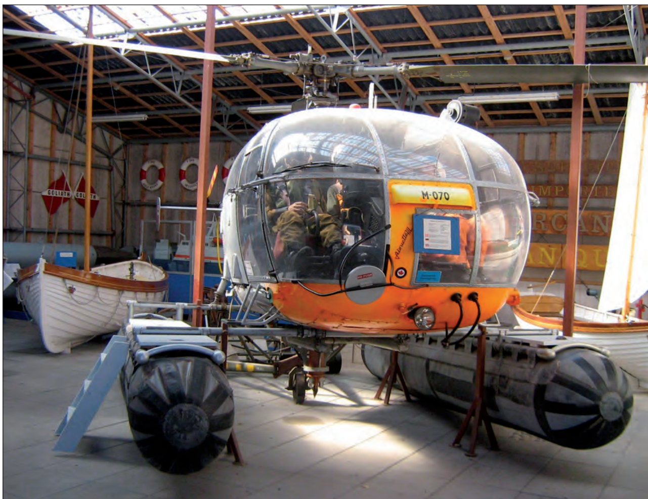
7. ábra. Alouette III helikopter felfújható, vízreszálló talpakkal
