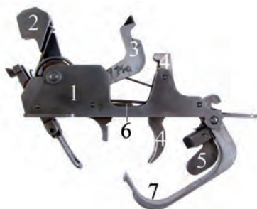
20. ábra. Az elsütőberendezés 1. elsütőház, 2. kakas, 3. kikapcsoló emelő, 4. elsütőbillentyű, 5. tűzváltó, 6. elsütőemelő (hátso nyúlványa), 7. sátorvas
