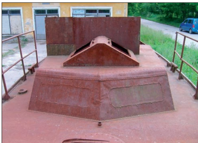
6. ábra. A hajó felépítménye az eredeti kormányállás lehegesztett ablakaival, az utólag ráépített felvilágító ablakkal és az új kormányállás mellvédjével
