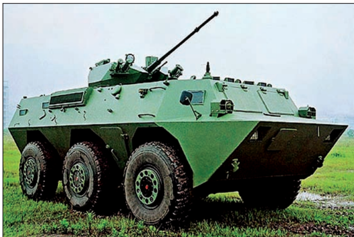
8. ábra. A ZSL 92 (WZ551) típusú harcjármű itt gépágyú fegyverzettel ellátva
