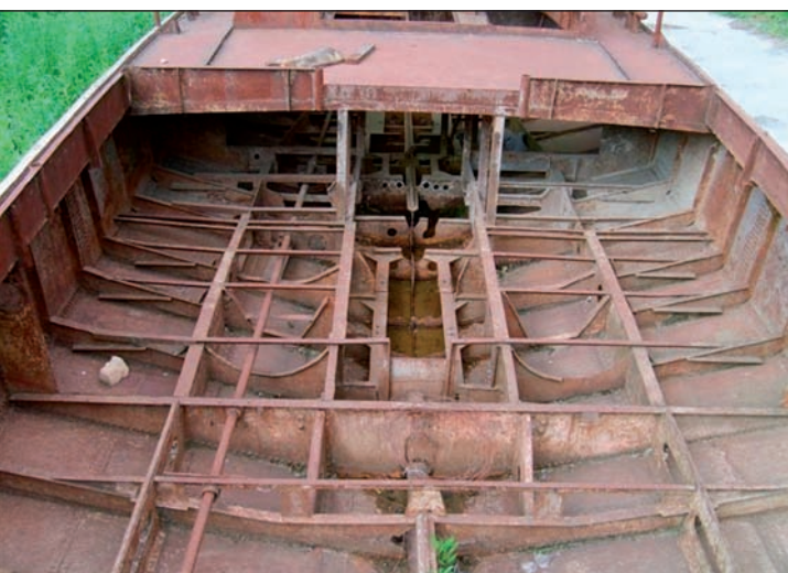
7. ábra. A hajóváz: a gerinc, a bordák és a két gépalap
