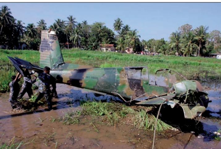
8. ábra. A másik öngyilkos bevetésen részt vett Z-143L-t lelőtték. Jól látszanak a gép törzsén a golyónyomok és a SKY TIGERS felirat, a függőleges vezérsíkján pedig a 905-ös szám. A fülkében egy 50 literes hordóban és 10 db 16 kg-os dobozban helyezték el a C-4 plasztik robbanóanyagot
