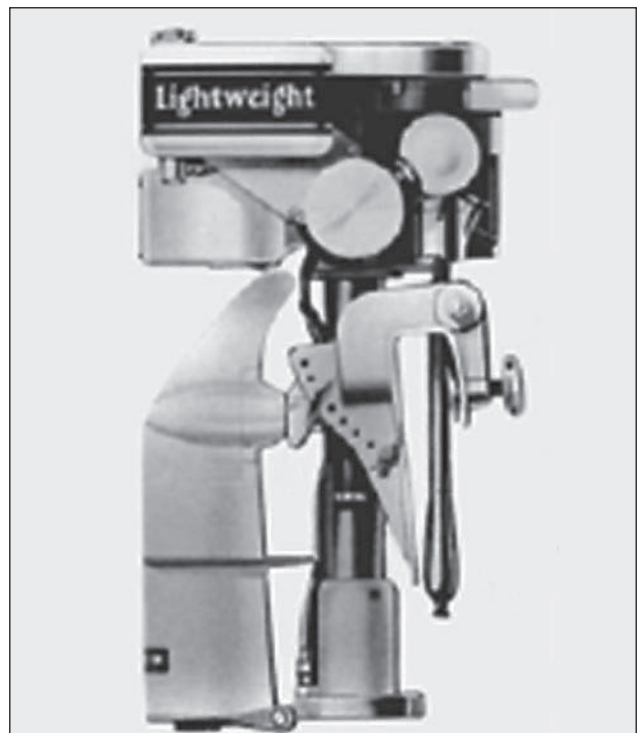
7. ábra. Felhajtható Evinrude csónakmotor 1929-ből
