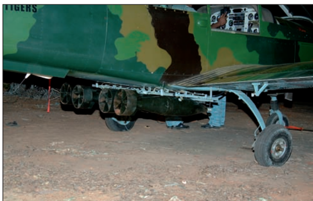
3. ábra. Zlin tereptarka festéssel és 4 db „MK-60 HE” bombával
