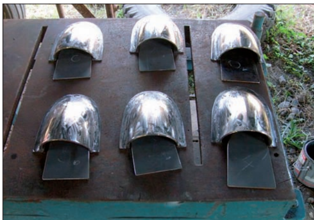
10. ábra. A géptéri szellőzők, ún.: „kopolyúk” kialakítása
