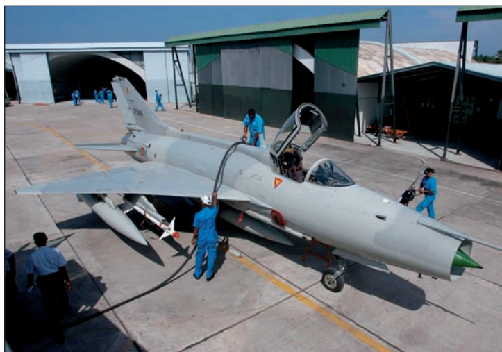
6. ábra. Szingaléz katonák kínai gyártású F-7GS (orosz MiG-21-es másolat) vadászgépe, két darab PL-5E infravörös rakétával, és három 500 literes póttartállyal. A háborúban összesen 550 harci bevetést végeztek, többnyire bombázóként
