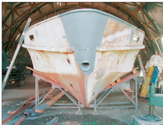
11. ábra. A kigömbült és helyreállított habvédlemez
