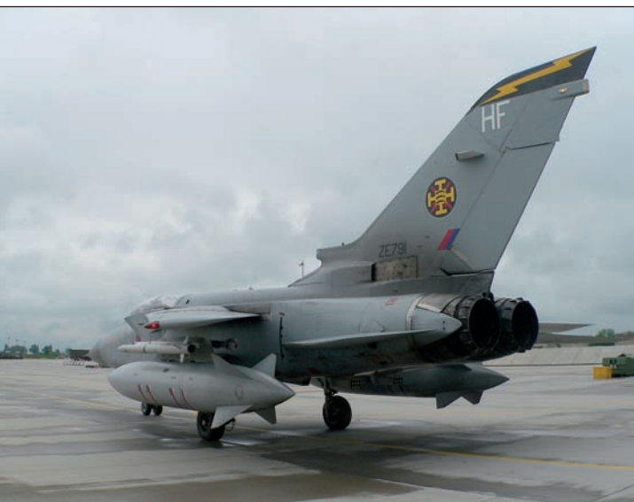
18. ábra. A leuchars 111. repülőszázad Tornado ADV F3 repülőgépe Kecskeméten. Jól látható a Hindenburger becenevű óriási póttartály és az AIM-132 ASRAAM közelharc rakéta gyakorlórakétázata
