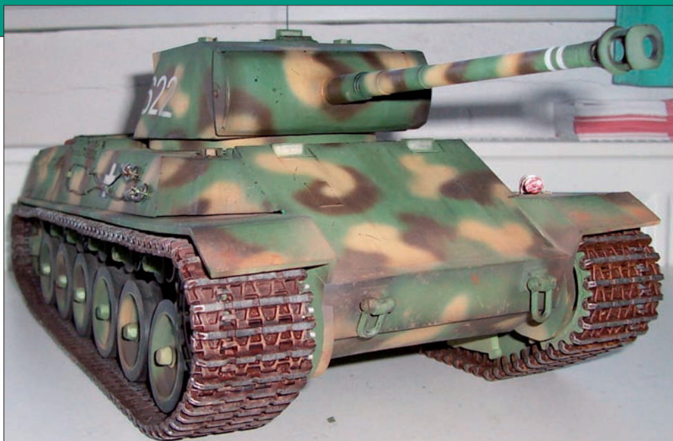
10. ábra. A prototípus lövege megegyezett volna a Pz-IV harckocsi 75 mm-es harckocsiágyújával, sorozatgyártás esetén azonban L 57,3-as 80 mm-es löveggel lett volna ellátva, amely 872 m/s lövedék-kezdősebességet garantált 8 kg-os gránáttal
