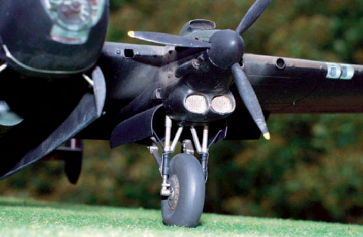
9. ábra. A Rolls-Royce Vulture motor gondolája a futóművel
