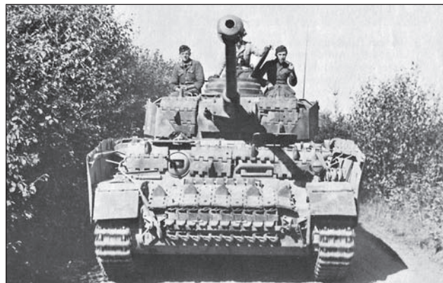
2. ábra. Ez a Pz IV-es német páncélos a kötényezésen túl, szinte teljesen be van burkolva T 34-es lánctalpdarabokkal
