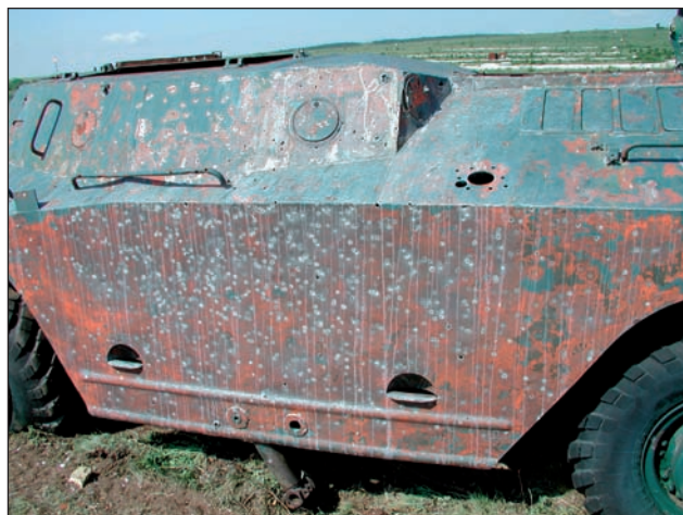
21. ábra. Keményfém-magvas lövedékek hatása egy páncélozott szállító harcjárművön
