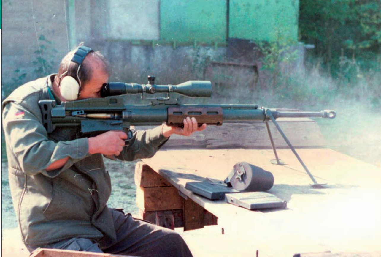
26. ábra. A Gepárd fegyvercsalád egyik öntöltő kísérleti mintapéldányának lőpróbája az 1990-es évek elején
