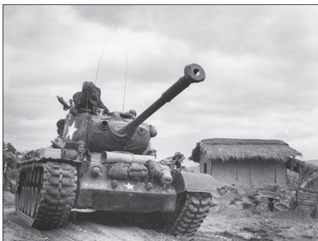
6. ábra. A Patton még a Pershinghez képest is zabálta az üzemanyagot az elődhöz képest másfélszeres fogyasztásával (4,5 gallon mérföldenként)
