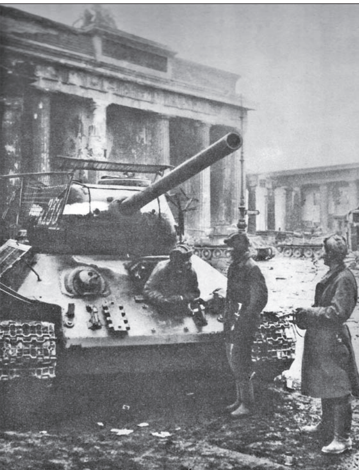
9. ábra. Szovjet T 34/85 harckocsi Berlinben, kézi kumulatív fegyverek elleni acélhálókkal
