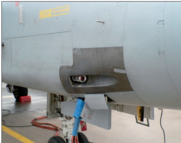
16. ábra. A Tornado ADV beépített tűzfegyvere a 27 mm-es MAUSER BK gépgyű
