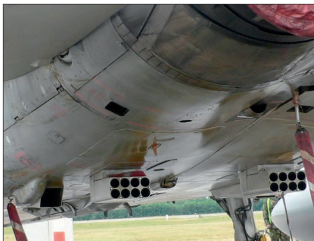
15. ábra. Infracsapda és dipolszóró a Tornado ADV F3 törzsének alsó részén
