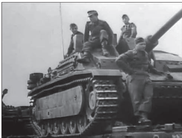
3. ábra. StuG III rohamlöveg, fa oldalköténnyel
