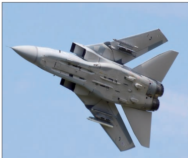
9. ábra. Tornado F3 alulról. Jól láthatóak a félig besüllyesztett, közepes hatótávolságú légi harc-rakétáknak kialakított függesztőpontok
