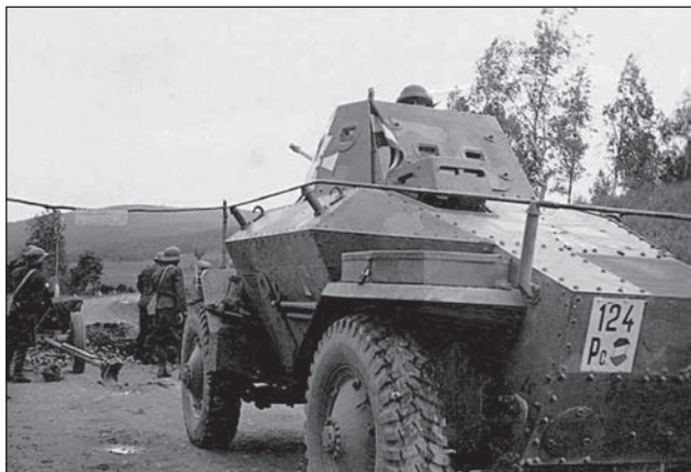
32. ábra. Jól látszik a Csaba páncélaútó hat ponton rögzített, korlát-antennája.
