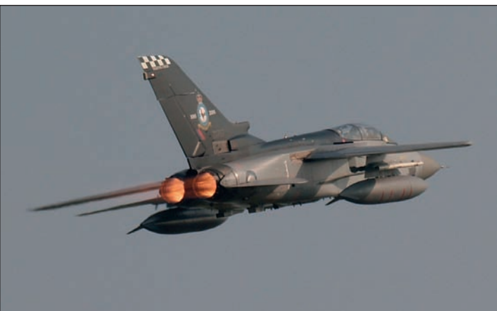
7. ábra. A Tornado ADV F3 Turbo-Union RB199-34R hajtóművei utánégető üzemmódban, felszálláskor
