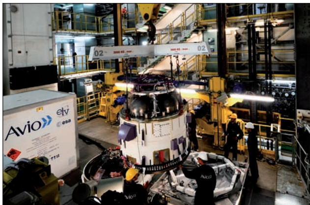
10. ábra. A 4. fokozat felszerelése a kaputoronyban
