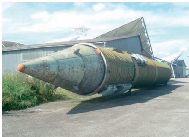
19. ábra. Az SS-24 rakéta hajtóművek nélküli palástja és orrkúpja
