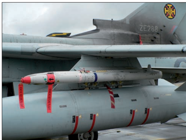
10. ábra. Tornado ADV-n a Hindenburger szárny-póttartály mellett lehet rövid hatótávolságú légiharc-rakétát hordozni. A képen AIM-132 ASRAAM van felfüggesztve
