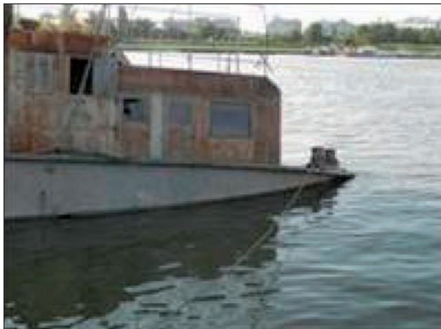
5. ábra. A belgrádi betonhajó acélból készült felépítménye
