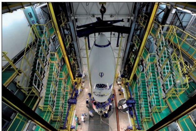
16. ábra. A műholdak tartószerkezete és az orrkúp integrálása a rakéta többi részével
