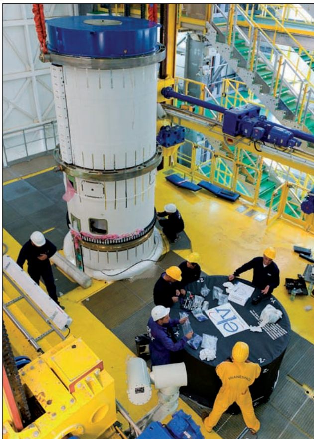
9. ábra. A 3. fokozatot összeillesztik a rakéta többi részével
