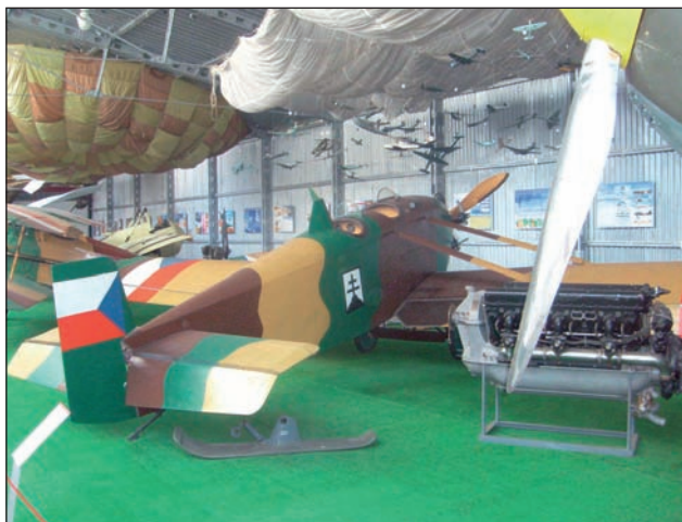
8. ábra. Húszas évekből Avia BH-11 monoplán replikája és egy V-12-es folyadékhűtésű repülőgépmotor a II. világháborúból
