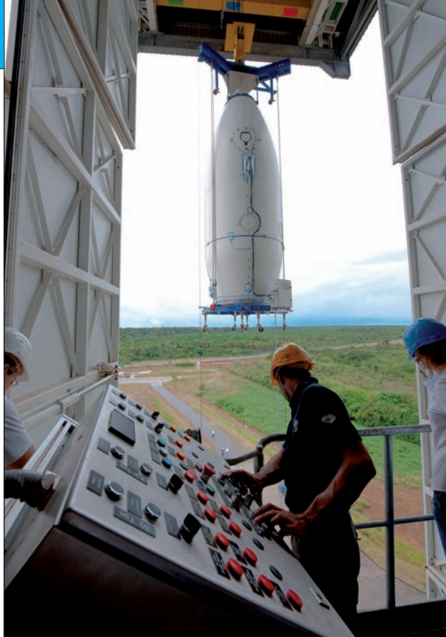
15. ábra. Az orrkúp alatt kilenc műhold ráemelése a Vega rakétára
