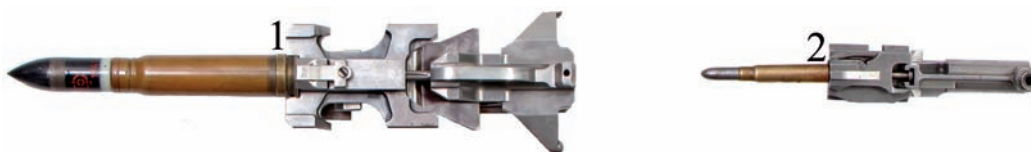
4. ábra. Zár-szerkezetek (1. 20 mm-es kísérleti nehéz géppuska, 2. 1934/ 37 M. 8 mm-es megfigyelő géppuska zár-szerkezetei)
