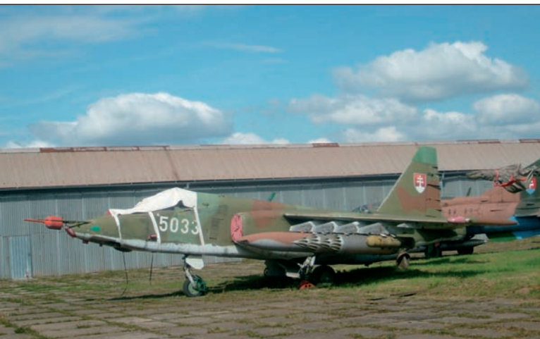
17. ábra. Szuhoj Szu-25 páncélozott csatarepülőgép rakétafegyverzettel
