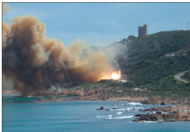
7. ábra. A Zefiro-9A égetési próbája 2009. április 28-án a Szardínia szigetén lévő Salto di Quirra Inter-force Test Range-n (ESA)
