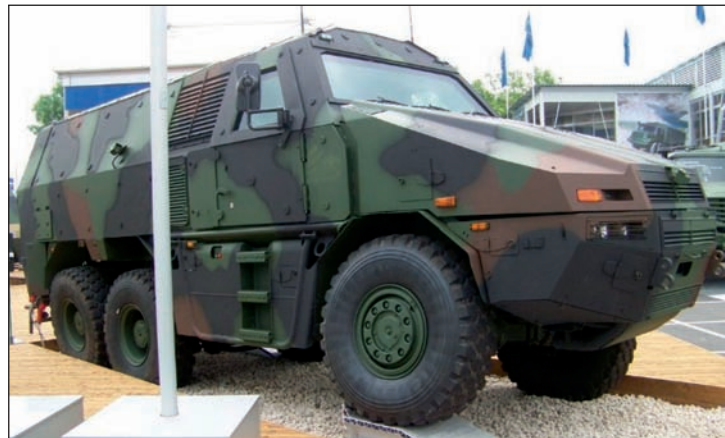
2. ábra. A KMW Grizzly szállító jármű prototípusa
