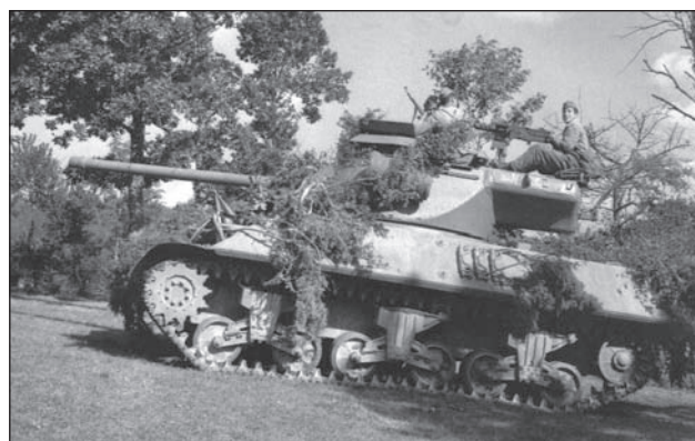
11. ábra. Ez már egy másik éra. Jugoszláv szolgálatban az M36-okba a T-55 dízelmotorját építették be. Az öreg típushoz korszerű kumulatív löszereket is rendszeresítettek
