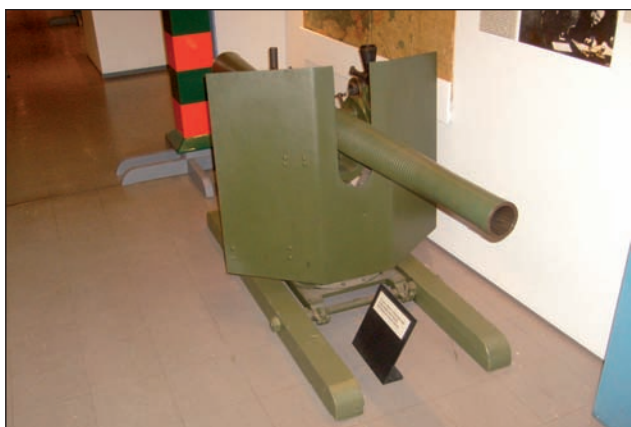
9. ábra. Finn átalakítás, aknavető szállítása szántalpon
