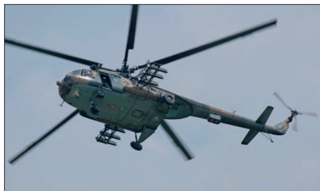
7. ábra. Mi-17-es a fegyverfelfüggesztő pilonokkal
