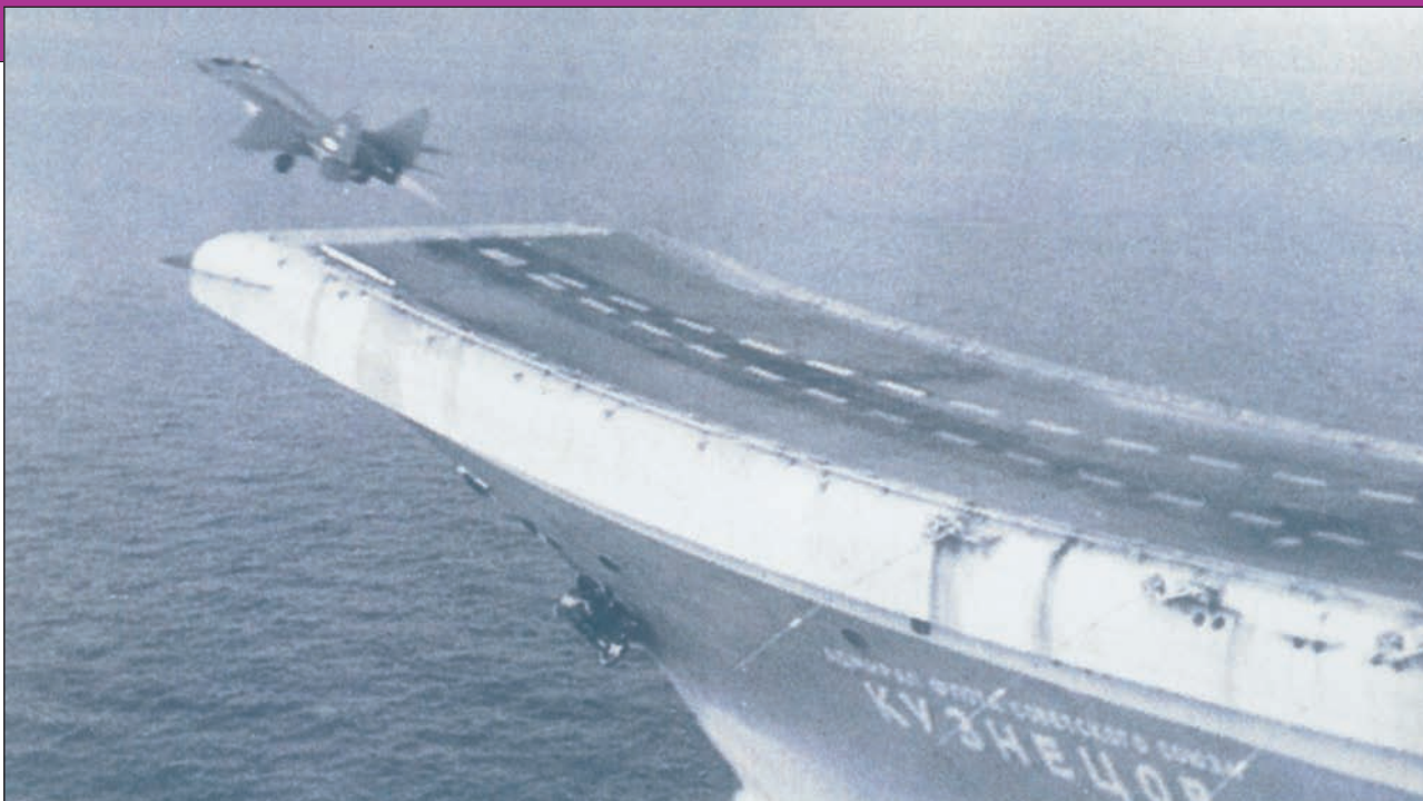
6. ábra. A TBILISZI/KUZYNECOV fedélzetén végzett próbák bebizonyították, hogy egyik gépnek sem okoz gondot a külső rásegítés nélküli felszállás. A MiG-29K azonban jelentősen nagyobb sebességgel érkezett a leszálláshoz, míg a Szu-27 a megközelítés során sokkal „megbocsátóbb” volt. A nagyméretű Szuhoj nagyobb hatótávolsággal is rendelkezett
