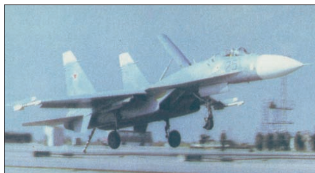
3. ábra. A Szu-27K fejlesztéséhez számos Szu-27 törzset használtak fel, a két legfontosabb ezek közül a kacsa vezérsíkokkal felszerelt T10-24 és a képen látható, fékhoroggal ellátott T10-25 (Szaki, NITKA központ)
