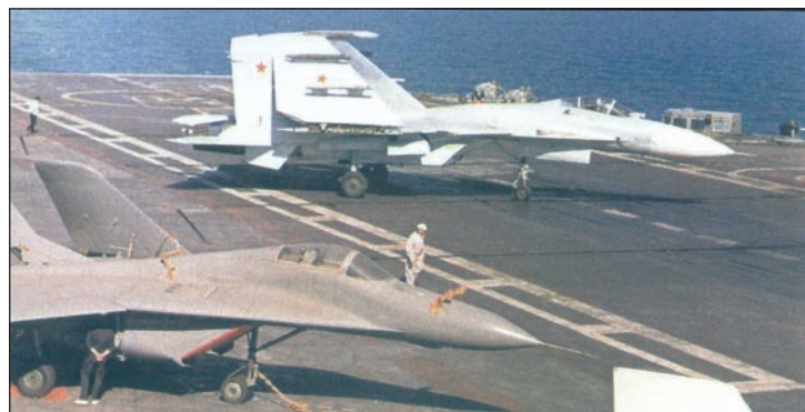
5. ábra. Az első sorozatgyártású Szu-33, a T-10K-3 egy fa MiG-29K-val osztozik a fedélzeti helyen. Ez utóbbi fontos eszköz volt a fedélzeti kezelhetőség felmérésénél, valamint a gép „bepróbálásánál” a fedélzeti liftek és hangár esetében
