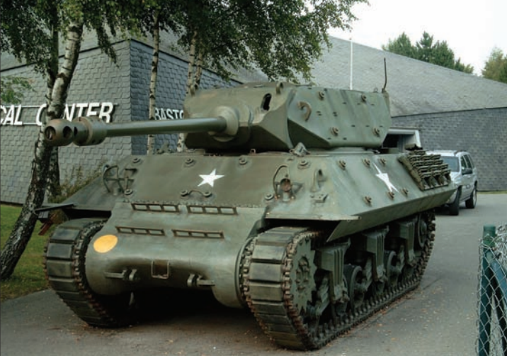
10. ábra. A brit változatot a kétkamrás csőszájfékről lehet legkönnyebben felismerni. A páncéltesten látható szegecsek eredetileg pótpáncél felerősítésére szolgáltak, de soha nem használták őket
