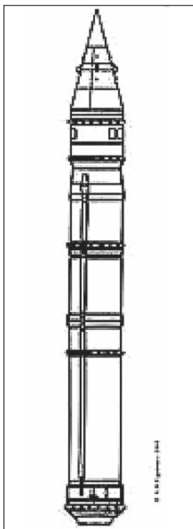
2. ábra. Az RSz-22B rakéta elrendezési vázlata
