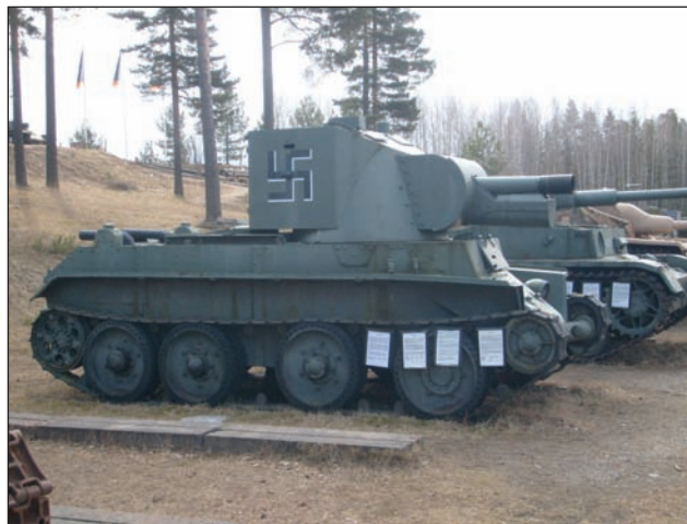
13. ábra. Zsákmányolt BT-5 átépítés, finn 152 mm-es tarackkal
