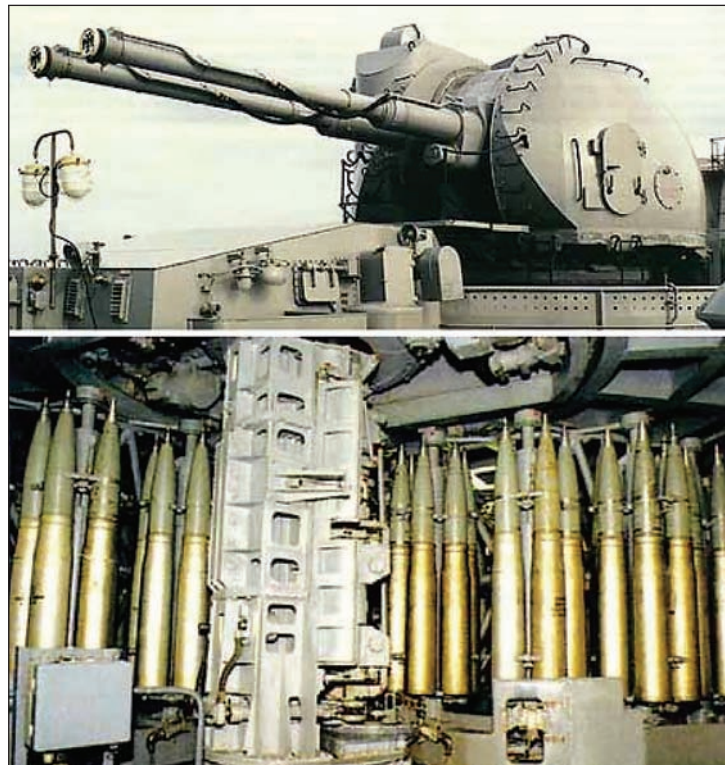
17. ábra. AK-130 hajólöveg, és lőszerei a töltőautomatában
