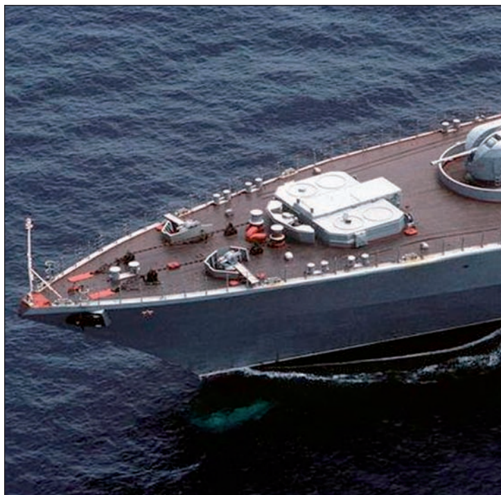
6. ábra. Az SA-N-9 (Gauntlet) rendszer indítósilói az UDALOJ orrában
