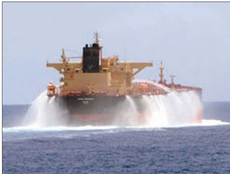
2. ábra. A hajók a képen látható vízfüggőnnyel igyekeznek megakadályozni, hogy a kaló zok a fedélzetre jussanak
