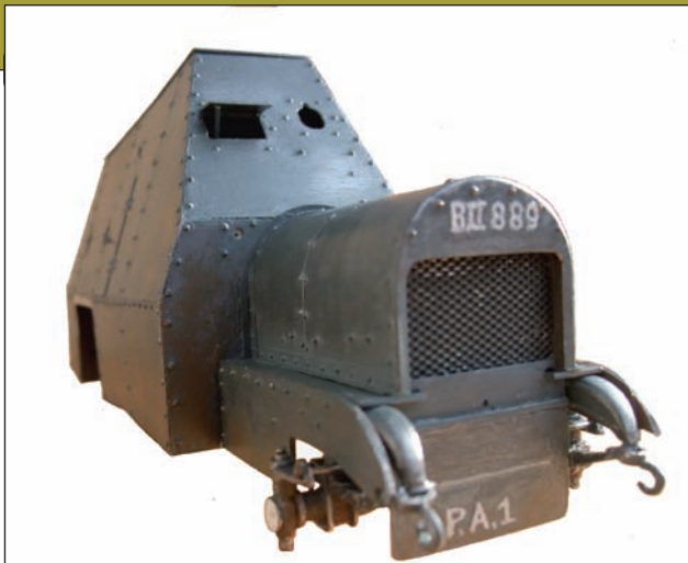
22. ábra. Az első futómű felfüggesztése
