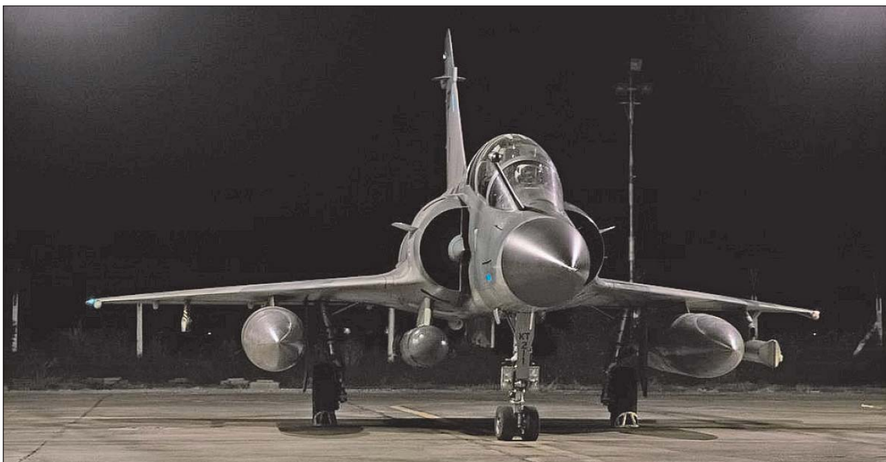
46. ábra. A brazil légierő Mirage 2000-es harci repülőgépe szárny alatti póttartályokkal
