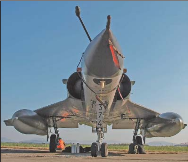
41. ábra. Mirage 2000N változat póttartályokkal. Franciaországban a Diversifire és Nucléaire csapásmérő változatokkal történt a legtöbb baleset, elsősorban a sok alacsony repülési profil miatt
