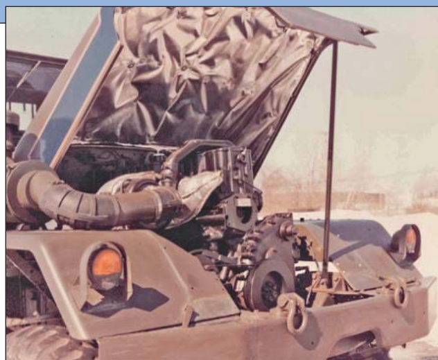
7. ábra. Az amerikai haderő Cummins adiabatikus dízelmotorral felszerelt kísérleti M-813-as katonai gépjárművén 310\text{ }^{\circ}\text{C} hőmérséklet elviselésére alkalmas olaj próbáit hajtják végre a 1990-es években
