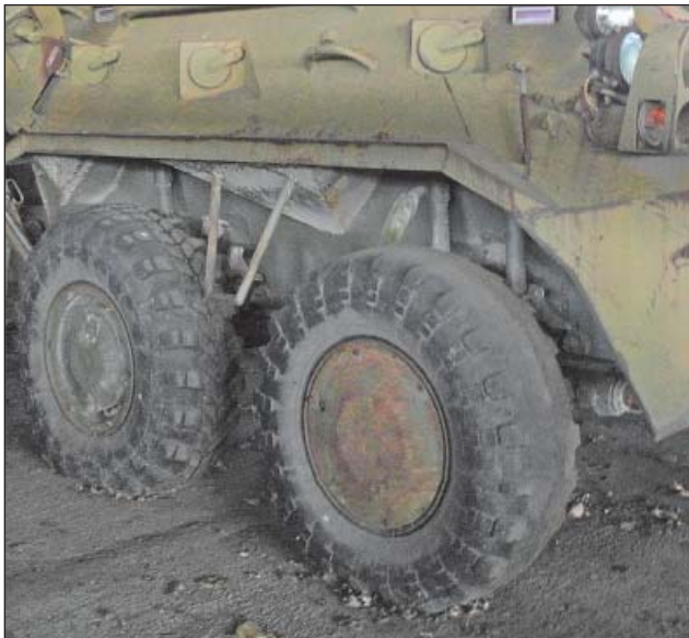
10. ábra. A BTR-80-as kopott mellső gumiabronccsal
