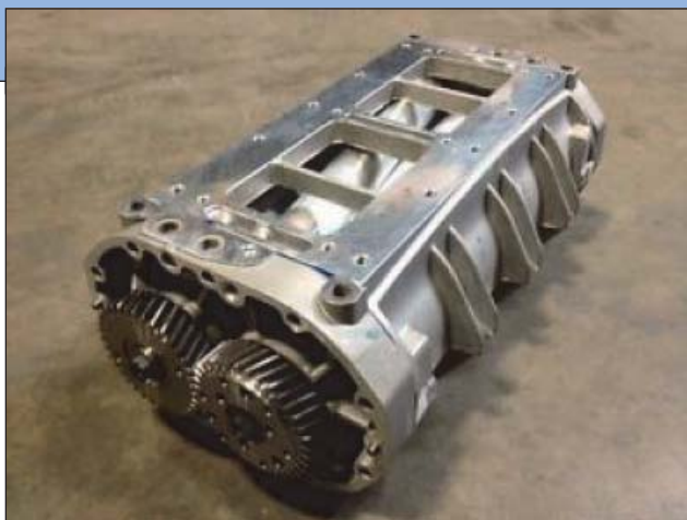
10. ábra. Az M-109-es önjáró löveg kétütemű dízelmotorjának mechanikus Roots-kompresszora, amelyet az újabb modelleken turbófeltöltővel is kiegészítenek
