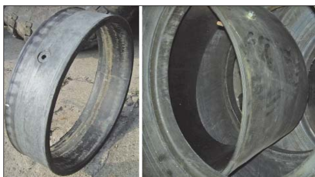
8. ábra. A BTR-80-as (bal) és a BTR-80A (jobb) gumiabroncsok távtartó gyűrűi
