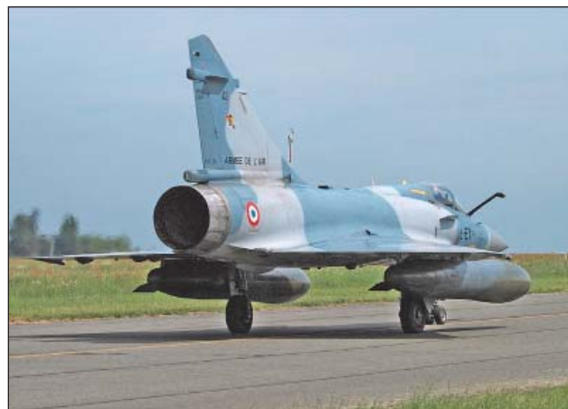
47. ábra. A francia légierő Cigognes ezredének Mirage 2005F vadászpilóta repülőgépe a 2011. évi Tigris találkozón, a Cambrai-Epinoy repülőbázison. A két póttartályon kívül mást nem hordoz, a többi pilonja leszerelve
