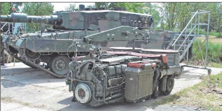
3. ábra. A német Leopard 2-es harckocsi MTU MB 873 Ka-501 típusú, folyadék-hűtéses V-12 biturbó dízelmotorja, amely 1,103 kW (1500 LE) teljesítményt ad le 2600 1/min fordulatszámra. A foto alapján jól érzékelhető a hagyományos szerkezetű harckocsimotorok fő problémája: a nagy beépítési méret és a jelentős tömeg
