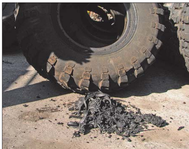
13. ábra. A KI-126-os gumiabroncsban felgyülemelő gumiórlemény
