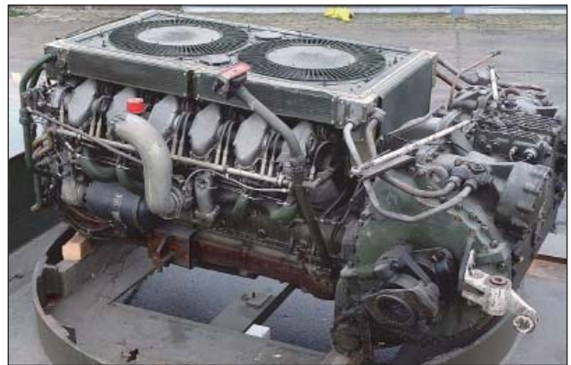
2. ábra. A Merkava és az M-60-as harckocsik 677 kW (910 LE) teljesítményű Teledyne Continental V-12 léghűtéses dízelmotorja kis tömegű, magas fokú harci túlélőképességgel rendelkező erőforrás volt
