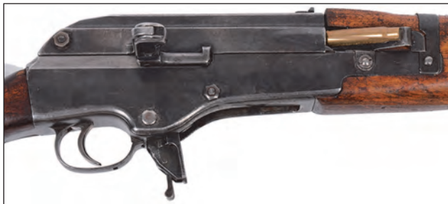
3. ábra. Öntöltő puska oldalt is zárt tokja és az üres hüvely eltávolításának módja
