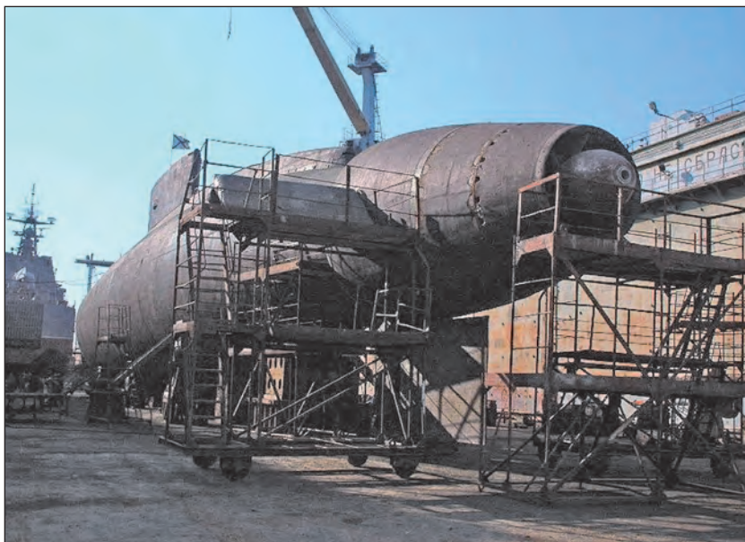
4. ábra. Szerelik a víz sugarhajtóművet. A kiemelkedően halk üzemű víz sugarhajtás zajszintje a korszerűnek tartott orosz vadásztengeralattjárók zajszintjének csak negyede
