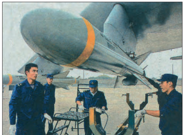
46. ábra. Az YJ-83-as függesztve a H6-K belső szárny alatti konzolon
