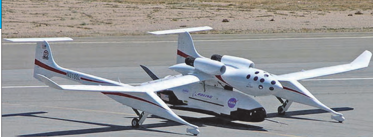
2. ábra. Az X-37-es robot-űrrepülőgép a Scaled Composite White Knight hordozó-repülőgépe hasa alá rögzítve, a légköri siklásos kísérletek kezdetén
