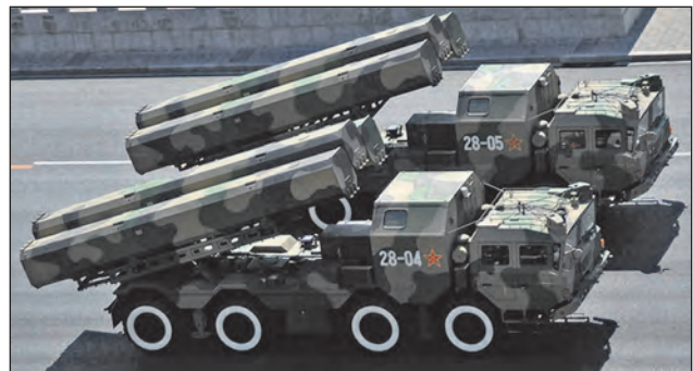
41/b. ábra. A szárazföldi indítású CJ-10-es GLCM robotrepülőgép, amely a Tomahawk kínai megfelelője
