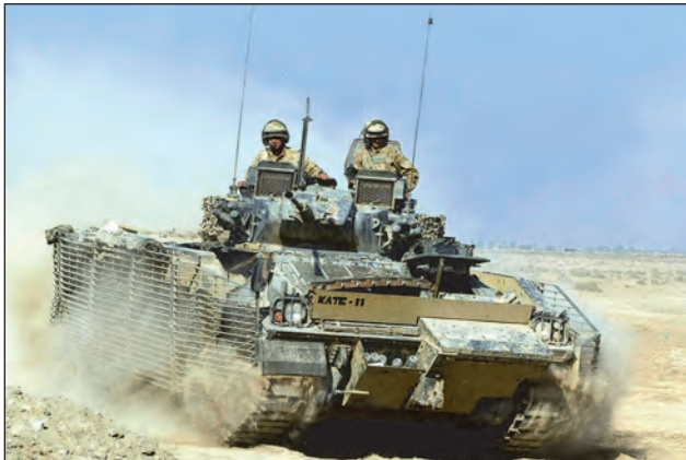
18. ábra. Warrior gyalogsági harcjármű 30 mm-es gépágyúval
