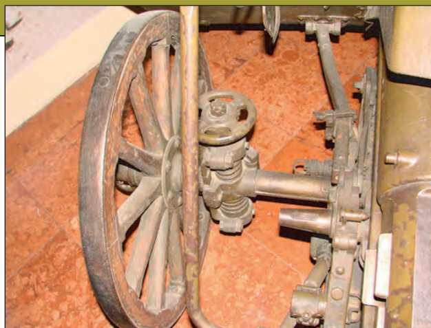
13. ábra. A huszáragyú rugózása lehetővé tette a fogatolt eszköz nagyobb sebességű vontatását (S.Gy.)
