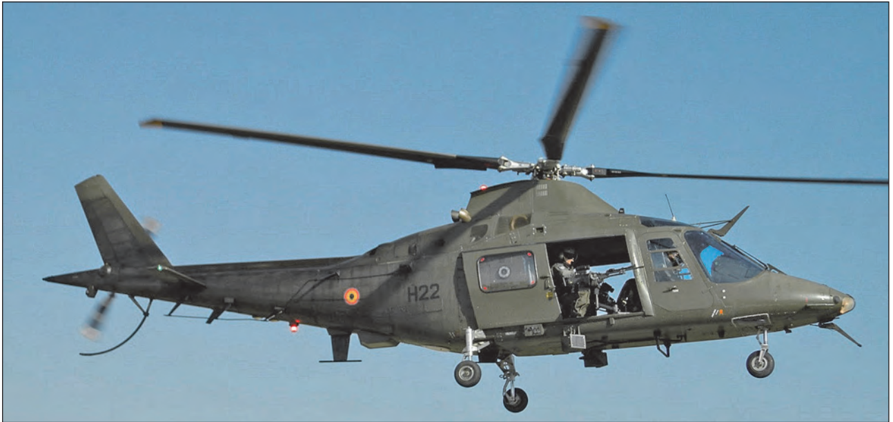
7. ábra. Az A-109-es Augusta könnyű helikoptereket FN Herstal MAG 58 típusú 7,62 mm-es géppuskákkal szerelték fel
