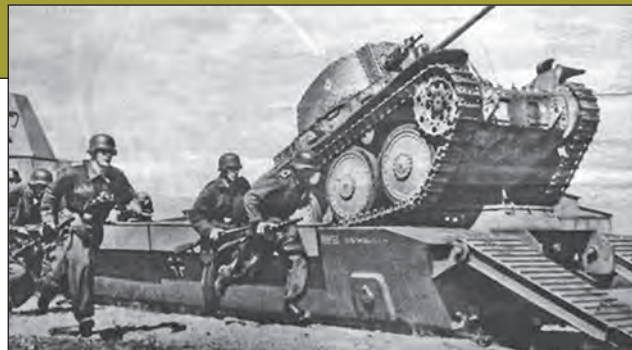
9. ábra. Egy BR 52-es mozdonyjal mozgatott páncélvonat tipikus bevetése a háború középső szakaszban. A támadó gyalogságot a páncélvonat pórkocsijáról legördülő Pz. 38 T (Škoda) könnyűharcokcsi támogatja
