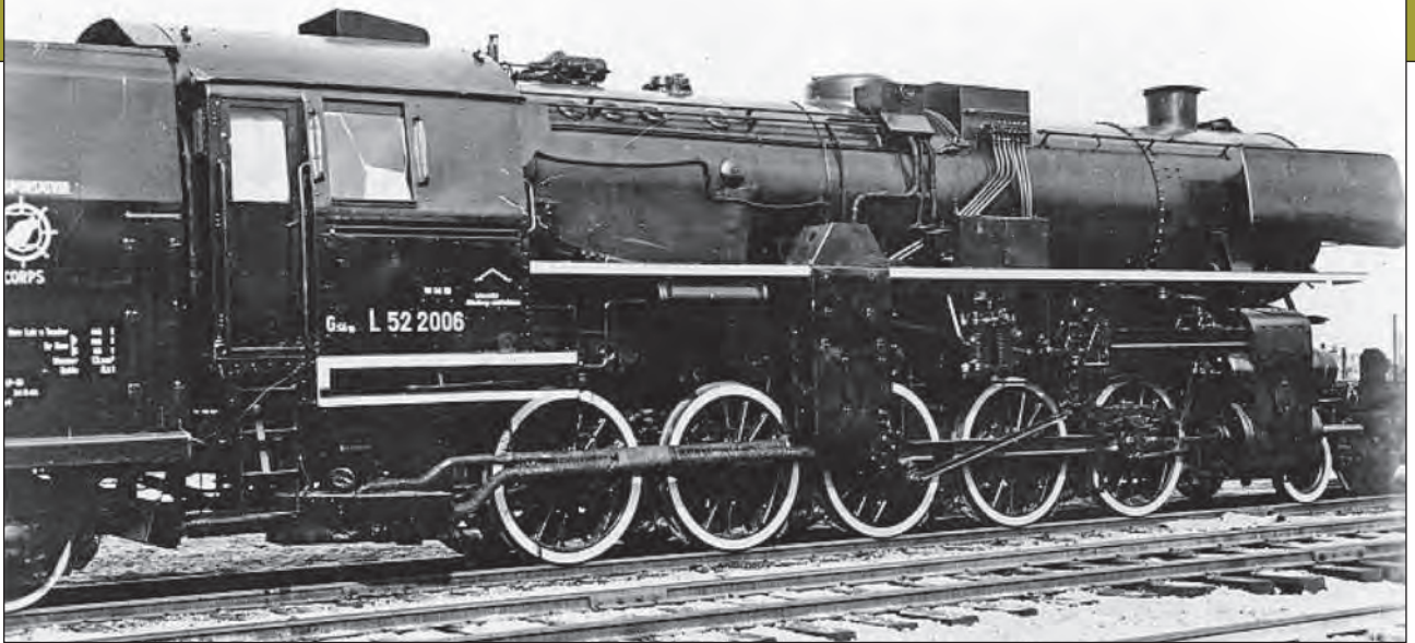
3. ábra. A 2006-os számú BR 52-es hadimozdony jobb oldali nézete 1952-ben, kondenzátoros szerkocsival
