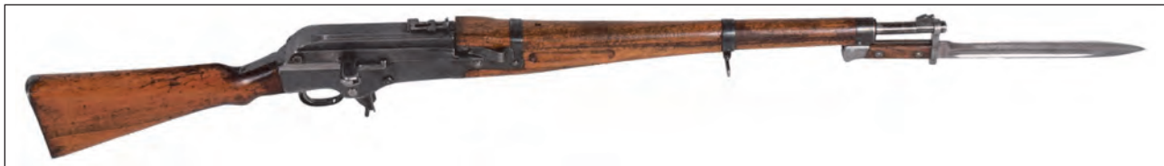
4. ábra. Öntöltő puska jobb oldali nézete (feltűzött szuronnal, tár nélkül) 35
