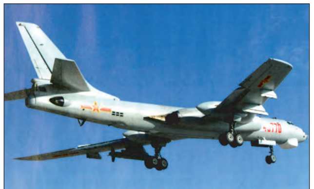
45. ábra. A H-6K bombázógép legújabb változata, valószínűleg YJ-83-as rakétával a szárnya alatt. Mivel 6 konzolja van, ez a H-6K-14-es nukleáris hordozóváltozat. Az orra alatt – lefedve – speciális navigációs-terepkövető rendszer antennái találhatók
