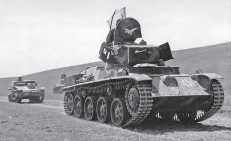
5. ábra. Az 1. lovas páncélos zászlóalj 38M Toldi harckocsija és a 35M FIAT Ansaldo kisharckocsi gyakorlat közben
