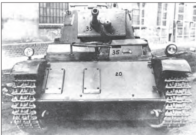
20. ábra. A 40 mm-es ágyúval szerelt 38M Toldi II. könnyű harckocsi prototípus a Haditechnikai Intézet udvarán
