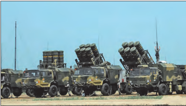
48. ábra. A HQ-16-os közepes hatótávolságú légvédelmi rakétarendszer 6 konténeres indítói. Három indítójármű egy üteg, a 4. jármű a lokátort hordozza, ezt egyéb járművek egészítik ki
