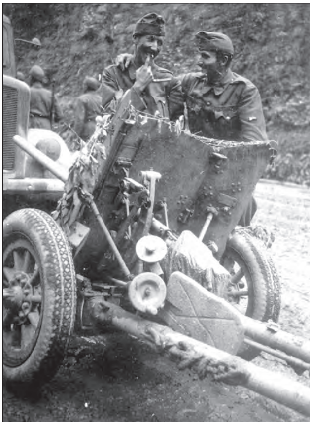
10. ábra. A gyorscsapatok gépvontatású 36M 37 mm-es páncéltörő ágyúkkal voltak felszerelve. 1941-ben már hatástalanok voltak a közepes harckocsik ellen
