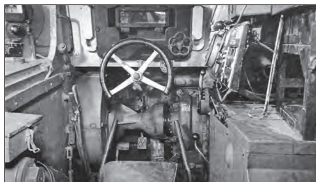
9. ábra. A harcjármű-vezető munkahelye a Tiger I. harckocsiban
