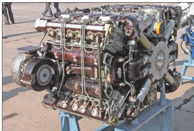
10. ábra. Az Armata 12 hengeres, turbófeltöltésű négyütemű harckocsi-dízelmotorja. A X henger-elrendezés kompakt kialakítást és rezgésmentességet biztosít a két turbófeltöltővel felszerelt dízelmotorok
