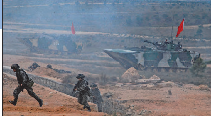
40. ábra. A ZBD-04-es típusú gyalogsági harcjárművek hadgyakorlaton. A felső láncágat fedő kötély fel van szerelve, eszerint a jármű vízi átkelésre is alkalmas
