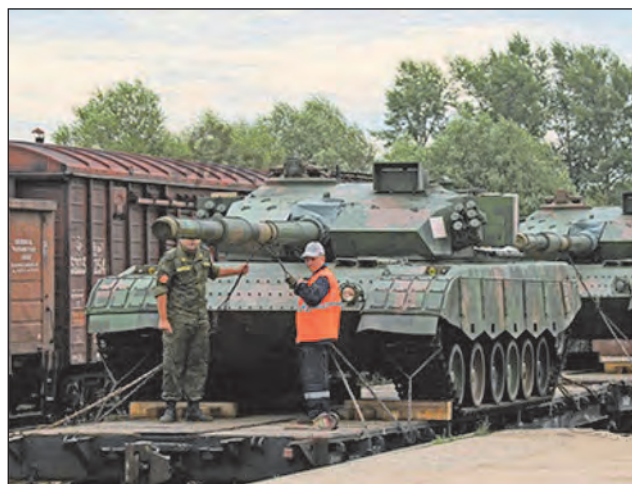
32. ábra. A Type 99A1-es harckocsi vasútra mállházása. A homlokpáncélon a kiegészítő téglapáncél el van távolítva
