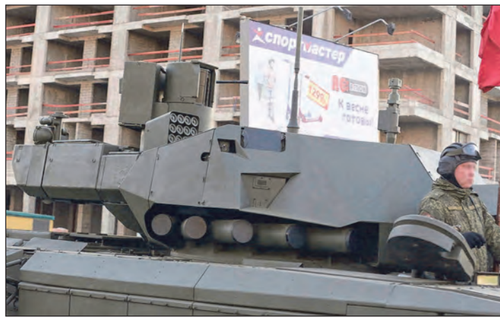
4. ábra. Az Armata harckocsi automata – személyzet nélküli – tornya közelről
