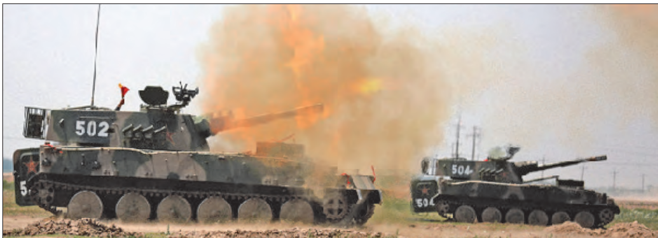
30. ábra. Norinco gyártású, Type 89-es (J2Z) típusú 122 mm-es önjáró tarackágyúk
