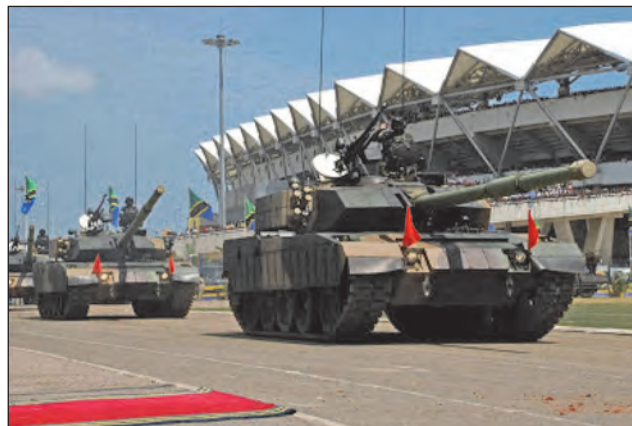
31. ábra. A Type 79-es típusú harckocsik 105 mm-es ágyúval, ez a Type 69-es alaptípus exportra gyártott változata
