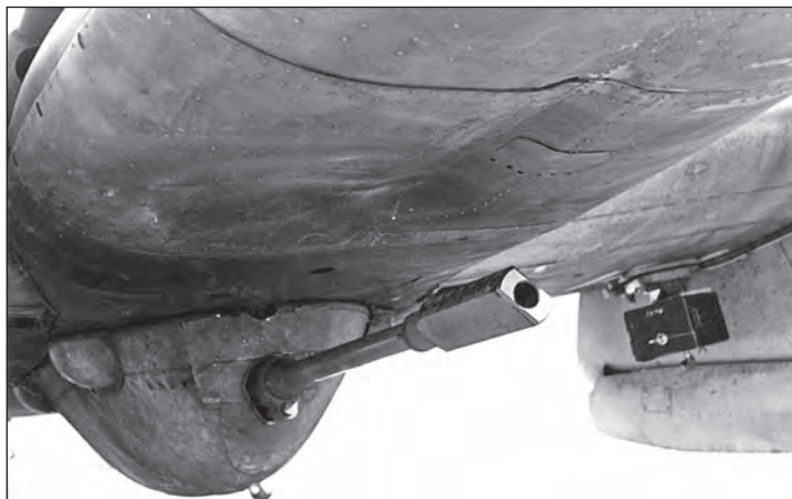
16. ábra. Közelkép a 30 mm-es Mk 103 ágyúval felszerelt Henschel romboló hasoldaláról
