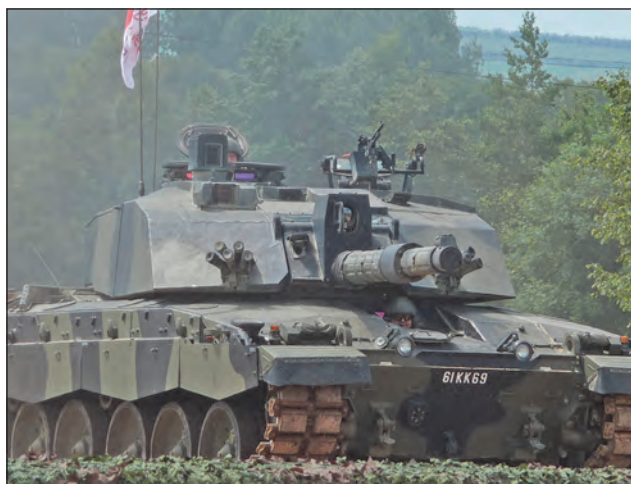
2. ábra. Brit Challenger-2-es harckocsi. A 62 tonnás járművet egy 1200 LE teljesítményű Perkins CV-12-es dízelmotor hajtja
