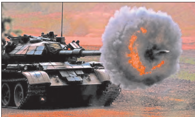
34. ábra. A Type 59-es harckocsi exportra gyártott, feljavított változata 105 mm-es ágyúval és utólag szerelt tégl-előtét-páncélzattal
