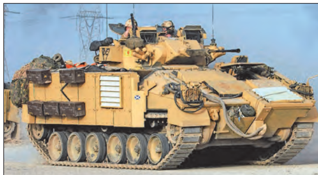
12. ábra. Brit Warrior páncélozott gyalogsági harcjármű Irakban. Fő fegyverzete a 30 mm-es gépágyú
