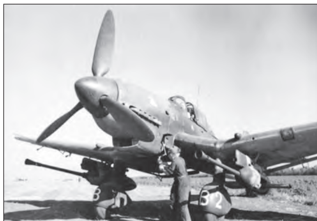
12. „Ágyús” Junkers Ju 87G kiépített 20 mm-es fegyverekkel, motorindítás közben
