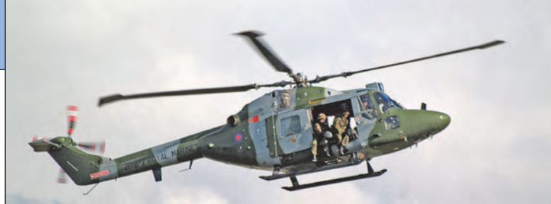
11. ábra. Brit Westland Lynx könnyűhelikopter Irakban. Két 1120 LE teljesítményű gázturbinával 8 fő, vagy 1500 kg teher szállítására képes
