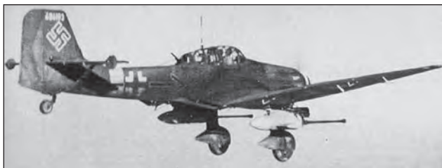
7. ábra. 37 mm-es gépágyúkkal felszerelt Ju 87G Stuka a levegőben
