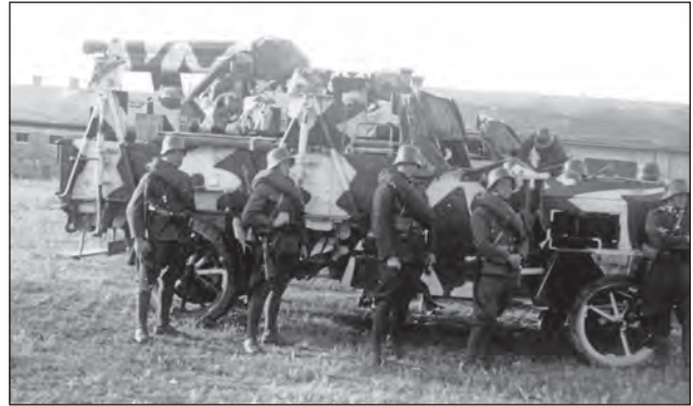
6. ábra. Rába V. R. tehergépkocsira épített 5/8M 8 cm-es légvédelmi ágyú, érdekes álcázó festéssel
