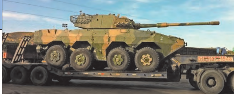
36. ábra. A ZBL-9-es 8x8 APC bázisán épült, Norinco gyártmányú, ZTL-09-es tűztámogató jármű 105 mm-es löveggel
