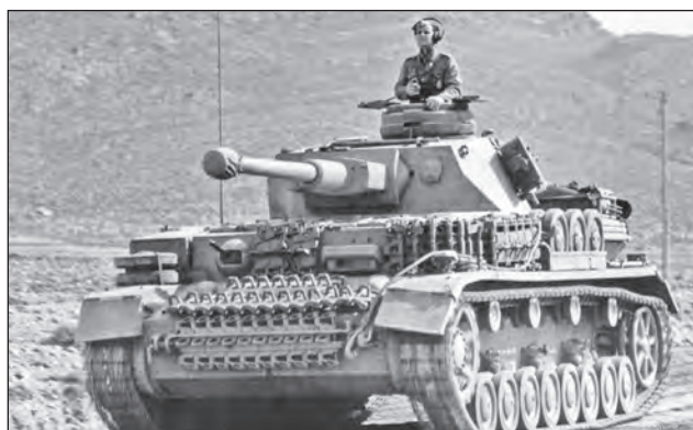
3. ábra. A Tunéziában bevetett 10. páncélos hadosztály 8. páncélosezredének Pz IV „G” harckocsija, menetben. Jól láthatók a páncélvédeltséget növelő lánc talpatagok
