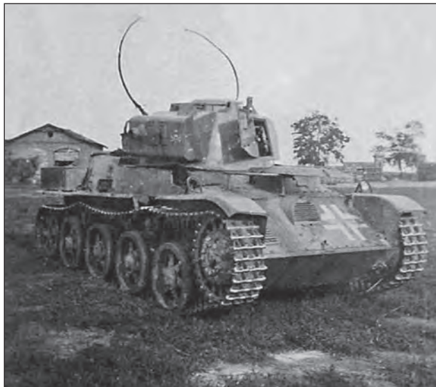
7. ábra. Toldi könnyűharckocsi keretantennával, a 20 mm-es fő fegyverzetet kiemelték a toronyból
