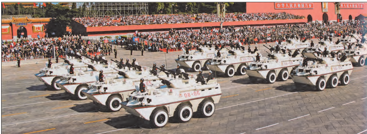
35. ábra. WZ 551-es őnjáró légvédelmi fegyver, úszóképes, 6 x 6-os alvázon 2 db gépágyú és 1 db nehézgéppuska a forgótoronyban van. A színe csak díszelgésre szolgál
