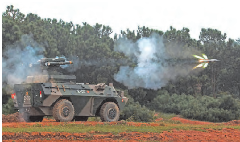
38. ábra. A HJ-9-es fegyverrendszerrel felszerelt WZ 551-es páncélvadász 4x4 úszóképes járművön. A négy indítóval ellátott fegyver rakétája Red Arrow 9-es (TOW másolat)
