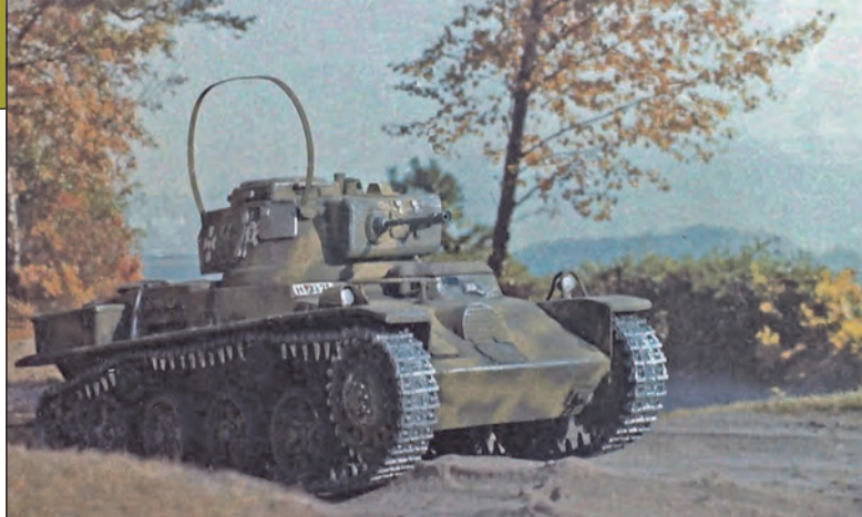
3. ábra. Toldi I. harckocsi makettje felemelt körantennával (S. L.)
