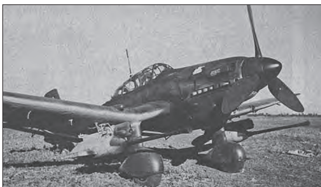
8. ábra. A G-Stuka. A leszerelt féklapok csomópontjai jól láthatóak
