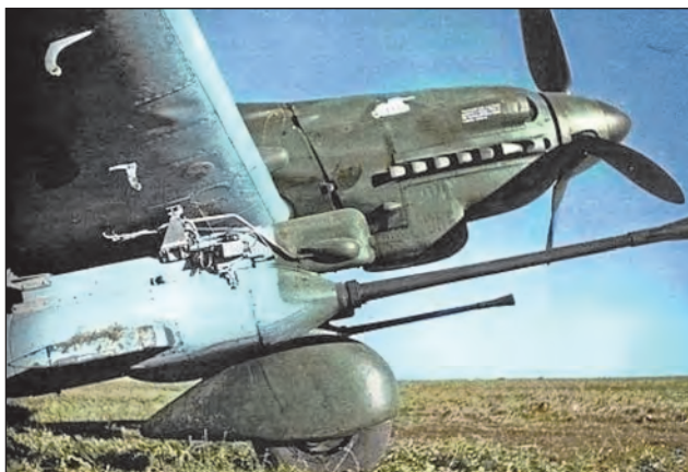
10. ábra. A G-Stuka 37 mm-es gépágyúja felülről (esetenként oldalról) a nehézpáncélosok páncélzatát is átütötte
