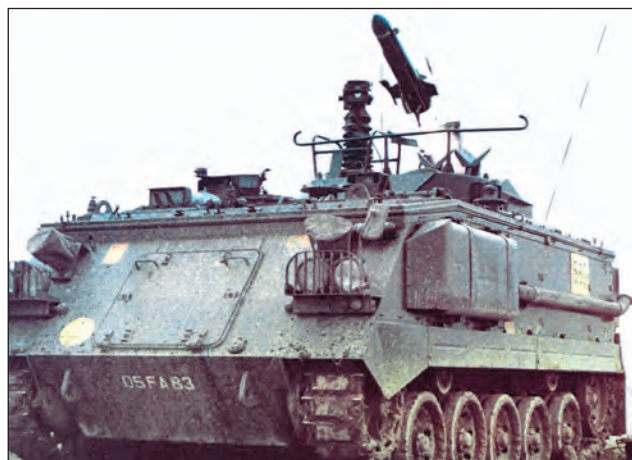
8. ábra. FV438-as páncéltörőrakéta-hordozó jármű FV 430 Mk. II. Bulldog bázisjárművön kialakítva. 12 db Swingfire rakétát hordoz, amelyek a jármű belsejéből újratölthető indítóállványról kerülnek harcba vetésre
