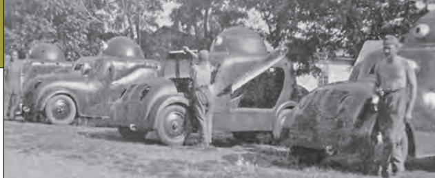
11. ábra. FIAT 2F – Prága II „Béka” páncélgépkocsi utánzatok (atrappok) az Uhry cég által készített lemez felépítménnyel, a Városligetben (Jávor László)
