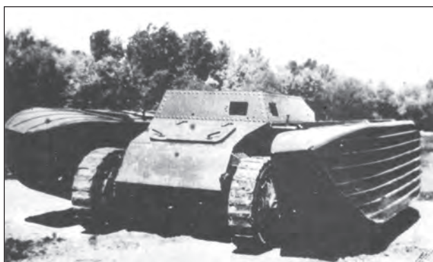
2. ábra. A magyar V-3-as harckocsi megépült torony nélküli változata, az oldalúszókkal
