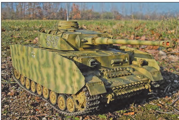
6. ábra. A Pz IV „H” közepes harckocsi. A kocsitestet és a tornyot is 8 mm lemezvastagságú kötény páncélzattal szerelték fel (Makett és fotó: Kovácsházy Miklós)
