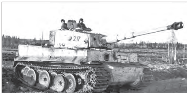
7. ábra. Az egyik magyar Tiger E nehézharckocsi. A harckocsi a harcok során elvesztette az egyik görgőjét a (jobb első, külsőt)
