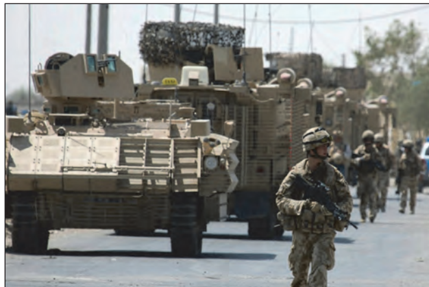
4. ábra. Brit páncélozott harcjármű-konvoj RPG védőráccsal felszerelt harcjárművekkel, Irakban
