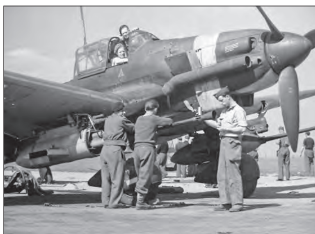
13. ábra. Angol katonák tanulmányoznak egy Salzburg közelében zsákmányolt Ju 87G páncélrombolót. A kipufogón lángrejtő burkolat van
