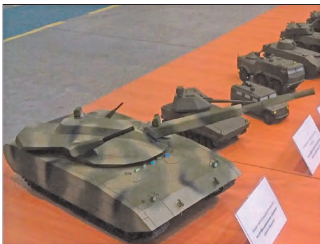
3. ábra. Az Objekt 195-ös (T-95-ös) koncepció-harckocsi makettje automata toronnyal, 152 mm-es löveggel és 30 mm-es gépágyúkkal. Megvalósítása túl drágának bizonyult
