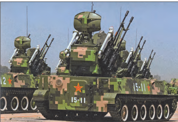
33. ábra. Őnjáró csapatlégvédelmi komplexum. Fegyverzet: 4 db lokátorvezérlésű 23 mm-es gépágyú, plusz 4 db alacsony hatómagasságú légvédelmi rakéta. Típusa nem ismert
