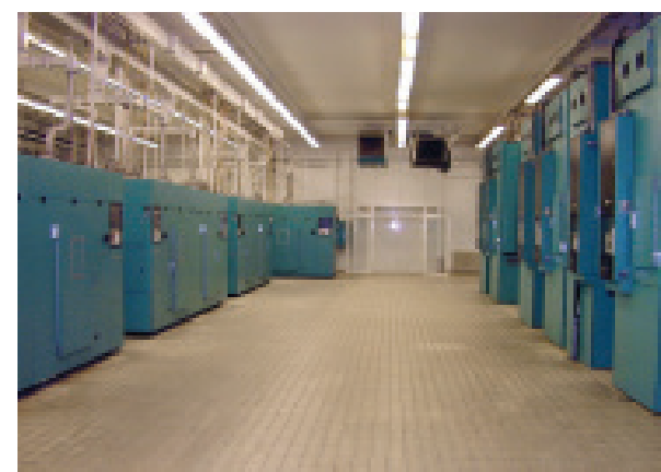
A fitotron növénynevelő egységeiben a külső környezeti feltételektől függetlenül végezhető a kísérletek FOTÓK | VÉCSY ATTILA
