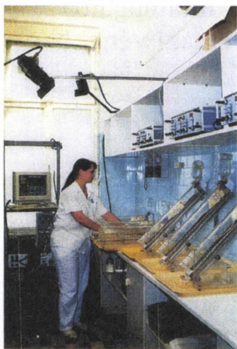
1. ábra: A tilt-laboratórium fényképe. A légkondicionált szoba fel van szerelve 6 cső alakú ketreccel, hemodinamikai mérőműszerekkel, valamint egy számítógéppel vezérelt infravörös mozgáskövető rendszerrel, amely képes éjjel-nappal folyamatosan regisztrálni és kvantálni a kísérleti állatok lokomotoros aktivitását (6, 21)
