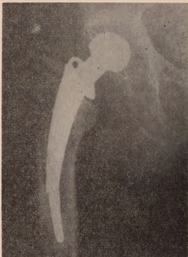
4. ábra: A protézis-szár fáradásos törése 10 évvel a műtét után.
