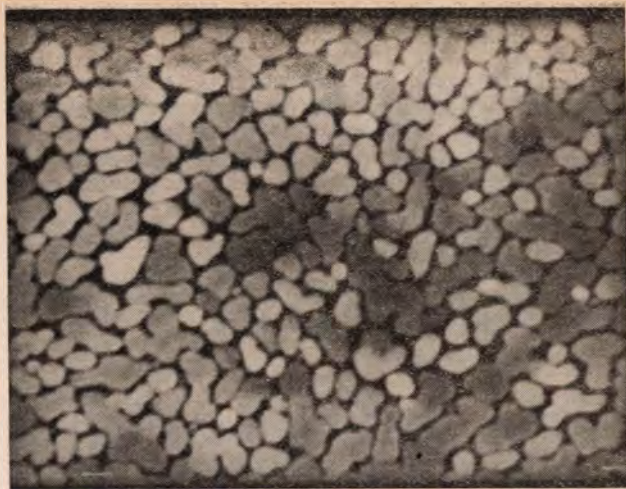
1. ábra: Mikroszkóp fedőlemezre vákuumpárolgatással felvitt indium vékonyréteg pásztázó elektronmikroszkópi képe. Jól látható, hogy a réteg nem összefüggő, hanem különálló szemcsékből tevődik össze. Alkalmazott nagyítás N = 10\,000
