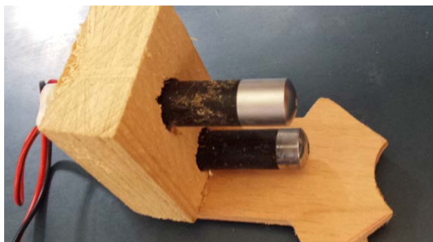
8. ábra. A tartóba szerelt lézerdiódák.
