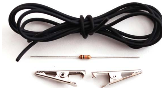
3. ábra. A vezető gumiszál a hozzá kapott 2 krokodilcsipesszel és az 1 k\Omega -os ellenállással.
