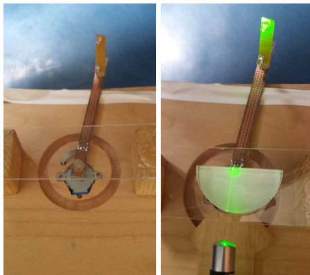
9. ábra. A kész mérőegység (balra) és a törésmutató-mérés (jobbra).
