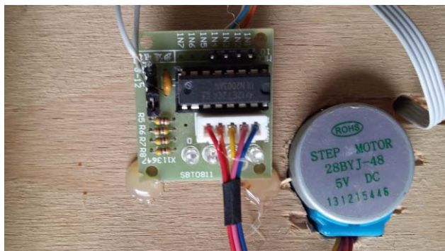
5. ábra. A szerelt léptetőmotor és vezérlő.
