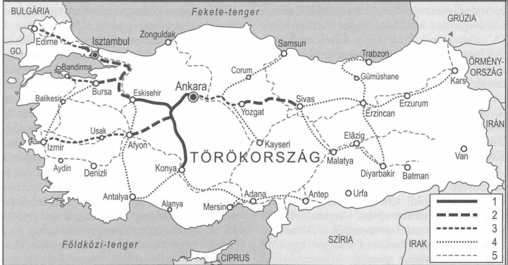
3. ábra: A törökországi nagysebességű hálózat Jelmagyarázat: 1 – 2012-ben üzemelő; 2 – épülőben lévő; 3 – középtávon megvalósuló; 4 – hosszú távon tervezett n.s. vonalak; 5 – üzemelő hagyományos vasutak. Forrás: „Törökország nagysebességű vasúti közlekedése” ... wikipedia [12] alapján a szerző szerkesztése.
