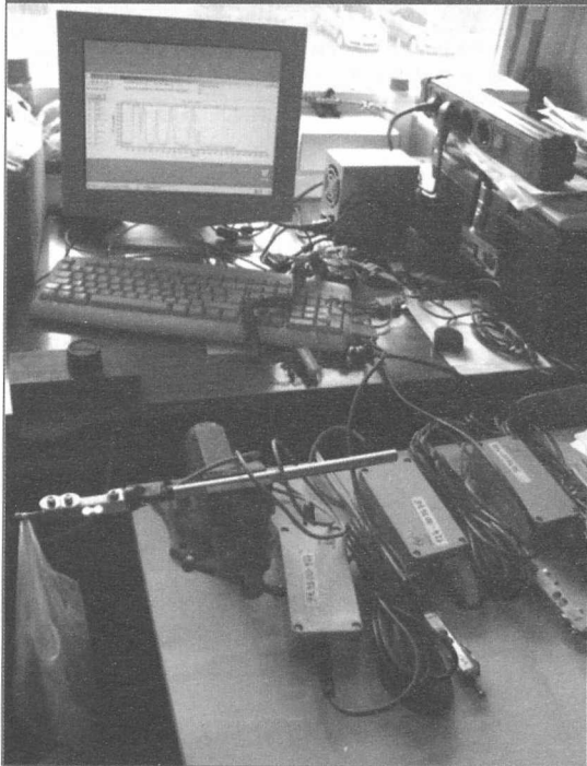
6. ábra: Kalibrációs összeállítás a hajómodell vontató csatorna mérőcelláival
