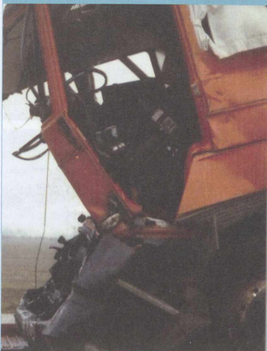
19. ábra: Ráfutás következménye előtté lassító nyerges szerelvény félpótkocsijára (dv = 40-45 km/h)
