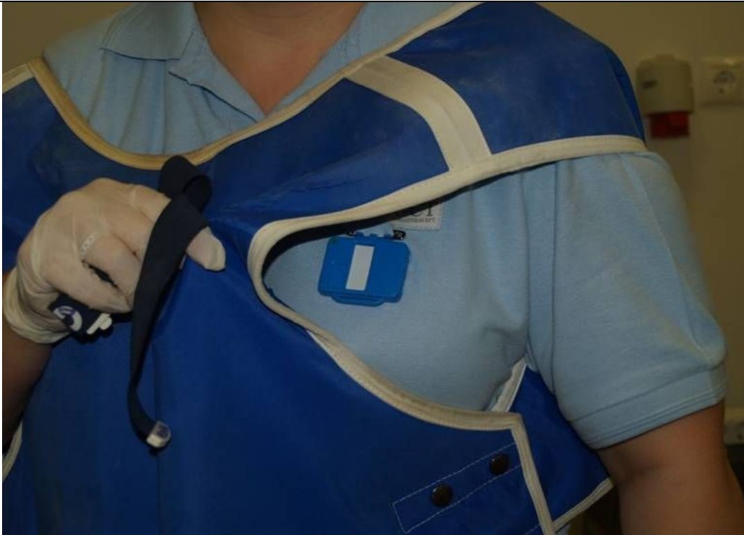
11. ábra: Ólomgumikötény és személyi doziméter Figure 11.: Rubber apron containing lead and personal dosimeter
