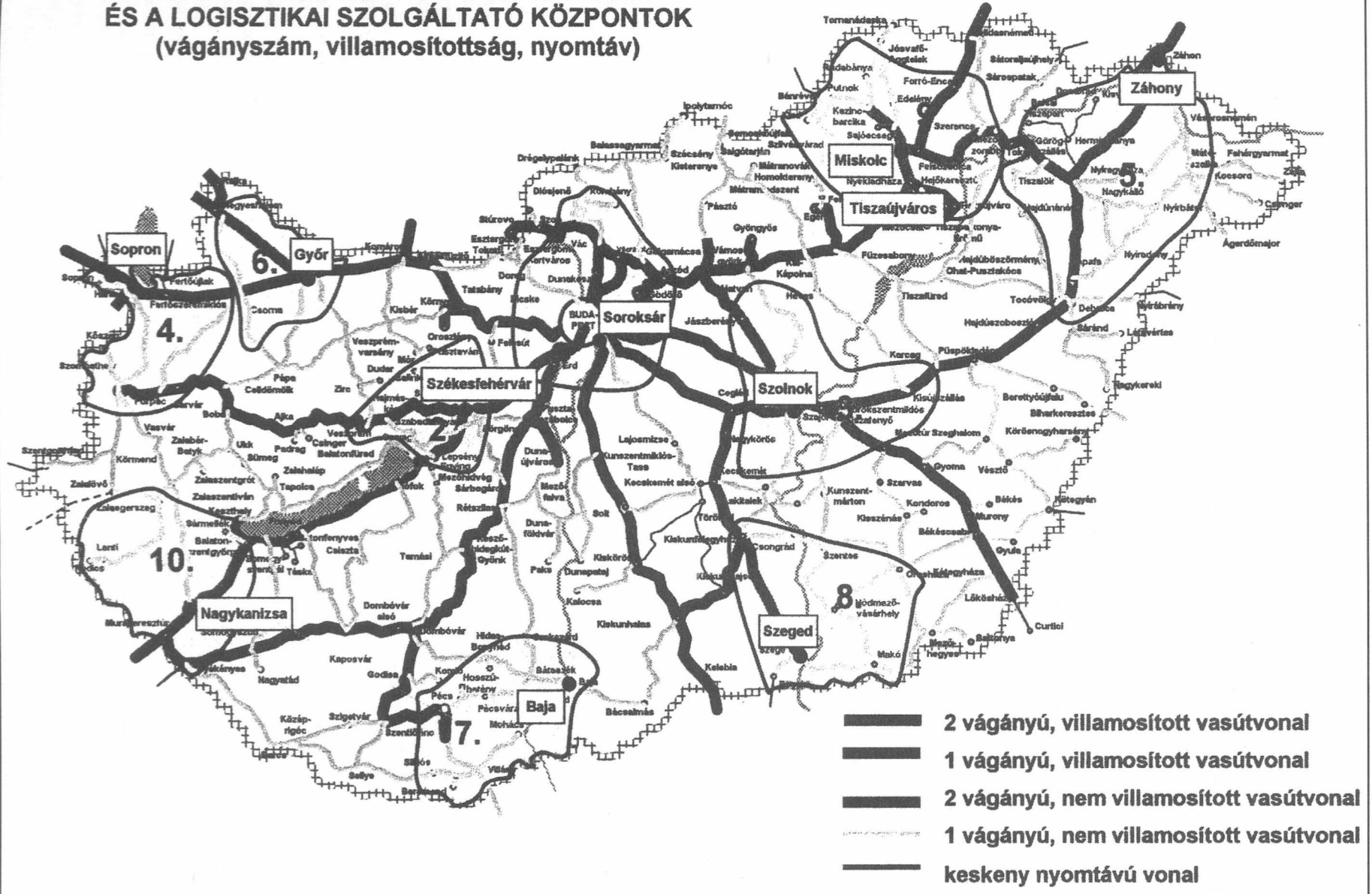
12. ábra A magyar vasúthálózat vonaljellemzői és a logisztikai szolgáltató központok (vágányszám, villamosítottág, nyomtávolság)
