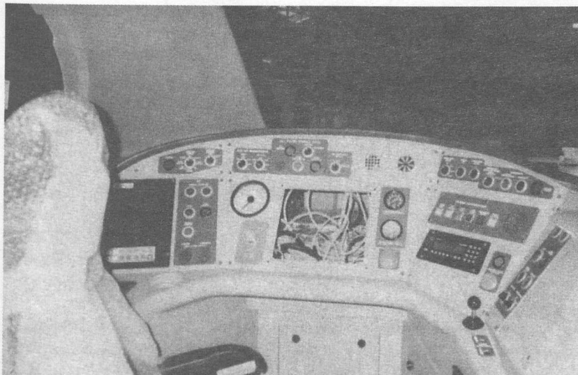
4. ábra A vezetőfülkéje a TBS vezérlő panellel
